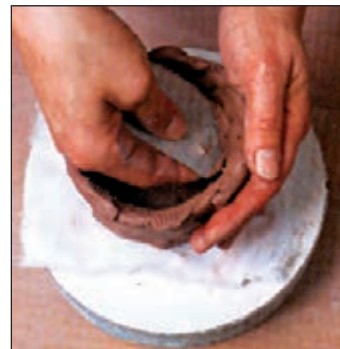
پرداخت کردن سطح داخلی ظرف سفالی.
