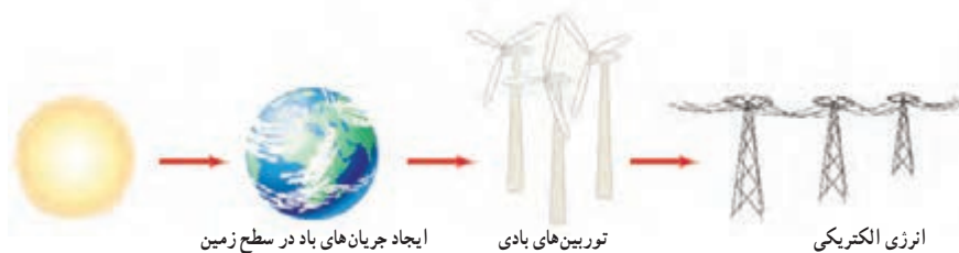
شکل ۶. تولید انرژی الکتریکی توسط توربین‌های بادی
