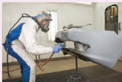
الف) تصویری از رنگ پاشی الکتروستاتیکی
