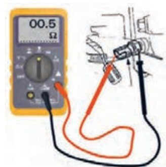
شکل ۴۹. کنترل فشنگی روغن
