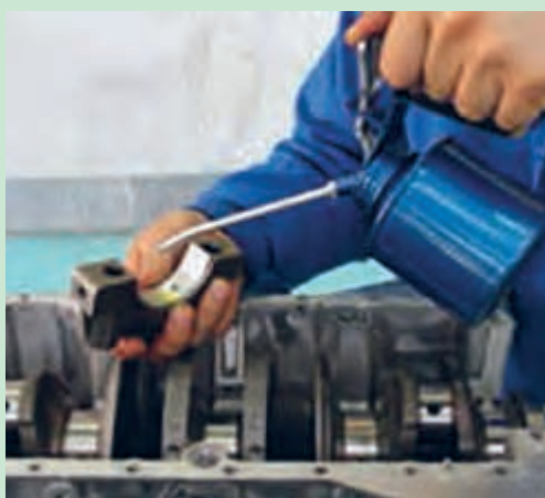
شکل ۹۵. روغنکاری یاتاقان ها قبل از نصب
