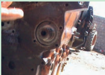
الف- محل پیچ های نگهدارنده میل سوپاپ
