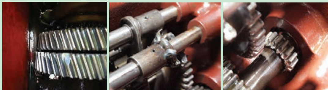
شکل ۴۰. برخی ایرادات قطعات جعبه دنده
