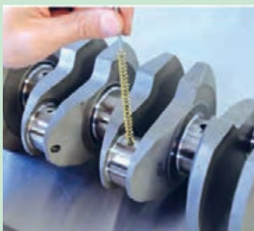
شکل ۶۰. تمیز کردن مجاری میل لنگ
