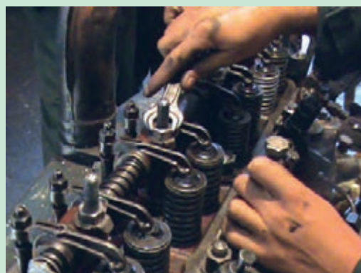
شکل ۴۵. باز کردن پیچ‌های پایه اسبک
