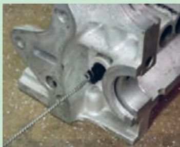
شکل ۵۹. تمیز کردن مجاری آب و روغن
