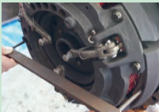
شکل ۳۸. تنظیم انگشتی‌های کلاچ
