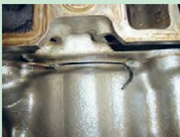
شکل ۶۲. ترک در سیلندر و بلوکه سیلندر
