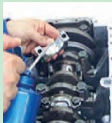
شکل ۱۰۱. روغن کاری کپه یاتاقان شاتون
