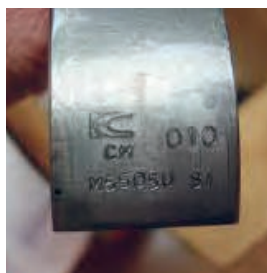
شکل ۲۳. تغییر ضخامت یاتاقان در سایزهای مختلف
