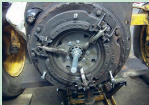
شکل ۳۷. سوار کردن مجموعه کلاچ روی فلاپیول
