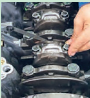
شکل ۱۰۲. کنترل لقی شاتون روی محور میل لنگ
