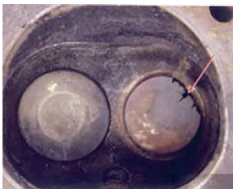
شکل ۷۰. عیوب ظاهری سوپاپ‌ها
