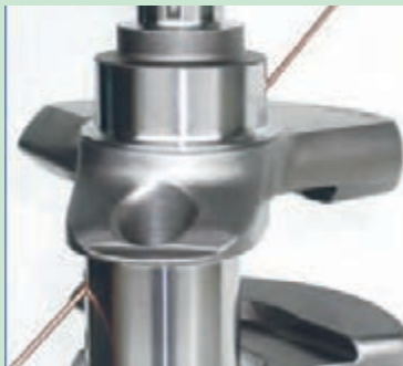
شکل ۶۰. تمیز کردن مجاری میل لنگ
