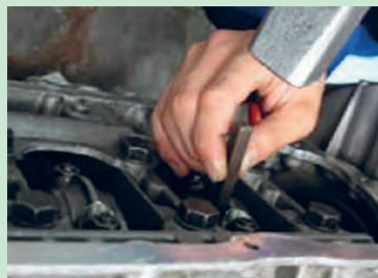
شکل ۴۱. علامت زدن کپه شاتون
