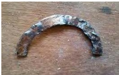
شکل ۷۳. نمونه بغل یاتاقانی معیوب
