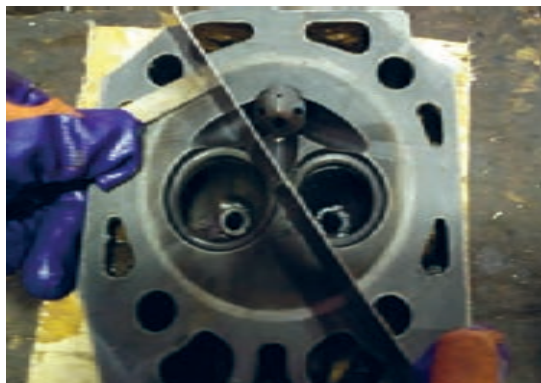
شکل ۶۵. کنترل تابیدگی سرسیلندر تراکتور دوچرخ
