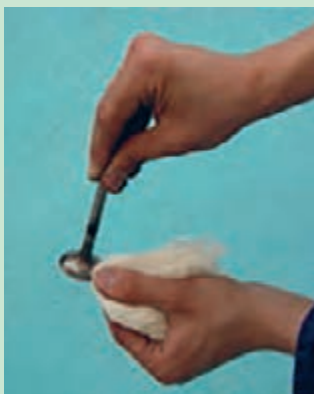
شکل ۸۰. تمیز کردن سوپاپ
