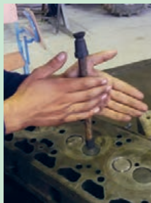
شکل ۷۹. چرخاندن سوپاپ به وسیله چوب سوپاپ گردان
