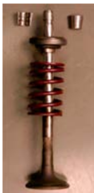
شکل ۱۷. فنر، کلاهک و خار سوپاپ
