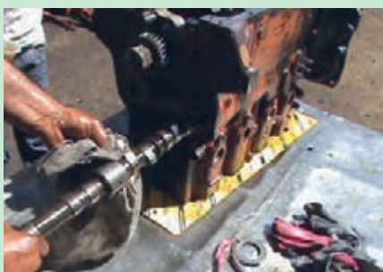
ب- خارج کردن میل سوپاپ
