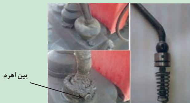
شکل ۲۹. خارج کردن اهرم‌های تعویض دنده
