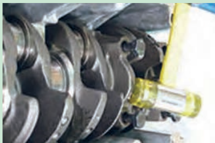
شکل ۴۷. شل کردن کپه‌های یاتاقان
