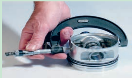
شکل ۷۵. اندازه‌گیری قطر پیستون با میکرو متر
