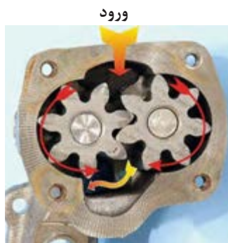
شکل ۴۲. پمپ روغن دنده ای
