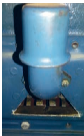
۴۰. تهویه محفظه کارتر در تراکتور U650
