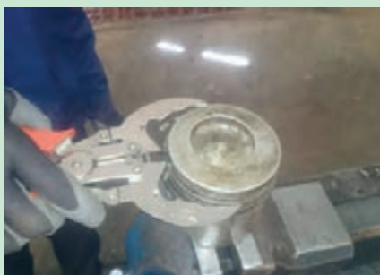
شکل ۵۲. نحوه خارج کردن رینگ از روی پیستون
