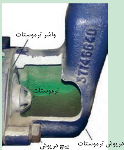
شکل ۱۷. نمای برش خورده ترموستات تراکتور MF۲۸۵
