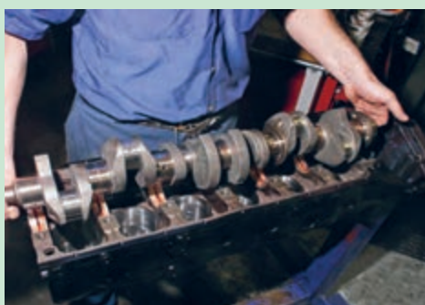
شکل ۴۹. برداشتن میل لنگ
