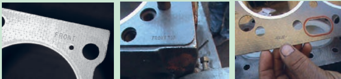
شکل ۸۶. علامت های روی واشر سرسیلندر
