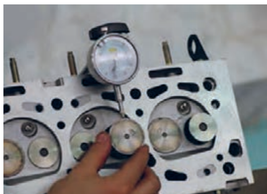
شکل ۷۳. روش کنترل لقی بین سوپاپ و گیت
