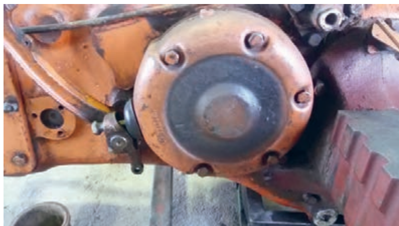
شکل ۴. موقعیت ترمز تراکتور U650
