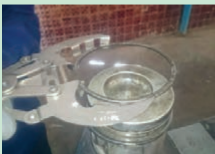
شکل ۵۲. نحوه خارج کردن رینگ از روی پیستون
