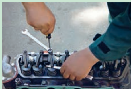
شکل ۳۶. فیلرگیری
