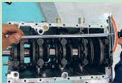
شکل ۴۶. باز کردن پیچ‌های یاتاقان
