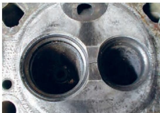
شکل ۶۶. ترک خوردگی سرسیلندر در محفظه احتراق
