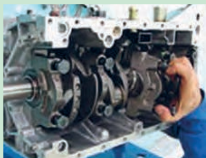
شکل ۴۸. برداشتن کپه‌های یاتاقان و چیدن آنها
