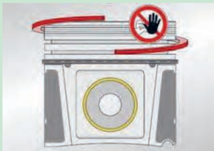
شکل ۵۳. خارج کردن رینگ بدون رینگ بازکن
