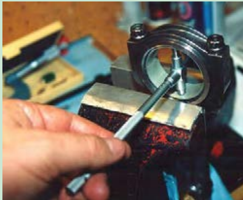
شکل ۸۳. کنترل بیضی شدن سر بزرگ شاتون
