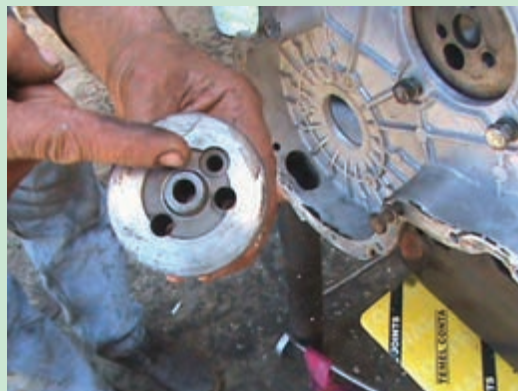
شکل ۱۰۸. واسط سر میل سوپاپ
