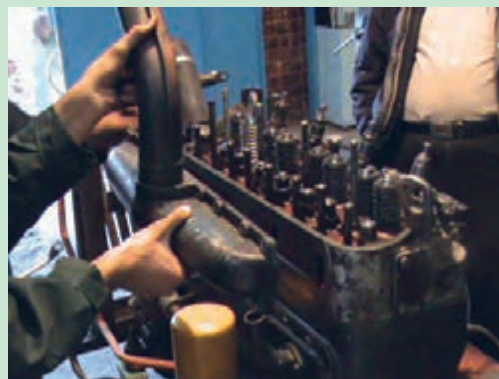
شکل ۴۳. باز کردن مانیفولد تراکتور U650
