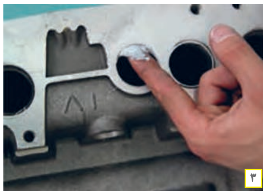
شکل ۶۹. روش تعویض پولک سر سیلندر
