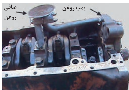
شکل ۴۱. پمپ روغن موتور و صافی آن
