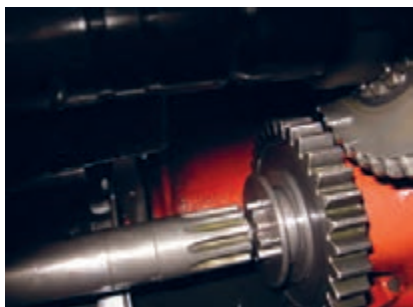
شکل ۲۰. محور تواندهی در حالت خلاص
