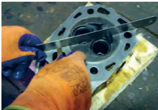
شکل ۶۵. کنترل تابیدگی سرسیلندر تراکتور دوچرخ
