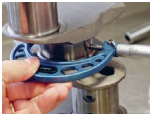
شکل ۷۱. اندازه گیری قطر میل لنگ
