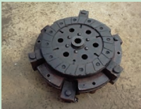
شکل ۲۵. جدا کردن مجموعه کلاچ از فلاپیول
