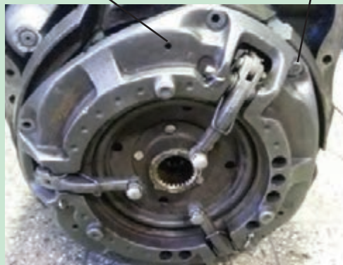
شکل ۲۵. جدا کردن مجموعه کلاچ از فلاپیول
