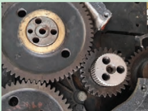
شکل ۱۰۹. علامت‌های تایمینگ روی چرخ دنده‌ها
