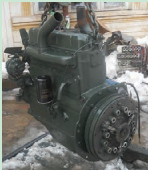
شکل ۲۴. پیاده کردن موتور تراکتور U650
