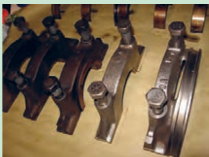
شکل ۴۸. برداشتن کپه‌های یاتاقان و چیدن آنها
