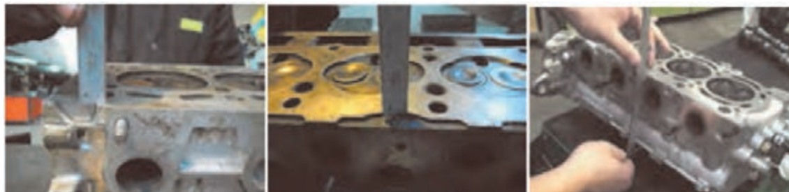
شکل ۸۳. کنترل ارتفاع مجاز کف تراشی سرسیلندر
