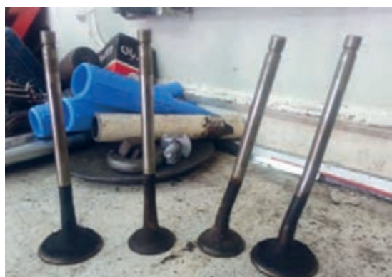
شکل ۶۷. کربن گرفتگی سرسیلندر و سوپاپ‌ها
