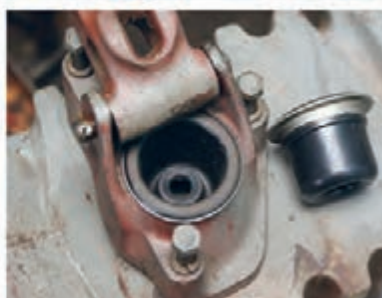
شکل ۶. مکانیزم کارانداز ترمز تراکتور MF۲۸۵
