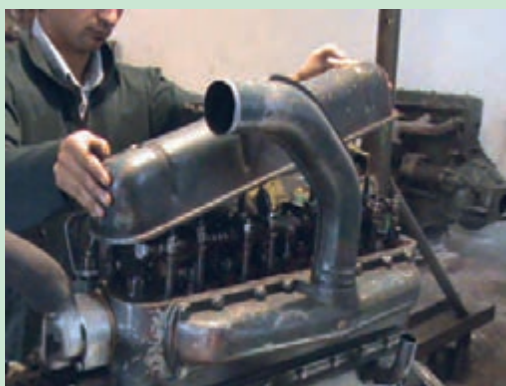
شکل ۴۴. برداشتن درپوش سوپاپ‌های تراکتور U650
