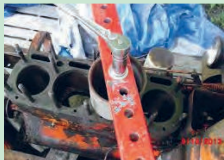
شکل ۹۰. جا زدن بوش با ابزار
