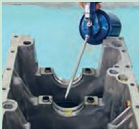
شکل ۹۵. روغنکاری یاتاقان ها قبل از نصب
