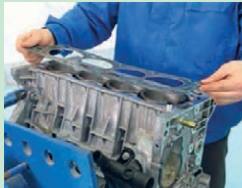
شکل ۵۰. برداشتن و اثر سر سیلندر
