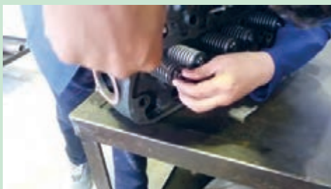
شکل ۵۷. خارج کردن لاستیک آببندی سوپاپ
