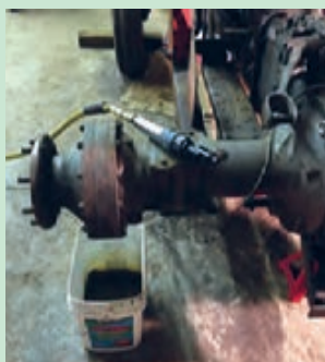
شکل ۳۲. کاهنده نهایی بعد از باز کردن چرخ
