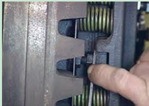
شکل ۳۹. تنظیم کلاچ محور تواندهی
