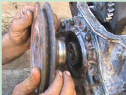
شکل ۳۵. پیاده کردن پولی میل لنگ
