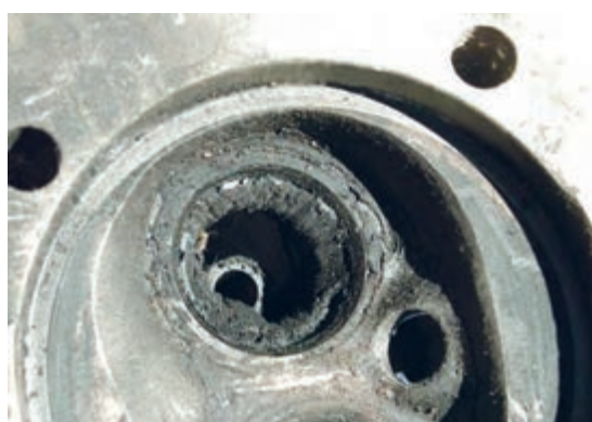
شکل ۶۷. کربن گرفتگی سرسیلندر و سوپاپ‌ها
