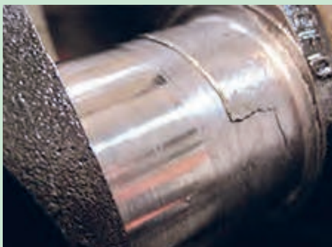
شکل ۶۵. میل لنگ شکسته
