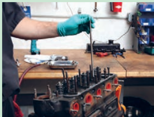
شکل ۴۷. خارج کردن میل تپت‌ها
