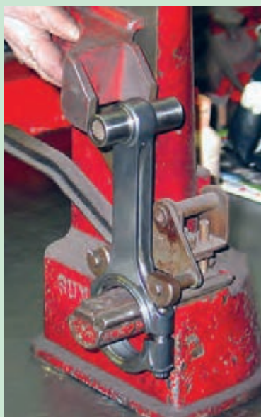
شکل ۸۲. پیچیدگی شاتون، اندازه گیری و اصلاح آن
