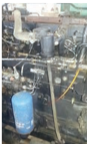
شکل ۳۹. تهویه محفظه کارتر در تراکتور MF399
