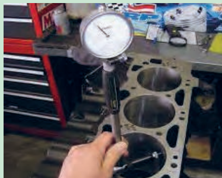
شکل ۷۶. اندازه‌گیری قطر سیلندر با میکرومتر داخلی
