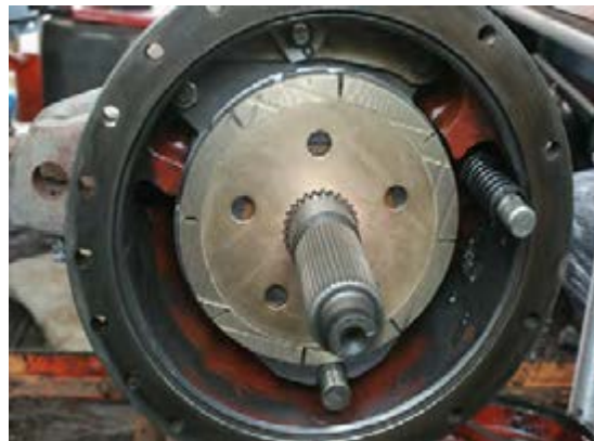
شکل ۳. پین‌های نگهدارنده مکانیسم ترمز
