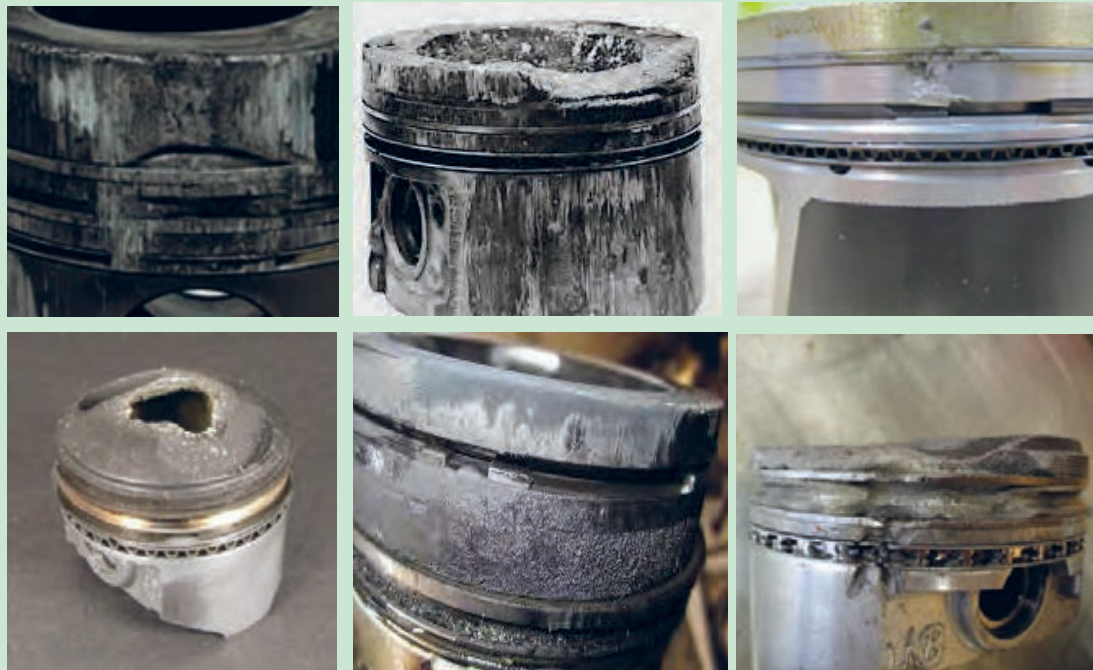
شکل ۷۴. نمونه ای از پیستون های معیوب
