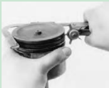
شکل ۵۸. روش های تمیز کردن شیار رینگ پیستون
