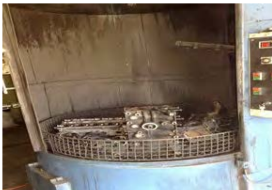
شکل ۶۱. شستشوی موتور به وسیله دستگاه شات بلاست
