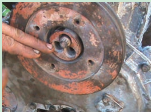
شکل ۱۱۳. پیچ‌های پولی سر میل لنگ
