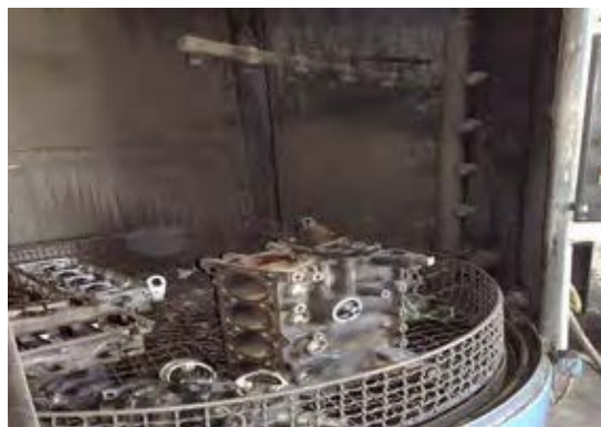
شکل ۶۱. شستشوی موتور به وسیله دستگاه شات بلاست
