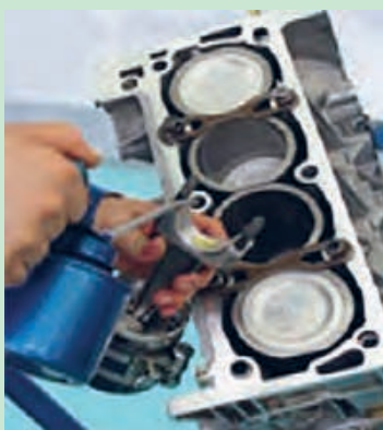
شکل ۱۰۱. روغن کاری کپه یاتاقان شاتون
