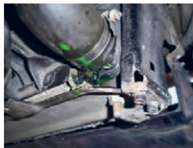
شکل ۵. نشتی از محل اتصالات
