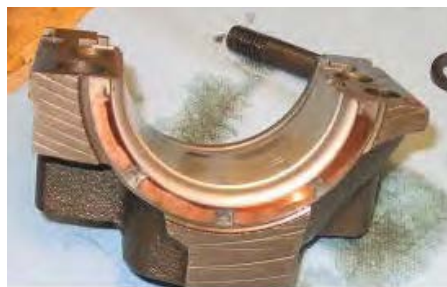
شکل ۷۳. نمونه بغل یاتاقانی معیوب
