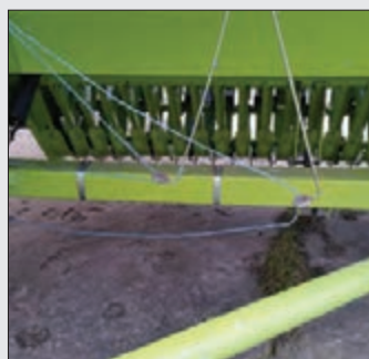
شکل ۹۱- مسیر نخ کردن بسته‌بند و جایگاه سوزن
