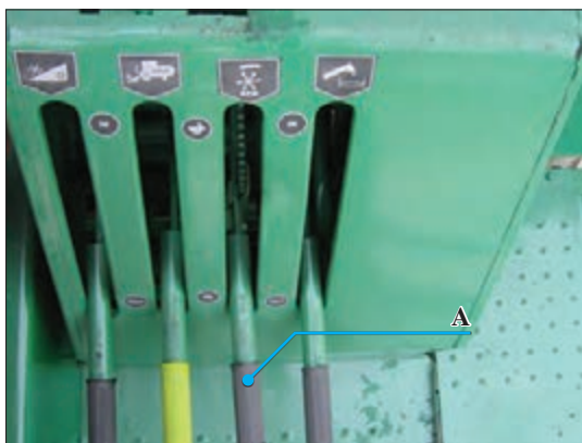
شکل ۳۹- اهرم تنظیم سرعت پروانه چرخ و فلک
