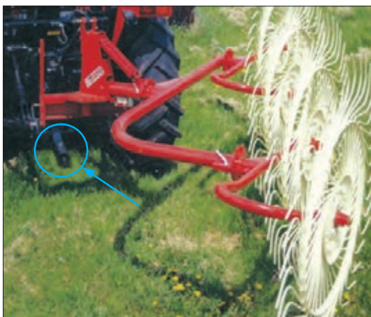
شکل ۵۹- اتصال شانه خورشیدی به تراکتور
