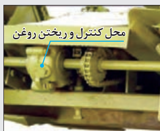
شکل ۴۷- جعبه دنده دوکفه‌ای
