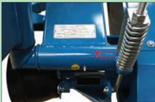
شکل ۲۱- شاخص تنظیم کشش تسمه دروگر استوانه ای
