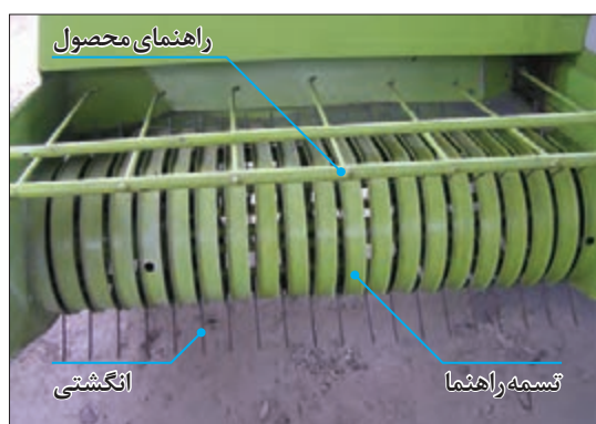
شکل ۷۲- اجزای واحد بردارنده بسته‌بند
