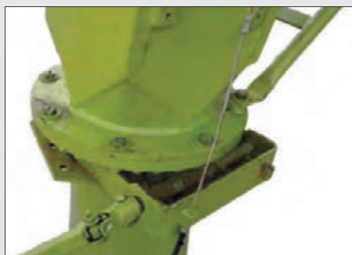
شکل ۴۰- چرخ دنده دوران لوله
