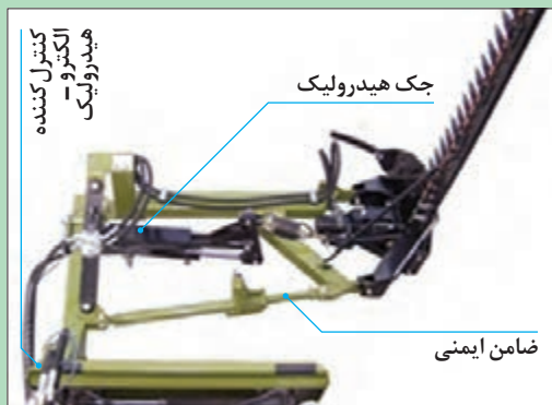
شکل ۱۷- دروگر شانه‌ای با سیستم محرک ارتعاشی
