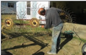
شکل ۵۷- بررسی انگشتی‌ها
