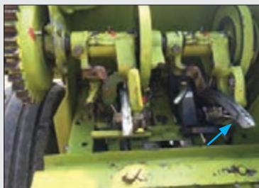
شکل ۹۳- تحویل نخ به نخ گیر
