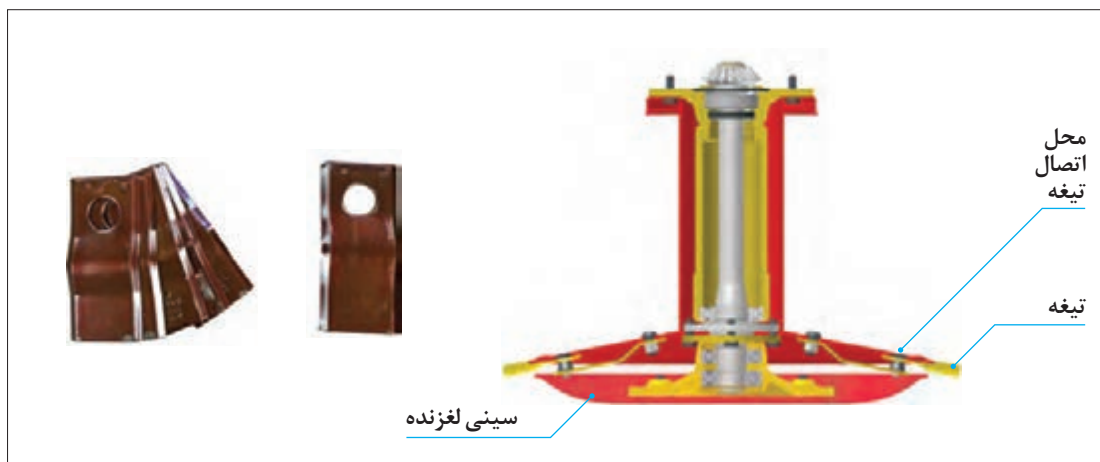
شکل ۴- تیغه و محل قرارگیری آن روی استوانه
