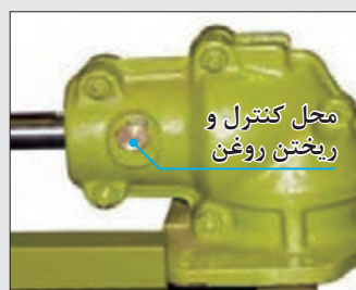
شکل ۴۶- جعبه دنده زانویی تیغه درو
