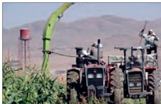
شکل ۳۲- تناسب لوله تخلیه با ماشین حمل
