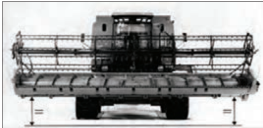
شکل ۳۷- اندازه‌گیری تراز بودن پلاتفرم
