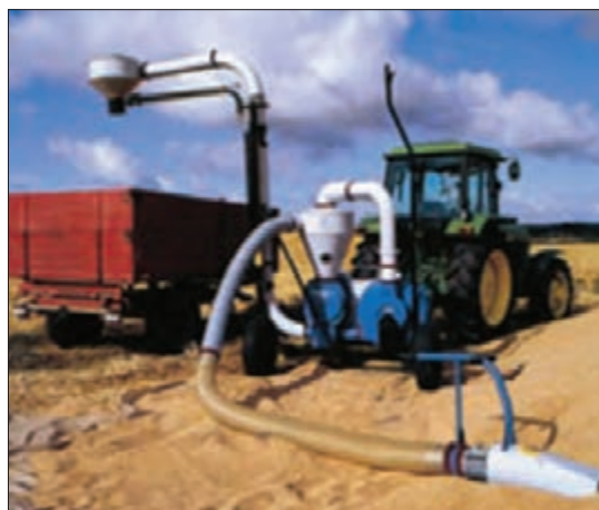
شکل ۲۹- نقاله بادی و طرز کار آن
