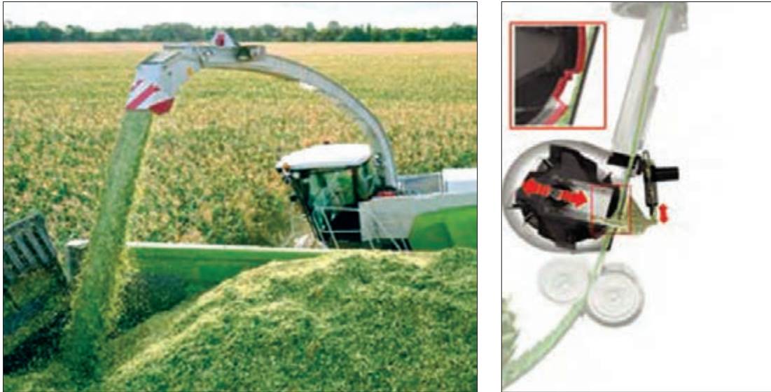
شکل ۳۸- تنظیم شتاب‌دهنده
