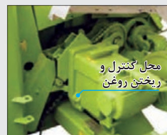
شکل ۴۵- جعبه دنده باردهی غلتک‌های تغذیه
