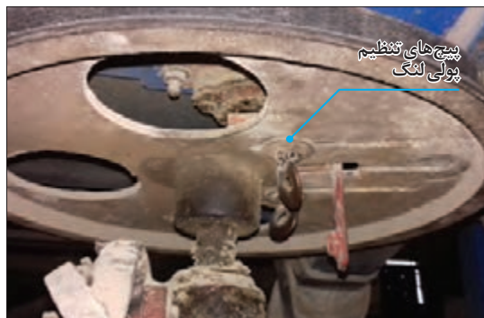
شکل ۳۴- پیچ تنظیم کورس غربال کابلی
