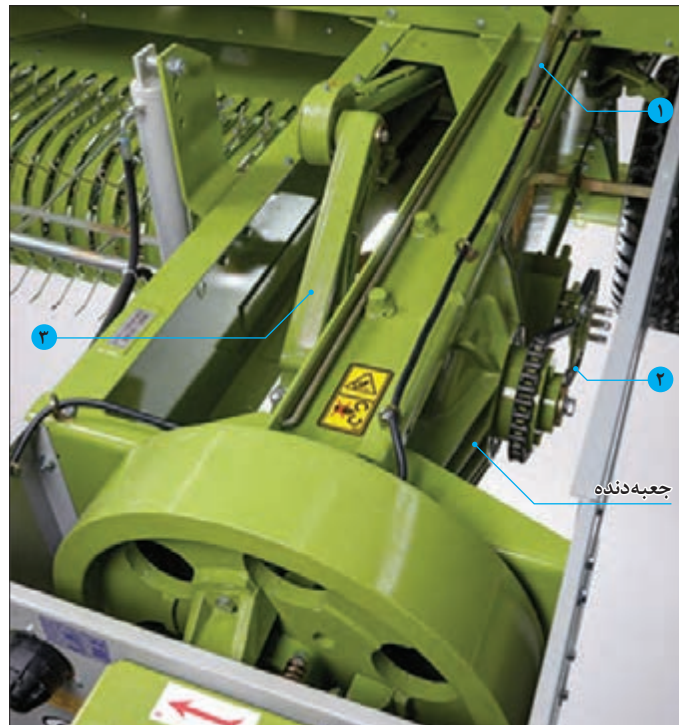
شکل ۸۲- مسیر انتقال توان در بسته‌بند
