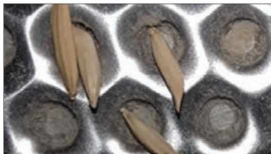
شکل ۱۶- قرار گرفتن دانه‌ها در سوراخ‌های استوانه حفره‌دار
