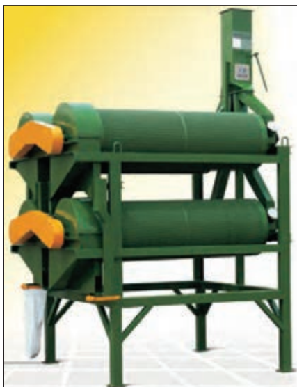
شکل ۱۳- ماشین بوجاری استوانه حفره‌دار
