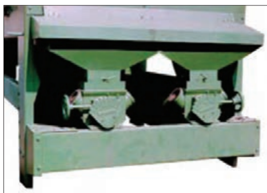
شکل ۳۶- تنظیم کننده‌های استوانه حفره‌دار
