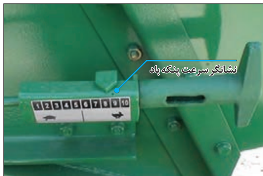
شکل ۴۴- اهرم تنظیم سرعت پنکه
