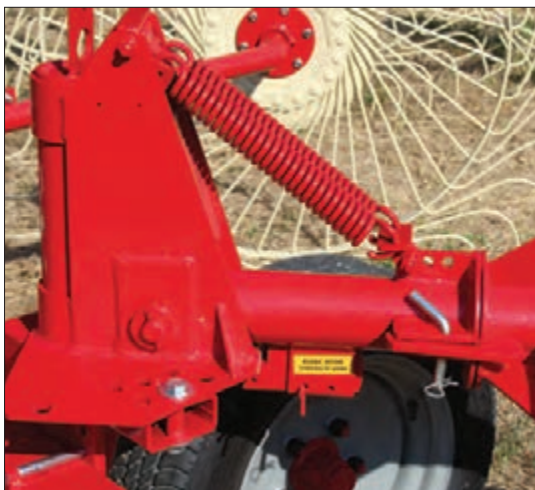
شکل ۶۰- فنرهای شناوری شانه خورشیدی
