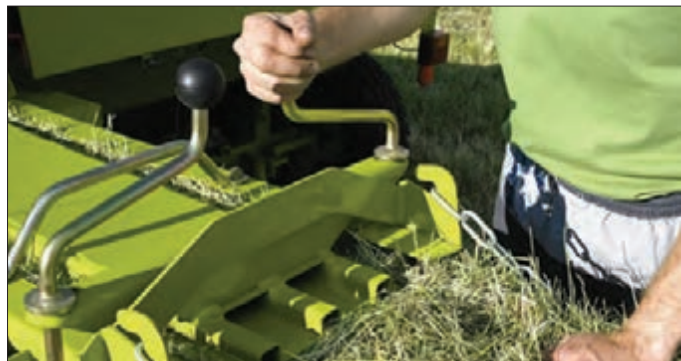
شکل ۱۰۱- تیرک‌های فشاردهنده و تنظیم آن
