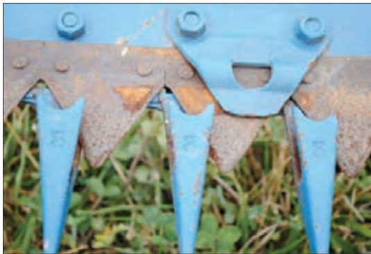
شکل ۱۰- موقعیت انگشتی و تیغه در دروگر شانه‌ای
