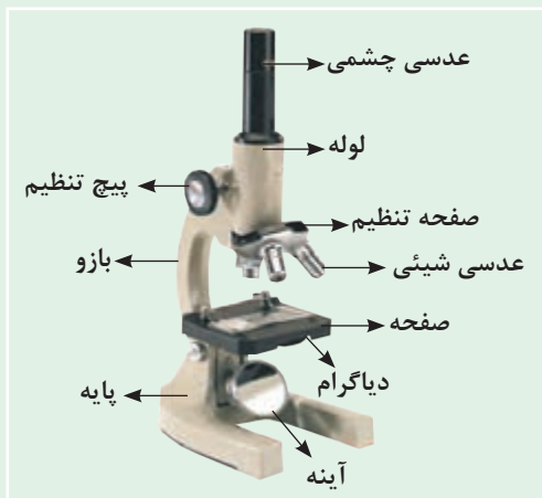
شکل ۲۲- اجزای مختلف نوعی میکروسکوپ
