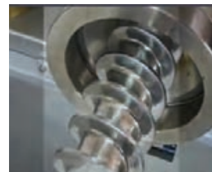
شکل ۱۰- مارپیچ اکسترودر
