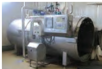
شکل ۹- ری تورت پخت مقدماتی ماهی
