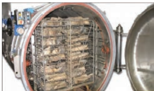
شکل ۹- ری تورت پخت مقدماتی ماهی
