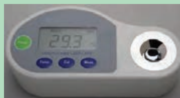
شکل ۵- رفراکتومتر دیجیتال
