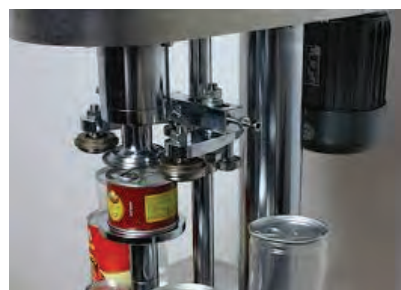
شکل ۵- دستگاه دربندی مضاعف
