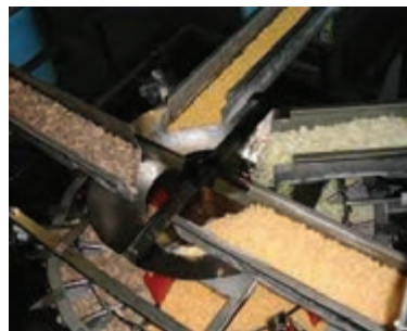
شکل ۵ - سیستم توزین چندگانه
