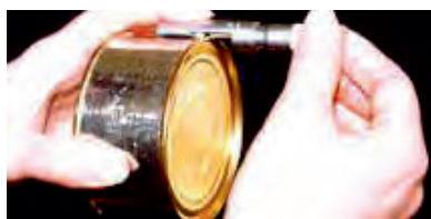
شکل ۳- اندازه‌گیری طول دوخت
