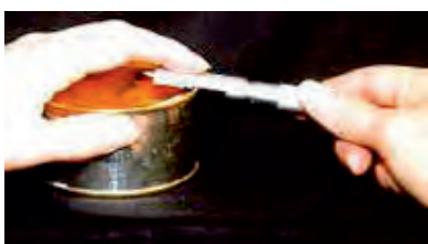
شکل ۴- اندازه‌گیری عرض دوخت
