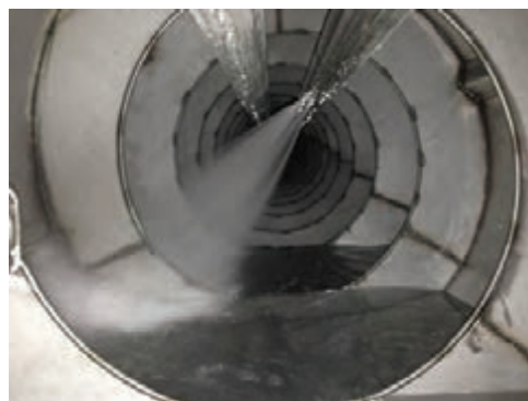
شکل ۵- شست‌وشوی افشانی با استوانه گردان
