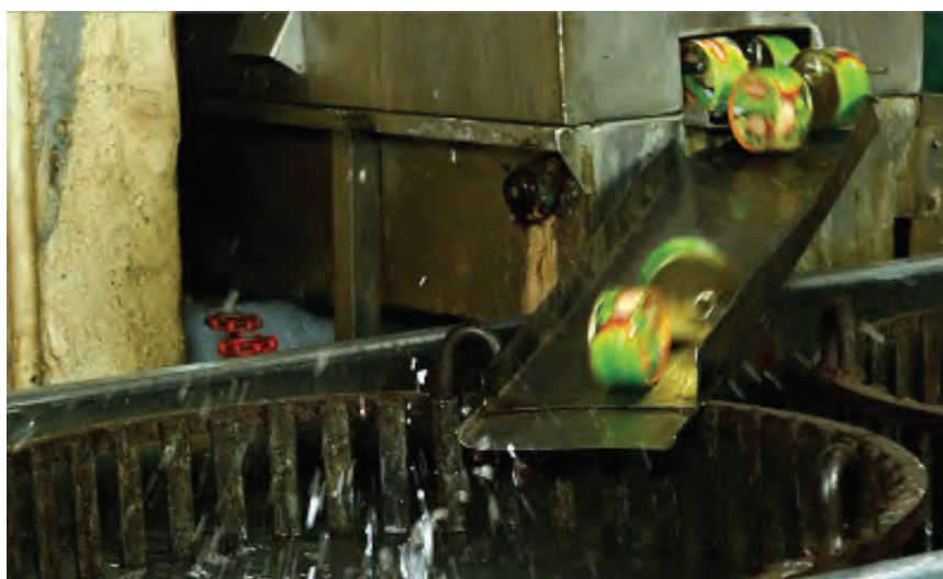
شکل ۲- وارد شدن قوطی‌های فلزی به سبدهای اتوکلاو
