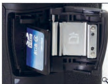
محل نصب کارت حافظه بر روی دوربین
