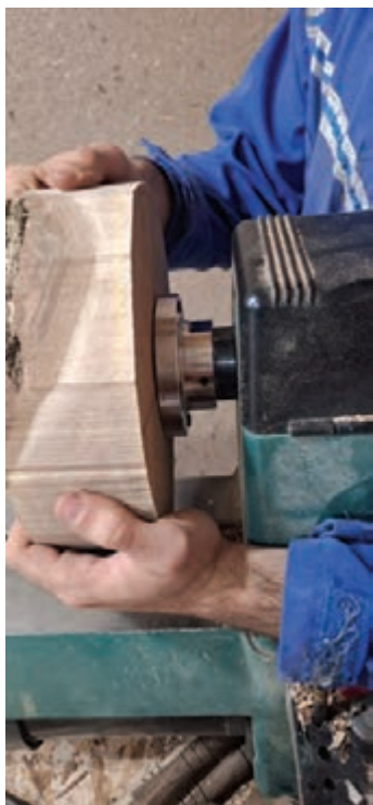
شکل ۶- آماده سازی قطعه کار برای بیرون تراشی
