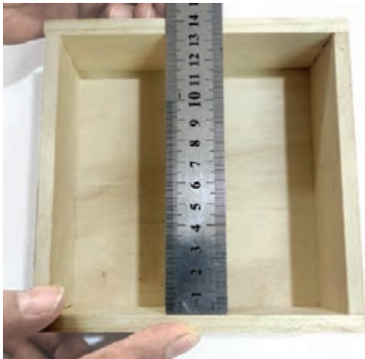
شکل ۲۲- اندازه‌گیری ابعاد نهایی در از روی بدنه جعبه
