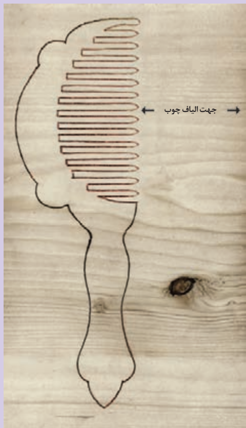
شکل ۴- تشخیص جهت الیاف چوب
