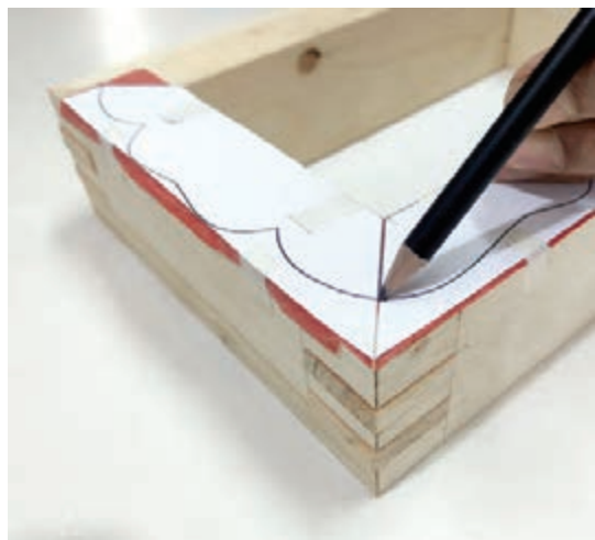
شکل ۴۱- انتقال فرم‌های منحنی بر روی قطعات دیواره
