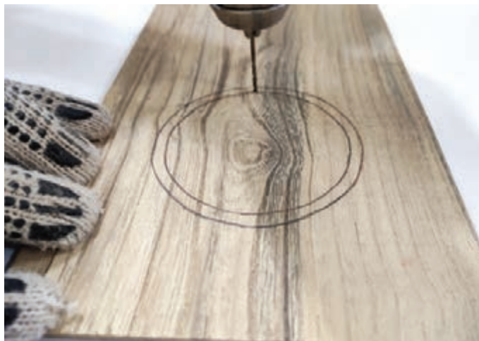
شکل ۳۱- سوراخ کاری و برش زهوار منحنی
