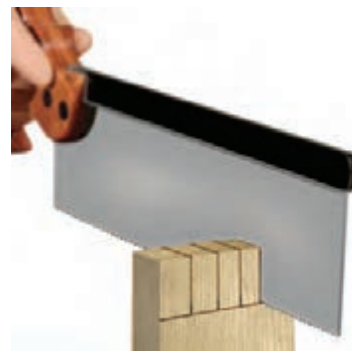
شکل ۱۷- برش دندانه‌ها به وسیله اره پشت‌دار
