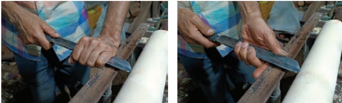
شکل ۳۲- روش صحیح در دست گرفتن مغار هنگام کار
