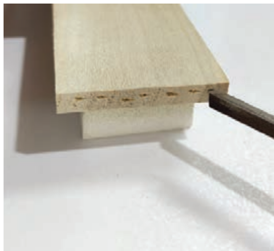
شکل ۵۵- ایجاد سطح اتصال با کمک مغار
