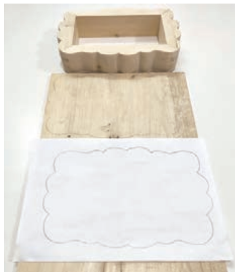
شکل ۴۴- انتقال الگو روی قطعه چوب در کف
