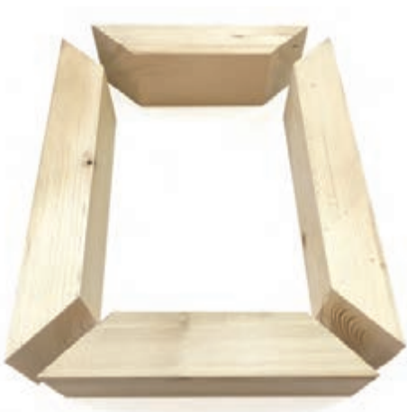
شکل ۳۱- برش قطعات دیواره جعبه
