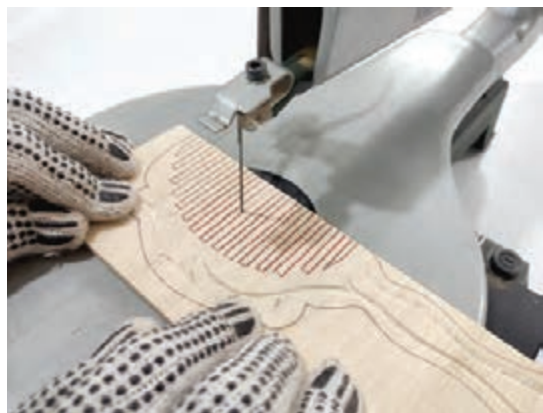
شکل ۳۵- برش دندان‌های شانه
