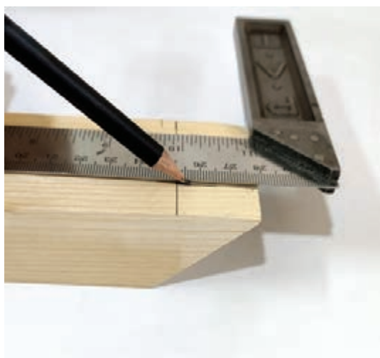
شکل ۳۳- رسم محل اتصال قلیف
