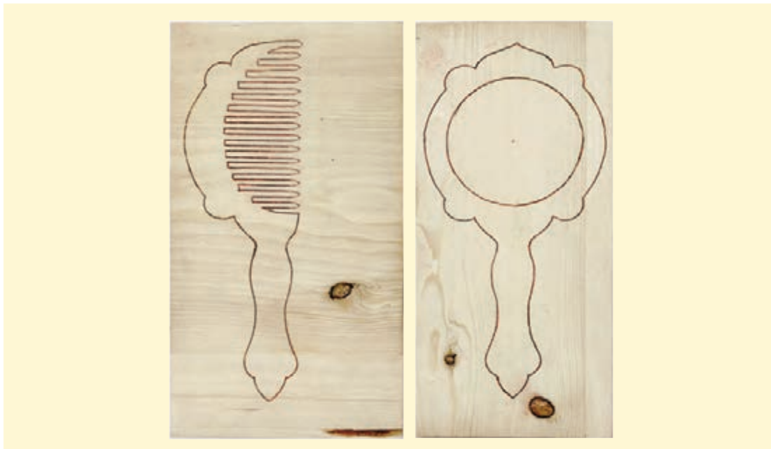
شکل ۱۸- نتیجه نهایی انتقال طرح با کاربن بر روی چوب
