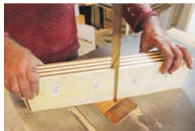
شكل ۱۶- تصاویر قامه اصلی (قامه بزرگ)، آماده برش به لایه‌های نازک‌تر برای ساخت قامه نهایی
