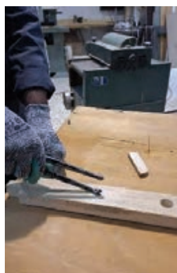
شکل ۸- خارج کردن میخ از چوب با گاز انبر
