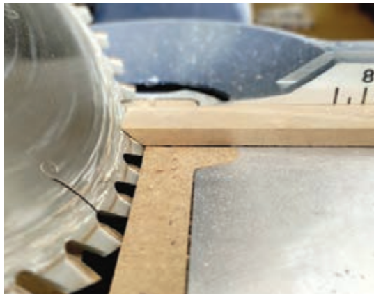
شکل ۶۴- برش لبه اتصال زهوارها
