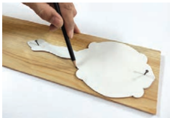
شکل ۱۴- روش انتقال طرح با شابلون
