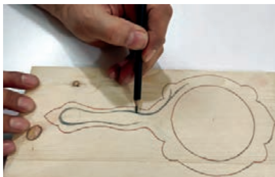
شکل ۱۹- مشخص کردن شیارهای تزیینی با مداد رو و پشت چوب
