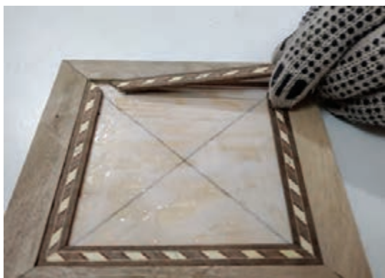
شکل ۳۰- چسباندن جوک روی سطح جعبه
