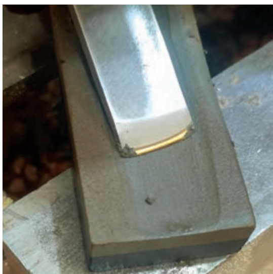
شکل ۳۶- پلیسه‌گیری مغار موب و نیزه‌ای
