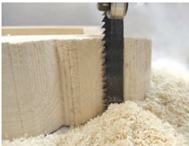
شکل ۴۲- برش فرم کلی جعبه به وسیله اره فلکه
