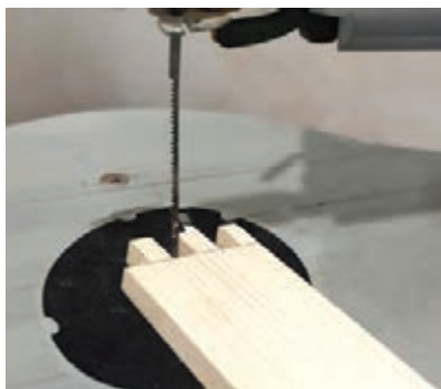
شکل ۱۸- برش نهایی دندانه‌ها به وسیله اره مویی برقی
