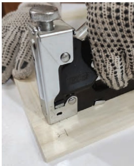
شکل ۵۶- چسب زدن و منگنه کردن قطعات
