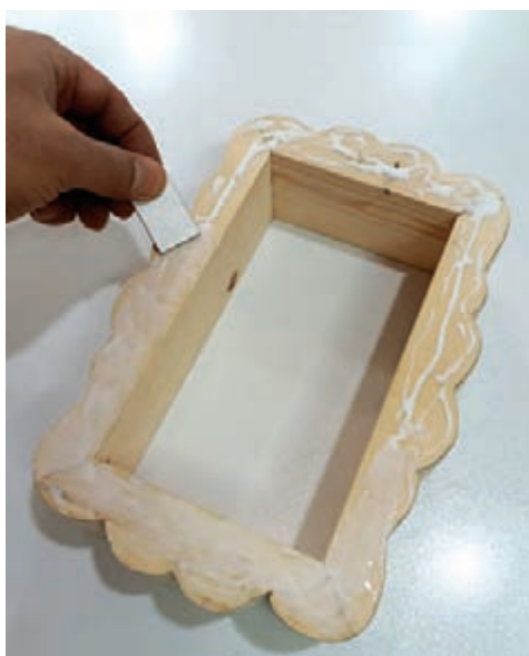
شکل ۴۶- چسب زدن قطعات کف و در جعبه
