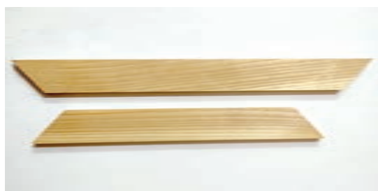
شکل ۴۹- قطعات قاب آماده شده با برش ۴۵ درجه
