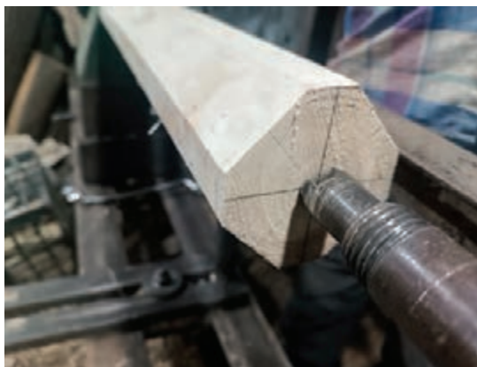
شکل ۲۵- محکم کردن قطعه با اهرم‌ها
