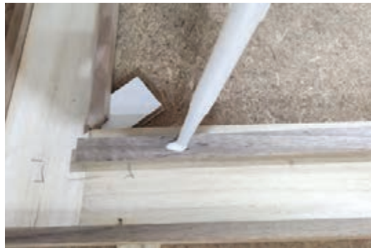
شکل ۷۰- چسباندن زهوار داخلی
