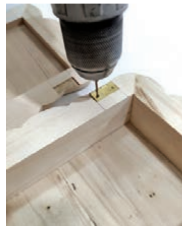
شکل ۵۶- سوراخ‌کاری محل پیچ لولا روی جعبه
