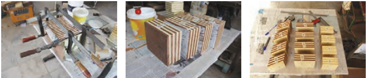
شکل ۱۳- مراحل چیدمان و پرس کردن قطعات
