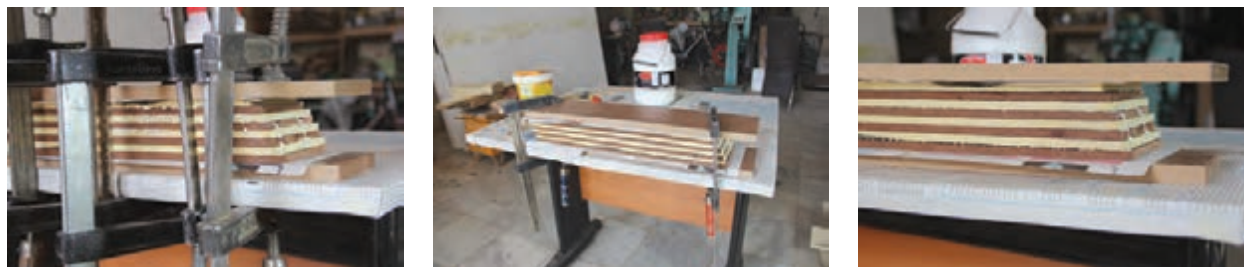
شکل ۸- چسب زدن و پرس لایه ها
