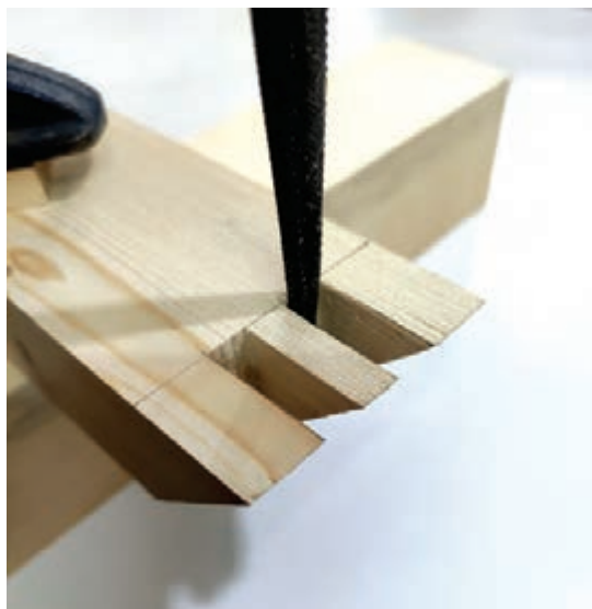
شکل ۴۰- پرداخت کاری اتصالات
