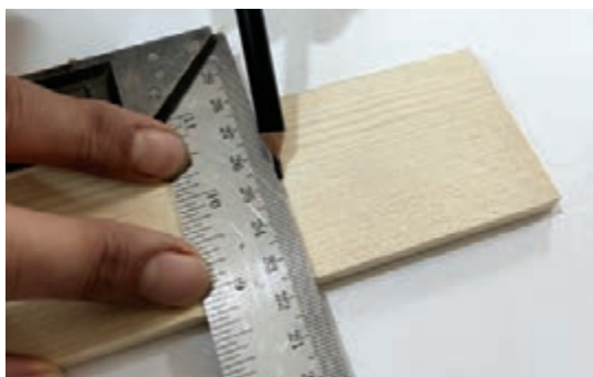
شکل ۵- انتقال اندازه‌ها روی چوب
