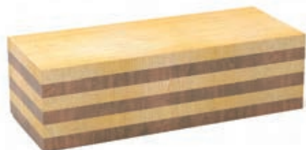
شکل ۷- لایه های پرس شده چوب های تیره و روشن
