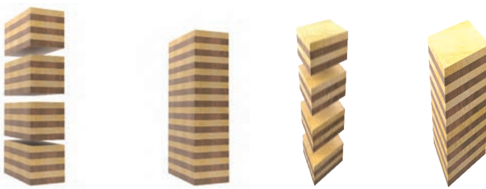
شکل ۱۲- چیدمان و پرس قطعات قامه اولیه
