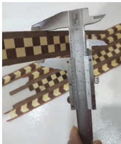
شکل ۲۸- اندازه‌گیری اووه (پهنا) به وسیله کولیس
