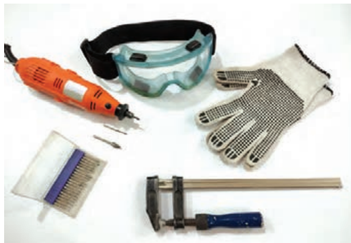
شکل ۲۱- ابزار و وسایل موردنیاز شیاراندازی
