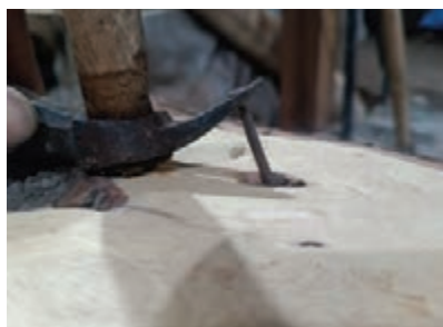
شکل ۷- روش خارج کردن میخ از چوب با میخ‌کش
