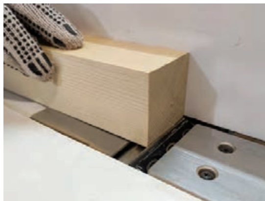
شکل ۲۹- رنده کردن قطعات جعبه
