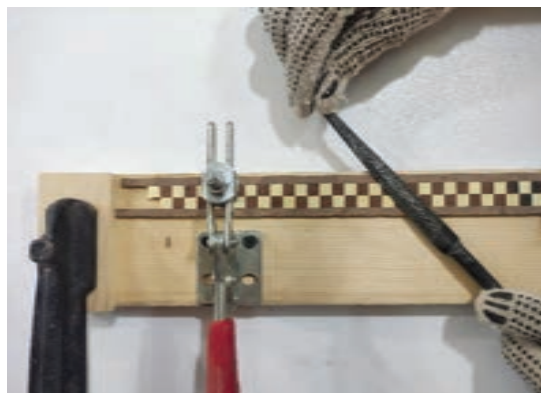
شکل ۲۷- روش یکنواخت کردن ضخامت ورقه‌ها
