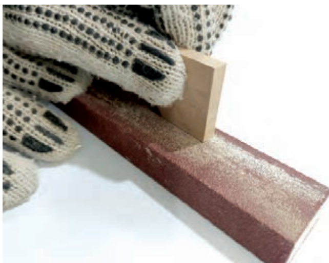
شکل ۷۳- اصلاح جزئی مربع‌ها به وسیله سنباده
