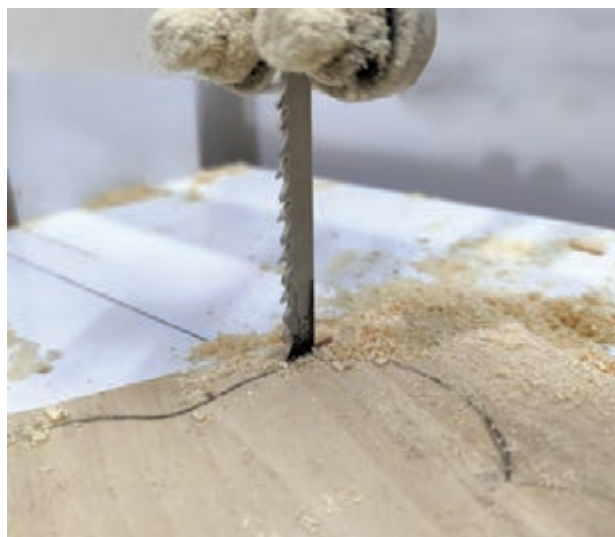
شکل ۴۵- برش کف و در جعبه به وسیله اره فلکه
