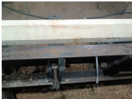
شکل ۲۶- محل قرار گیری قطعه چوب بین دو مرغک و پیشکار
