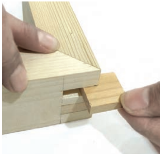
شکل ۳۷- آزمایش اتصال خشک
