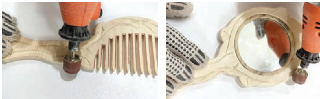
شکل ۴۴- پرداخت کاری آینه و شانه با فرزمینیاتوری
