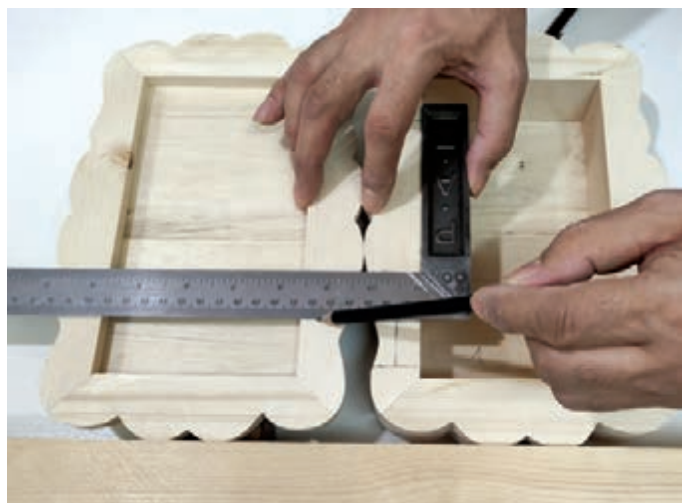
شکل ۵۴- مشخص کردن محل نصب لولا
