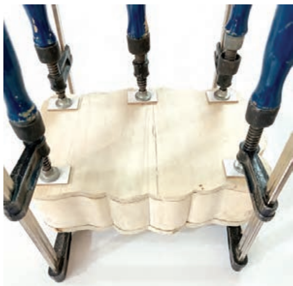
شکل ۴۷- پرس کردن قطعات در و کف روی بدنه جعبه
