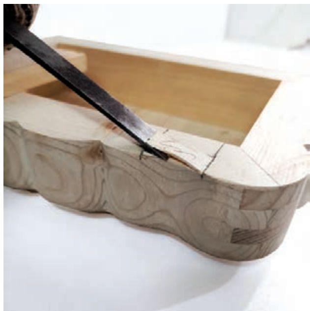
شکل ۵۵- خالی کردن محل لولاها به وسیله مغار
