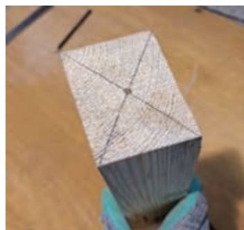
شکل ۱۶- مراحل مرکزیابی روی چوب چهارتراش
