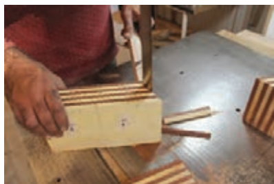
شكل ۱۶- تصاویر قامه اصلی (قامه بزرگ)، آماده برش به لایه‌های نازک‌تر برای ساخت قامه نهایی
