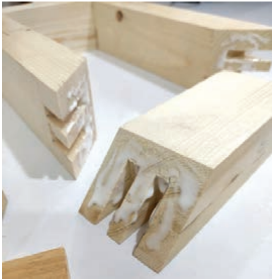
شکل ۳۸- چسب کاری قطعات اتصال
