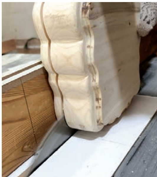
شکل ۵۱- برش در جعبه به وسیله اره
