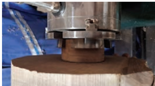
شکل ۴- بستن قطعه به چهار نظام
