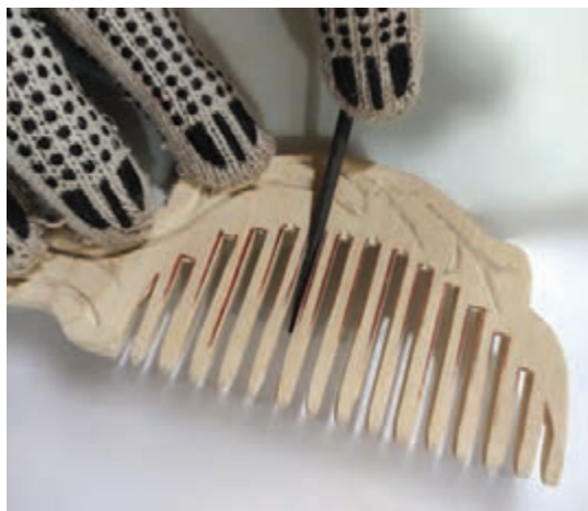
شکل ۳۶- سوهان و سنباده کاری دندان‌ها
