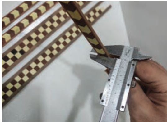
شکل ۲۶- اندازه‌گیری ضخامت ورقه‌های جوک
