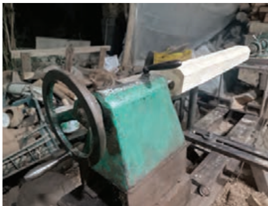
شکل ۲۴- قرار گرفتن مرغک و چهار نیش بر نقطه مرکزی قطعه چوب
