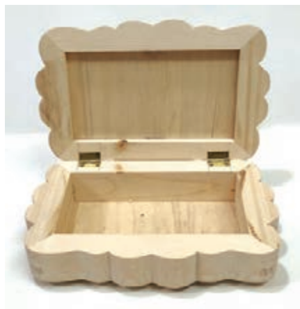
شکل ۵۸- تکمیل نصب هر دو لولا
