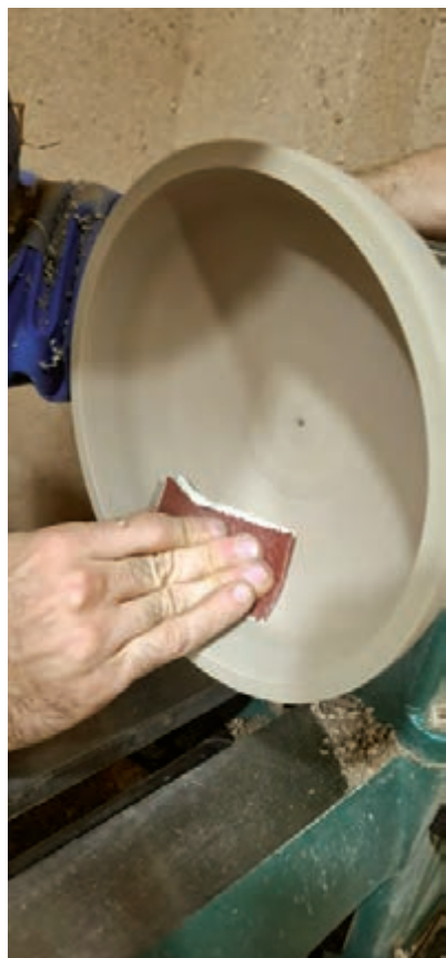
شکل ۱۹- پرداخت داخل کاسه با سنباده
