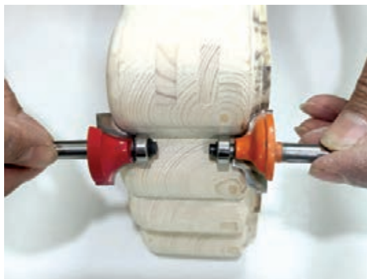
شکل ۴۸- تیغ‌های استفاده شده برای ابزار در وکف جعبه
