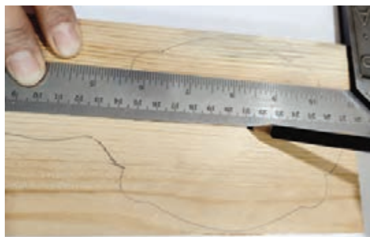
شکل ۱۹- مشخص کردن شیارهای تزیینی با مداد رو و پشت چوب
