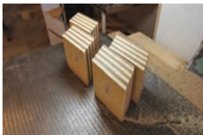
شكل ۱۶- تصاویر قامه اصلی (قامه بزرگ)، آماده برش به لایه‌های نازک‌تر برای ساخت قامه نهایی
