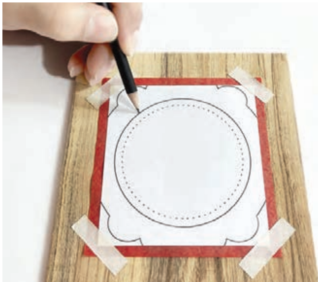
شکل ۳۰- انتقال الگوی زهوار بر روی چوب
