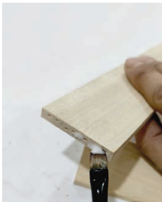
شکل ۵۶- چسب زدن و منگنه کردن قطعات
