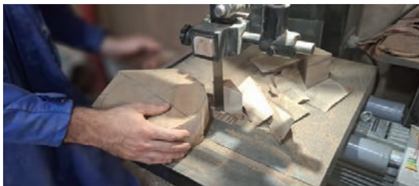
شکل ۲- آماده‌سازی چوب جهت بیرون تراشی
