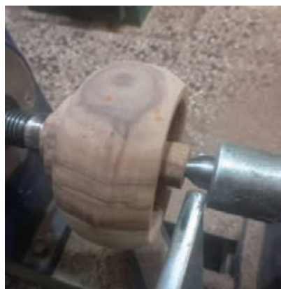
شکل ۱۳- داخل تراشی به روش چهار نظام
