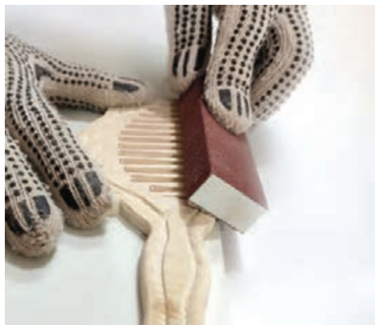
شکل ۳۶- سوهان و سنباده کاری دندان‌ها
