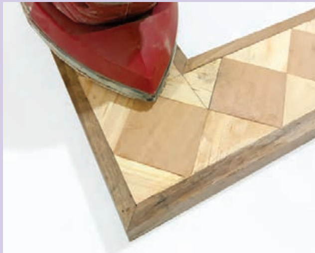
شکل ۷۶- سنباده زنی نهایی کار با دستگاه لرزان
