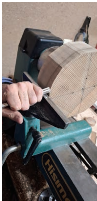
شکل ۸- نمونه کاسه در حال بیرون تراشی
