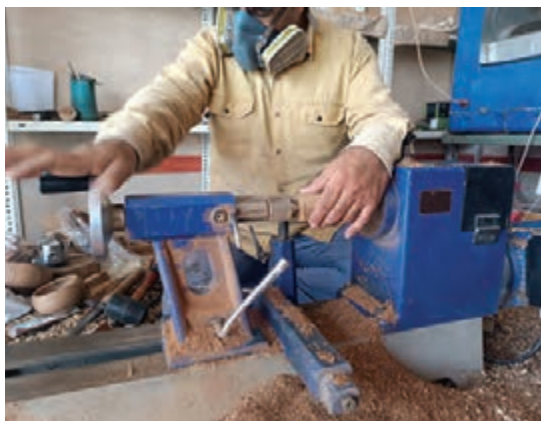
شکل ۴۲- محکم کردن اهرم مرغک پس از قرار دادن چوب روی دستگاه
