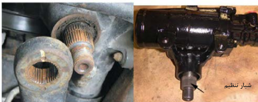
شکل ۳۲ - هزار خار محور خروجی جعبه فرمان
