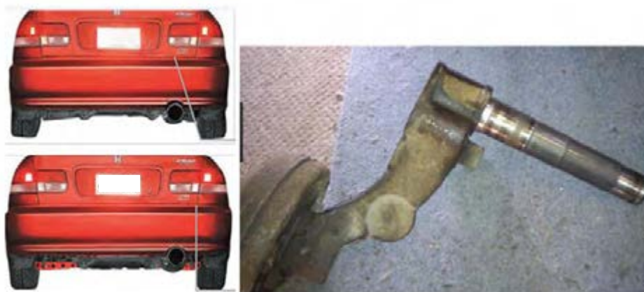
شکل ۴۳- خرابی بوش‌ها و تأثیر آن روی چرخ
