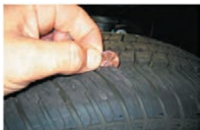
شکل ۱۷- نحوه اندازه‌گیری تقریبی شیار تایر
