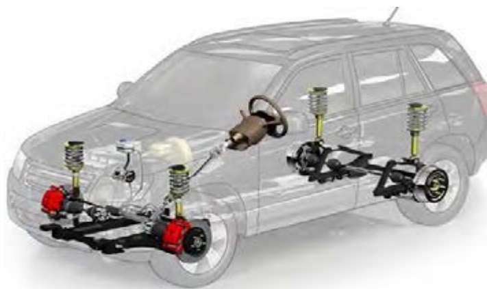
شکل ۳- مکانیزم تعلیق
