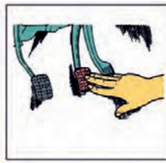
شکل ۱۵- بررسی خلاصی پدال ترمز
