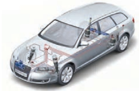
شکل ۲۸- سیستم تعلیق فعال
