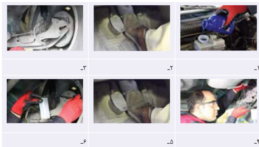
شکل ۱۹- مراحل هواگیری دستی مدار هیدرولیک ترمز
