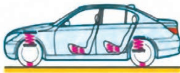
شکل ۱- سیستم تعلیق در خودروی سواری
