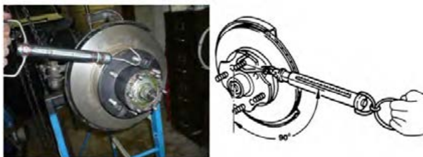
شکل ۱۸- بررسی توپی و بلبرینگ یا رولبرینگ
