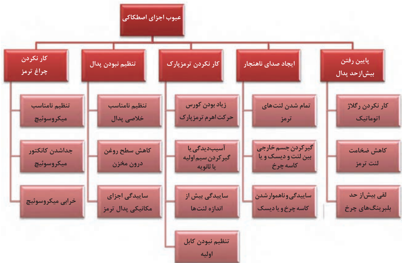
شکل ۲۳- عیوب اجزای اصطکاک‌ی
