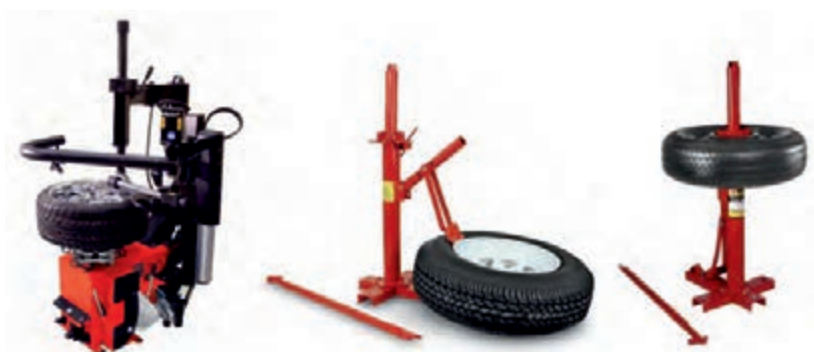
شکل ۳۳- دستگاه لاستیک درآر دستی و پنوماتیکی
