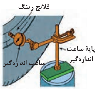
شکل ۱۸- بررسی تغییر شکل تایر و رینگ
