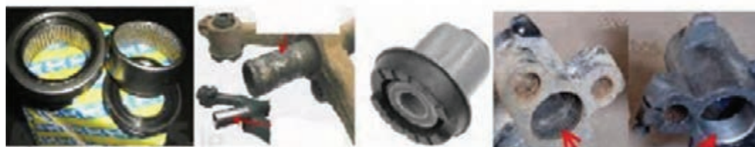
شکل ۴۲- قطعات تعلیق با بازوی کشنده
