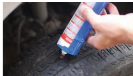
شکل ۲۷- مراحل پنچرگیری تایر بدون تیوب
