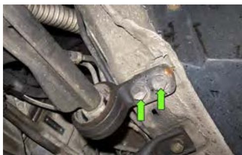
گشتاور سنجی اتصالات پیچ و مهره ای
