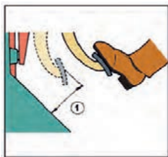
شکل ۱۶- بررسی فاصله پدال ترمز تا کف
