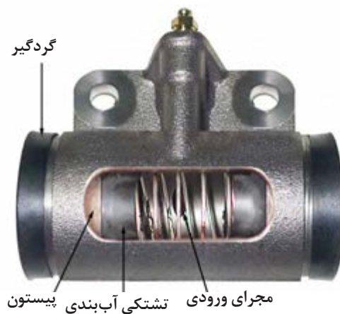
شکل ۳۸- سیلندر ترمز (کفشکی)
