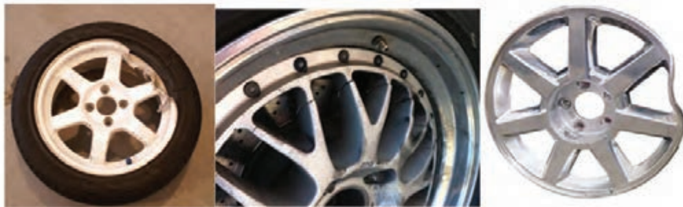
شکل ۳۵- بررسی ظاهری رینگ
