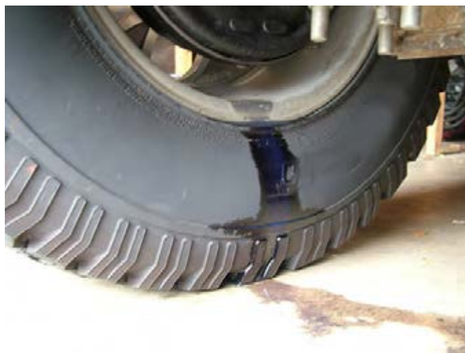
شکل ۴۱- وجود مایع اطراف چرخ عقب
