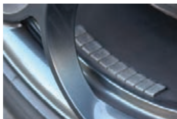
شکل ۳۲- وزنه‌های بالانسی تایر روی رینگ
