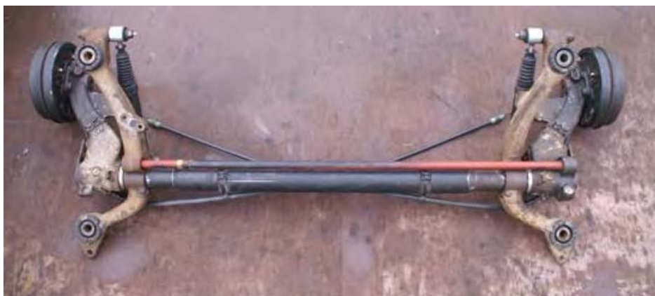
شکل ۴۱- مجموعه تعلیق عقب با فنر پیچشی
