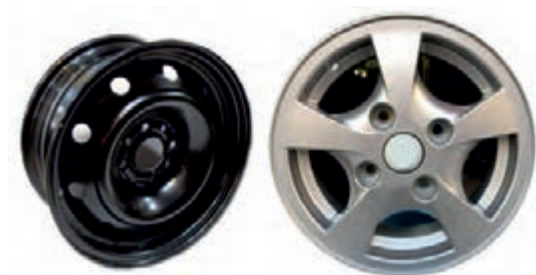
شکل ۱۰- رینگ آلومینیومی و فولادی
