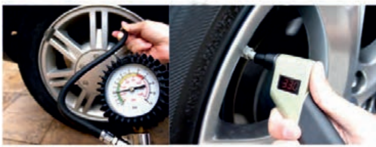
شکل ۲۱- شیوه بررسی و تنظیم فشار باد تایر
