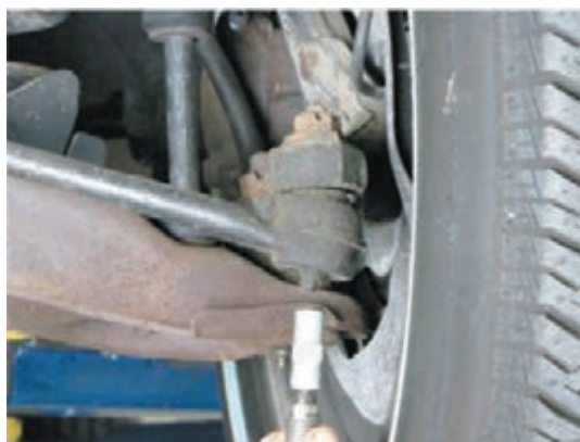
شکل ۳۳ - روش گریس کاری سیبک
