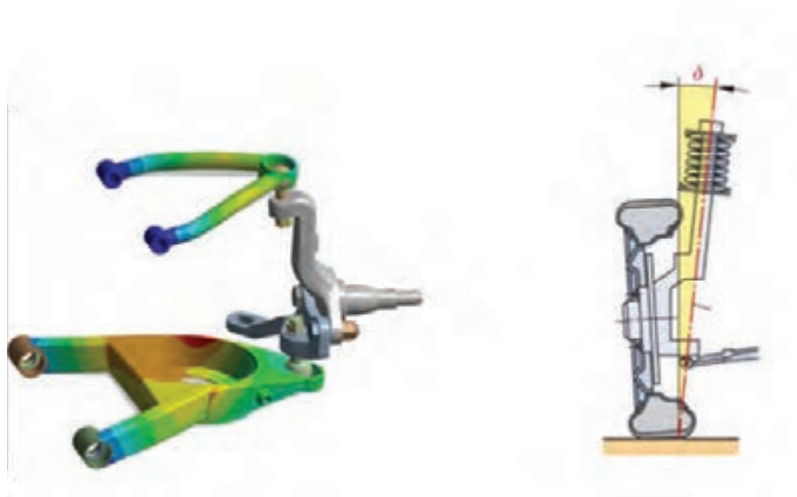
شکل ۱۴- سگدست و محور آن
