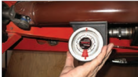
شکل ۱۳-۳- روش استفاده از زاویه سنج میل گاردان
