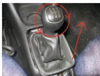
شکل ۲-۲۵- بیرون آوردن سری و گردگیر دسته دنده
