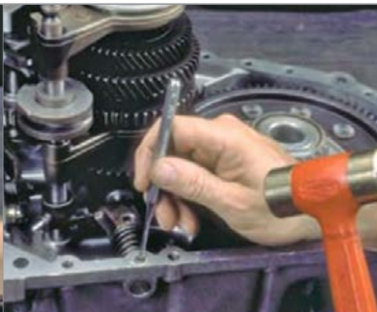
بیرون آوردن پین نگهدارنده اهرم تعویض دنده
