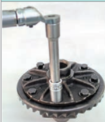
شکل ۵۰-۴- بستن پیچ‌های کرانویل
