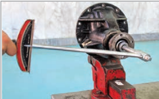
شکل ۴۸-۴- (ب) تعیین گشتاور پیش بار با گشتاورسنج
