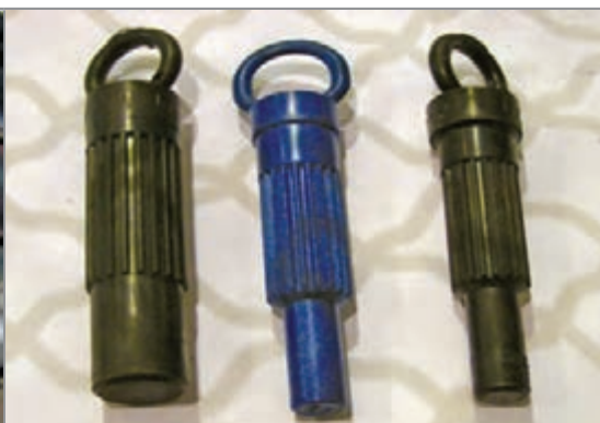
شکل ۱-۳۶- نمونه‌هایی از ابزار هم‌محورکننده صفحه کلاچ
