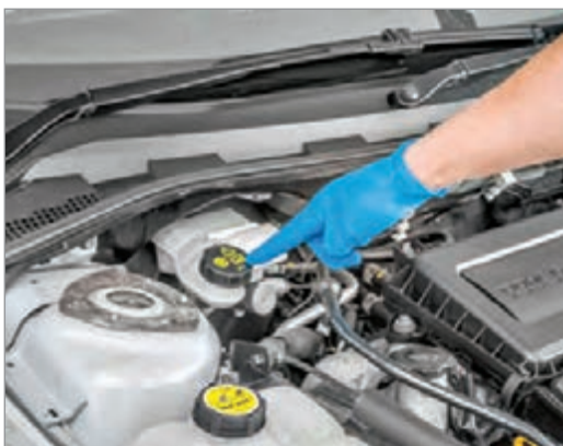
شکل ۱۶-۱ مخزن مایع مشترک در یک خودرو
