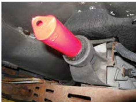
شکل ۳-۱۹- استفاده از ابزار مخصوص کورکن
