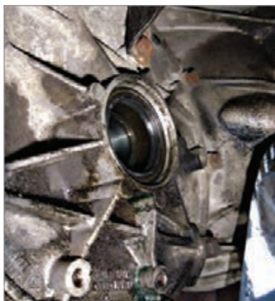
شکل ۲۸-۵- بررسی محل نصب پلوس
