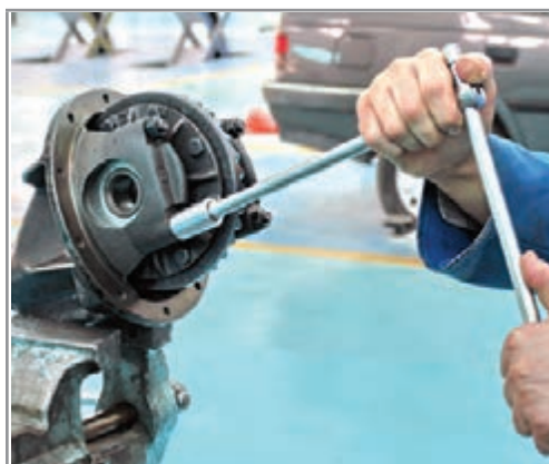
شکل ۵۳-۴- بستن کپه یاتاقان ها
