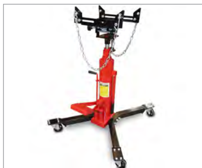
شکل ۲۷-۲. یک نمونه جک نگهدارنده جعبه‌دنده
