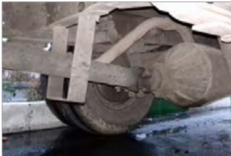
شکل ۳-۱۸- محافظ گاردان
