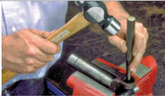
شکل ۳-۲۱- مراحل باز کردن اجزای گاردان
