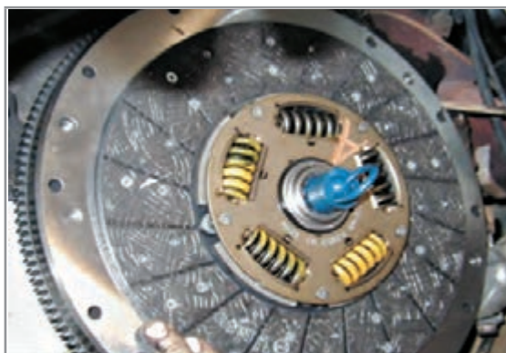
شکل ۱-۳۷- روش قرارگیری شفت هم‌محورکننده صفحه کلاچ
