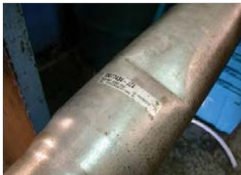
شکل ۱۵-۳- دیدن آثار ضربه روی سطح میل گاردان
