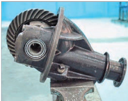
شکل ۴-۲۷- بستن مجموعه دیفرانسیل روی گیره
