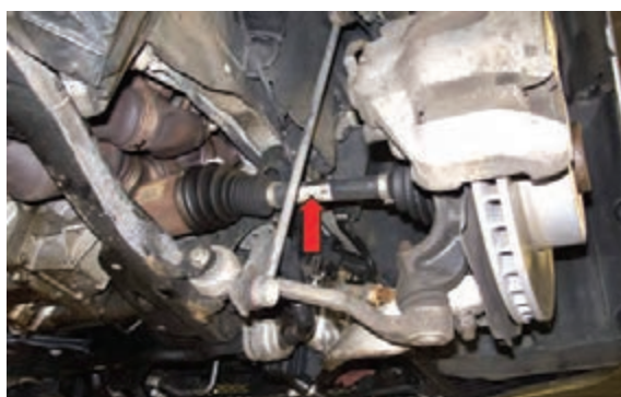
بررسی دسته نگهدارنده جعبه‌دنده
