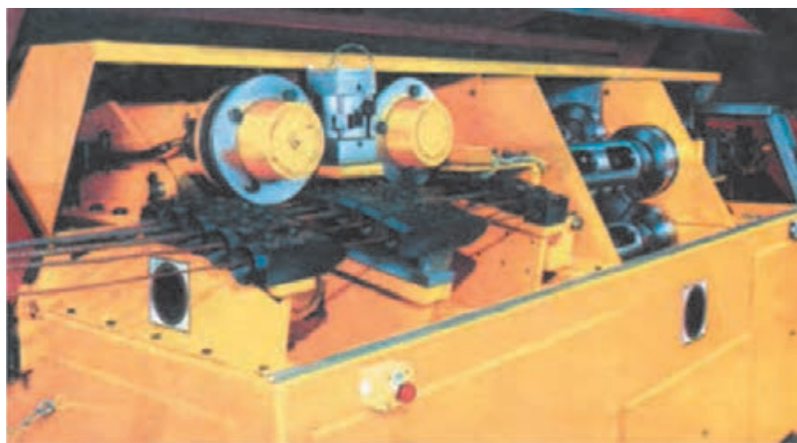
شکل ۲۹ - دستگاه کشش برقی برای صاف کردن میلگرد ▲
