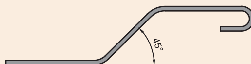
میل گرد با خم ۴۵ درجه یک طرفه (ادکا)
