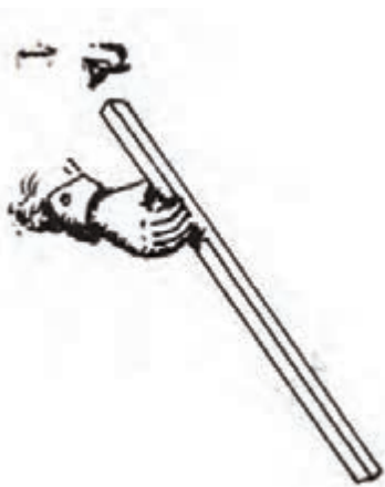
شکل ۴-۴. قرار دادن چشم در دو طرف شمشه به منظور کنترل صاف بودن
