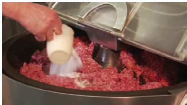
شکل ۷- مخلوط کردن مواد در دستگاه کاتر
