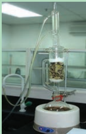
شکل ۱۰- دستگاه سوکسله
