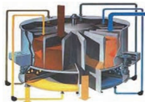
شکل ۹- اکستراکتور تراوشی دوار
