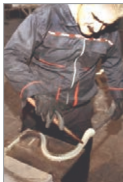
شکل ۷- شکل دهی گوی با کمک ابزار
