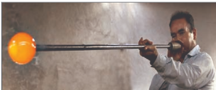
شکل ۵- ایجاد حباب در لقمه مذاب با دمیدن
