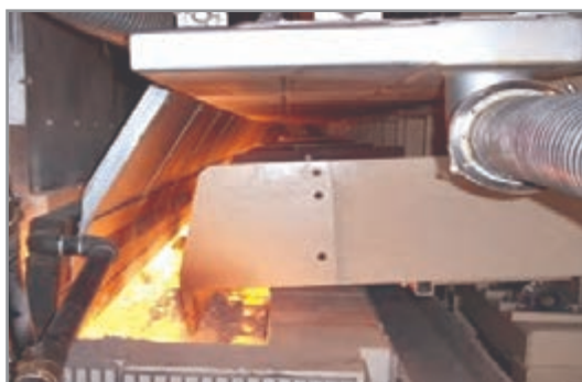
شکل ۱۷- دریچه بارریز کوره‌های شیشه تخت
