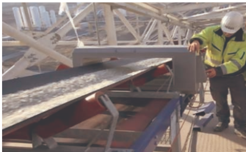
شکل ۳۱- فرایند آهن‌گیری هنگام انتقال مواد پودر شده
