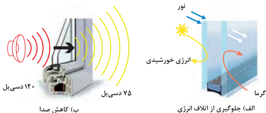
شکل ۴۲- عایق حرارتی و صوتی شیشه دو جداره
