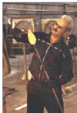
شکل ۷- شکل دهی گوی با کمک ابزار
