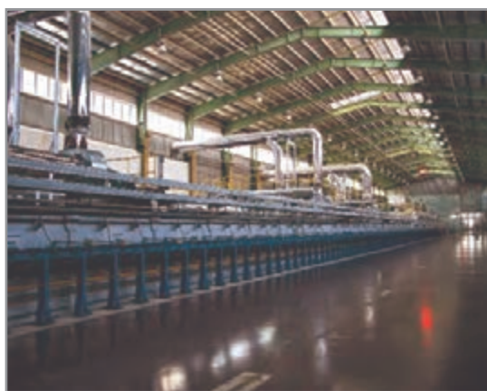
شکل ۳۰- گرمخانه تنش زدایی شیشه
