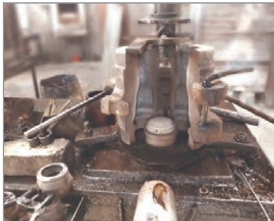
شکل ۱۳- قالب پرس بادی
