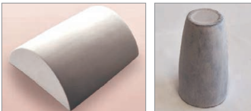
شکل ۲۷- قالب فلزی مورد استفاده در دراپینگ
