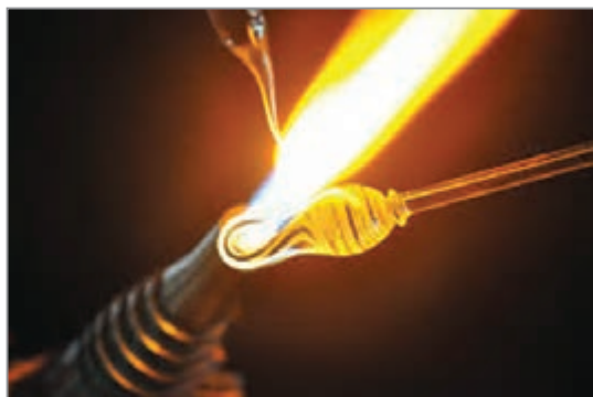
شکل ۱۴- شیشه گری با شعله
