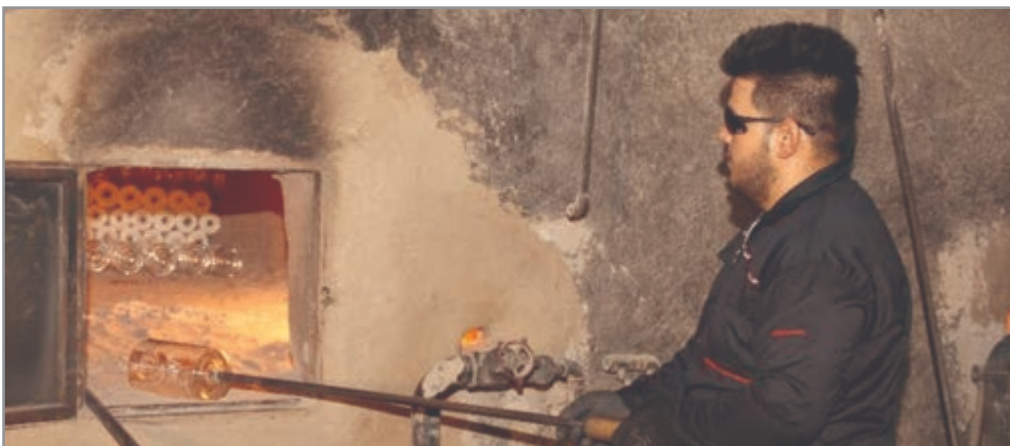
شکل ۹- قرارگیری شیشه در گرمخانه
