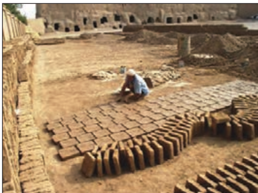
شکل ۵۴-۱ خشت خام (ساخت آجر به روش دستی)
