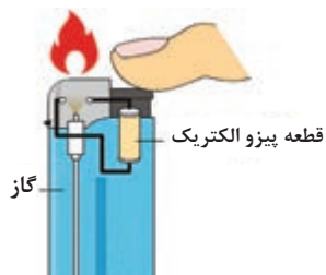
شکل ۱۲ (ج) - کاربرد پیزوالکتریک در فندک
