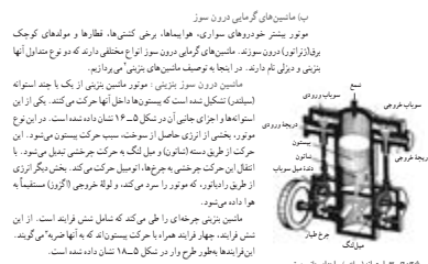
تصویر ۳: موتورهای گرمایی درون سوز موتور پنتون: موتورهای گرمایی درون سوز، هوا، اسیلها، برخی کشتی‌ها، قطارها و موتورهای کوچک برون‌سوز و درون سوز هستند. ماشین‌های گرمایی درون سوز انواع مختلفی دارند که در نوع مثال آنها پنتون و دیزل نام دارند. در اینجا به توصیف ماشین‌های پنتون می‌پردازیم. ماشین درون سوز پنتون: موتور ماشین پنتون از یک یا چند استوانه (سیلندر) تشکیل شده است که پیستونها داخل آنها حرکت می‌کنند. یکی از این استوانه‌ها و اجزای جانی آن در شکل ۱-۴ نشان داده شده است. در این نوع موتور، بخشی از انرژی حاصل از سوخت، سبب حرکت پیستون می‌شود. با حرکت از طریق دسته (شاتون) و میل لنگ به حرکت چرخشی تبدیل می‌شود. با انتقال این حرکت چرخشی به چرخ‌ها، آتومیل حرکت می‌کند. بخش دیگر انرژی از طریق رادیاتور، که موتور را سرد می‌کند، و ترمز چرخشی (اگر در استیلینا به هوا داده می‌شود). ماشین پنتون: برخلاف موتورهای درون سوز، در ماشین پنتون سوخت در یک استوانه جداگانه قرار دارد و از طریق یک لوله به استوانه اصلی می‌رسد. این فرایندها بطور طرح رار در شکل ۱-۵ نشان داده شده است.
