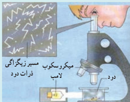
آزمایشی برای مشاهده حرکت براونی ذرات دود درون یک ظرف شیشه‌ای
