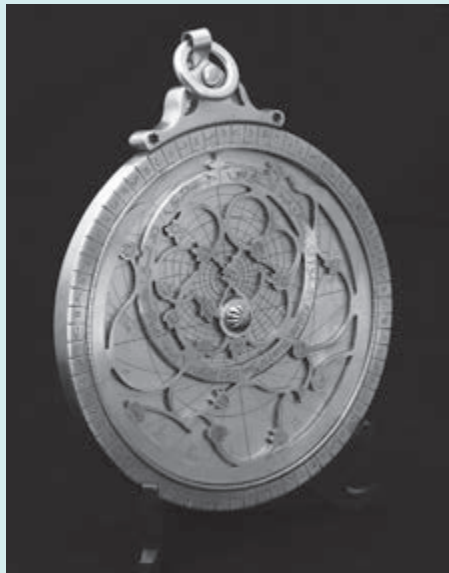
اسطرلاب، یک ابزار قدیمی که متجمین در رصد و اندازه‌گیری‌های نجومی به کار می‌برده‌اند.
