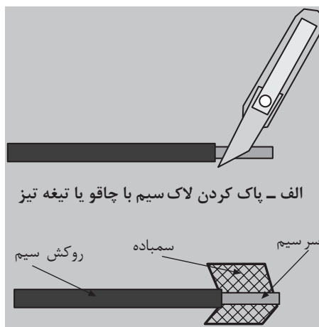
شکل (۱-۵) پاک کردن لاک سیم با سمباده
