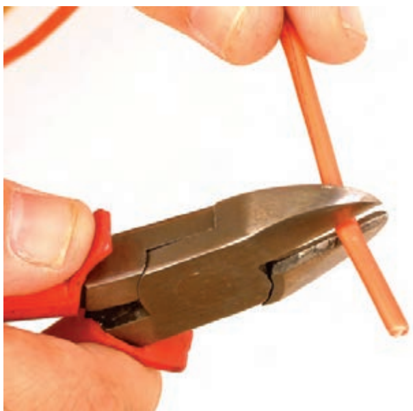
شکل ۱۰-۱- هنگام بریدن سیم سر آن به سمت زمین گرفته شود.
