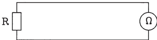
شکل ۵-۵۴- مدار اتصال اهم متر به مقاومت
