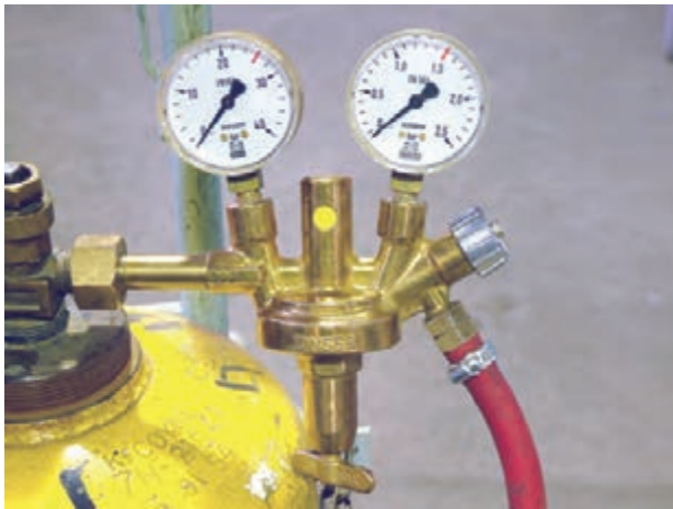
شکل ۱۳۵-۲- پیچ تنظیم فشار استیلن روی رگولاتور
