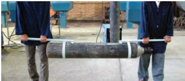
شکل ۸۶-۲- روش درست جابه‌جا کردن کپسول
