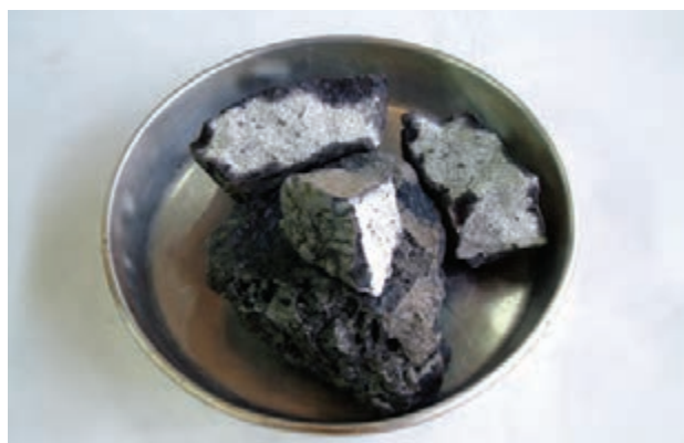
شکل ۲-۱۱- مقطع شکسته شده‌ی سنگ کربید و شکل ظاهری آن
