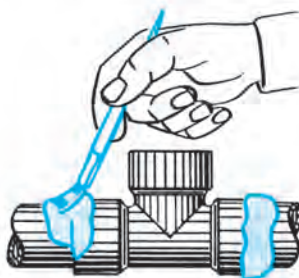
شکل ۴-۱۶- چگونگی اضافه کردن فلاکس مایع روی لوله و دهانه سهراهی
