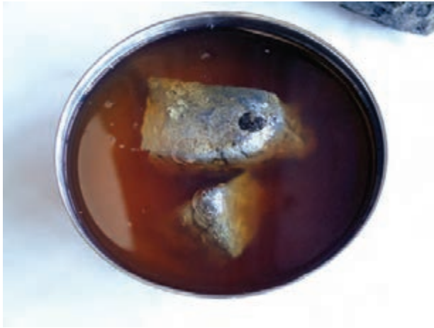
شکل ۱۲-۲- نگهداری کاربید در زیر نفت
