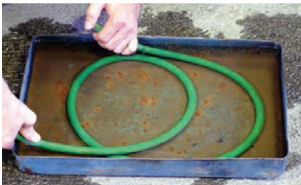
شکل ۲-۹۹ – کنترل نشتی شیلنگ در آب
