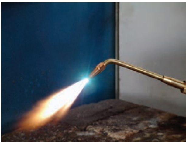
شکل ۲-۳- شعله‌ی سوختن گاز استیلن با اکسیژن
