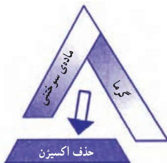
شکل ۱۶-۱- ممانعت از رسیدن اکسیژن به ماده‌ی سوختنی
