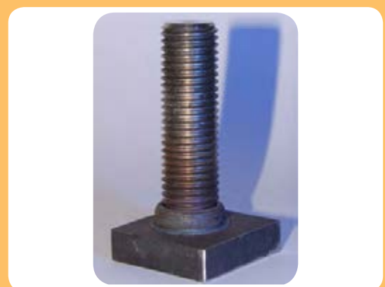
نمونه قطعه جوشکاری شده به روش اصطکاکی
