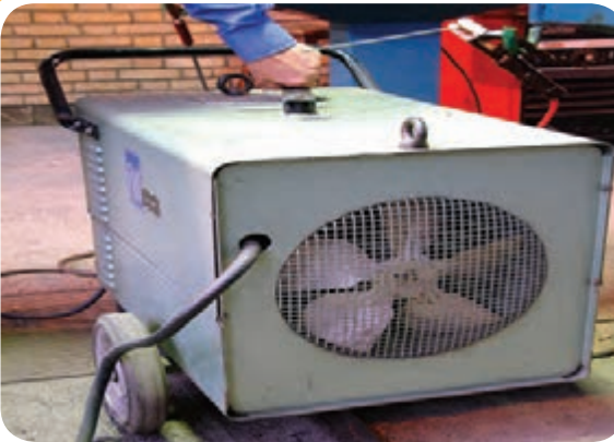
ترانسفورماتوری که شدت جریان خروجی با جابجایی هسته صورت می‌گیرد.
