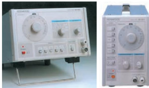
شکل ۶-۴۲ دو نمونه سیگنال ژنراتور صوتی
