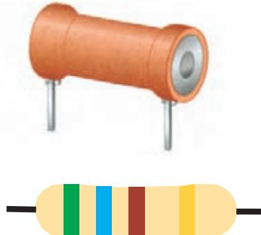
شکل ۲-۱ دو نمونه مقاومت اهمی (R)
