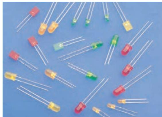
شکل ۱۲-۱۷- نمونه هایی از انواع LED
