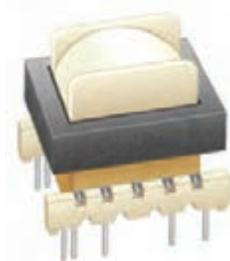
شکل ۱۱-۳۰ ساختمان یک نوع ترانسفورماتور در شکل ۱۱-۳۱ نماد فنی دو نوع ترانسفورماتور با ولتاژ ثانویه متفاوت را مشاهده می‌کنید.
