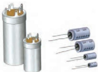
الف) شکل ظاهری خازن الکتروولیتی
