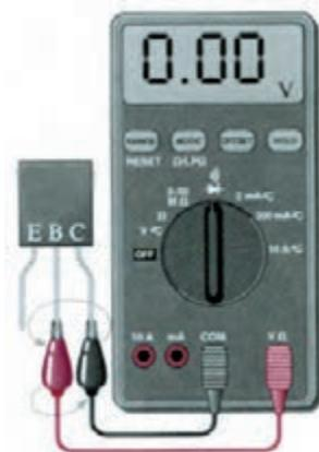
شکل ۱۲-۵۰ ترانزیستور معیوب (اتصال کوتاه)
