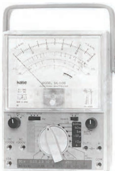
شکل ۲-۲۲ یک نمونه مولتی متر عقرهای (آنالوگ)
