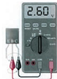
شکل ۱۲-۴۹ ترانزیستور معیوب (قطع)
