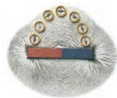
شکل ۸-۳ اثر میدان مغناطیسی روی قطب‌نما و براده‌های آهن
