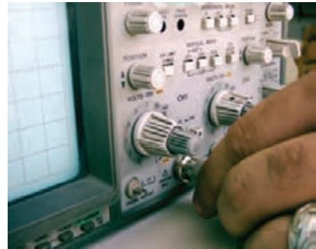
شکل ۶-۶ نحوهی اتصال BNC به اسیلوسکوپ
