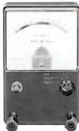
شکل ۳-۲۶- یک نمونه گالوانومتر صفر وسط
