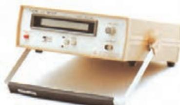
شکل ۱-۵۴ یک نمونه LC متر
