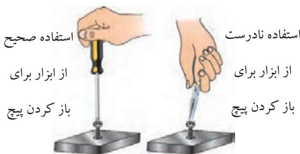
شکل ۱-۳۵ انتخاب درست ابزار کار و نحوه‌ی کاربرد صحیح آن
