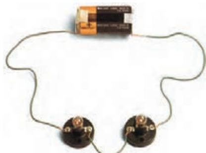
شکل ۲-۲۹ مدار واقعی دو لامپ به صورت سری
