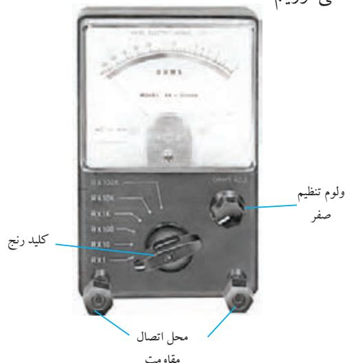
شکل ۲-۲۰ یک نمونه اهم متر آزمایشگاهی
