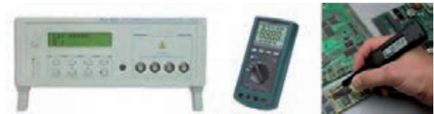
شکل ۷-۵۳ نمونه‌هایی از LCR متر
