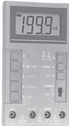
شکل ۲-۲۵ یک نمونه دیگر از مولتی‌متر دیجیتالی
