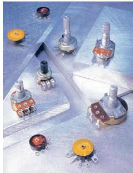
شکل ۲-۴ چند نمونه پتانسیومتر پر کاربرد در الکترونیک
