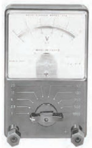
شکل ۲-۹۱ ولت‌متر عقربه‌ای
