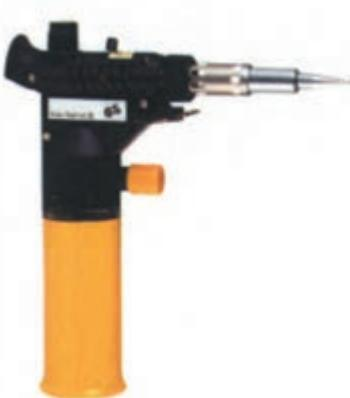
شکل ۳-۴۰ یک نمونه هویه‌ی گازی
