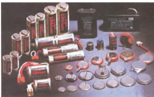
شکل ۱۱۵-۲ انواع پیل و باتری لیتیوم
