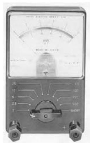
شکل ۲-۱۰۹ یک نمونه میلی‌آمپر متر آزمایشگاهی
