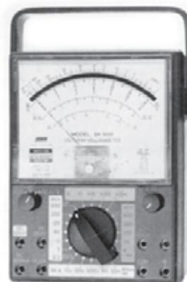
شکل ۲-۲۳ یک نمونه مولتی‌متر عقربه‌ای (آنالوگ)
