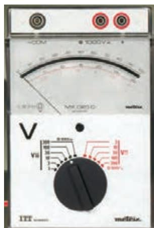
شکل ۱-۵۰ یک نمونه ولت متر آزمایشگاهی
