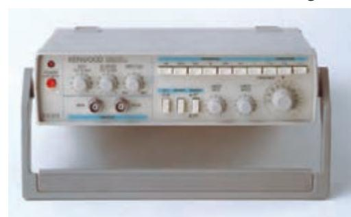
شکل ۶-۴۷ یک نمونه دستگاه فانکشن ژنراتور
