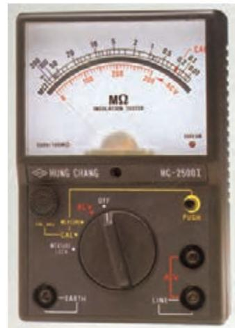
شکل ۱-۵۱ یک نمونه اهم متر آزمایشگاهی
