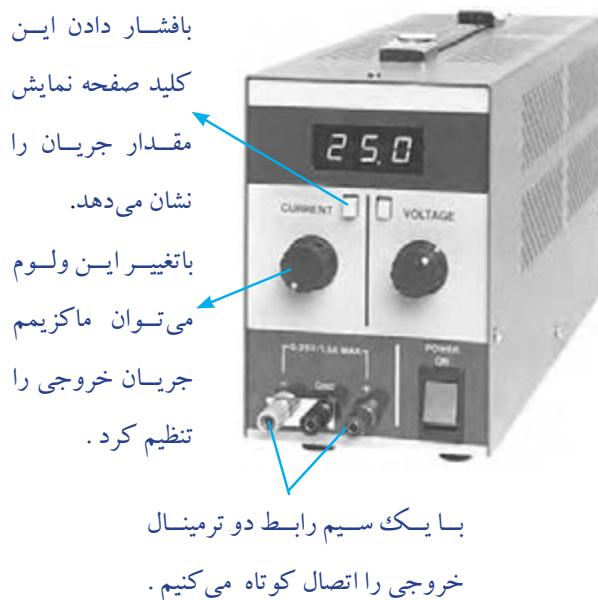
دو نمونه منبع تغذیه آزمایشگاهی با خروجی متغیر نشان داده شده است. خروجی این منابع تغذیه‌ی متغیر ولتاژ DC متغیر است.
