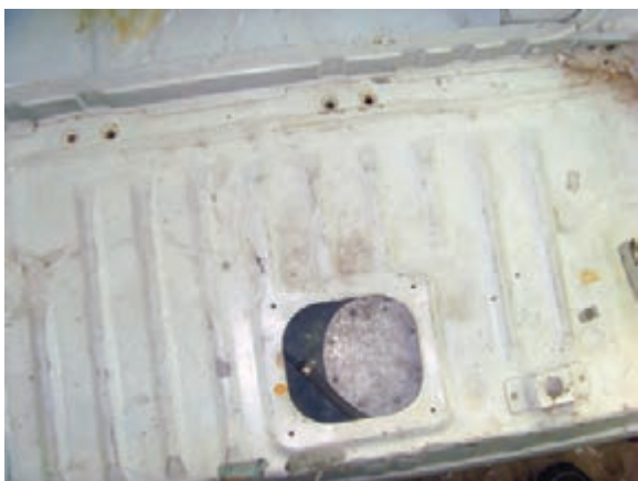
شکل ۱-۲۳ مخزن سوخت از داخل صندوق عقب
