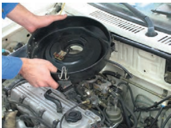
شکل ۱۱۴- ۱ پیاده کردن مجموعه هواکش
