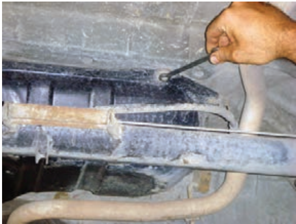
شکل ۱-۲۵ باز کردن پیچهای دور باک
