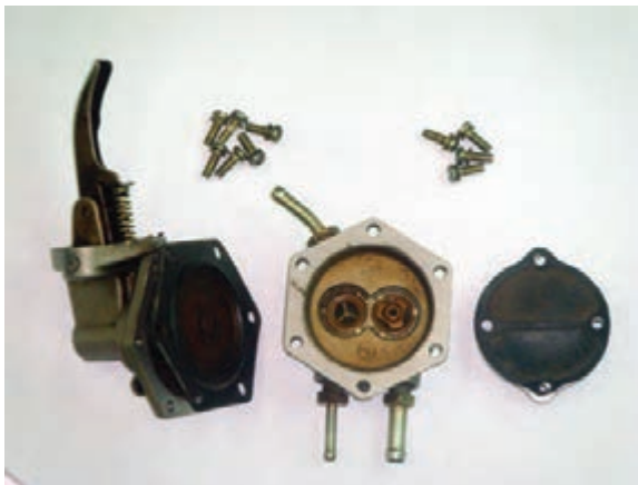
شکل ۴۳-۱ اجزای پمپ سوخت
