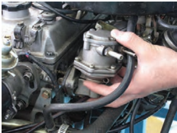
شکل ۴۴-۱ الف: نصب پمپ
