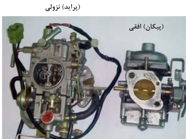
شکل ۱-۶۴ کاربراتورها از نظر حرکت سوخت (نزولی - افقی)
