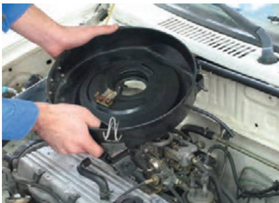
شکل ۱۰۰- پیاده کردن مجموعه هواکش
