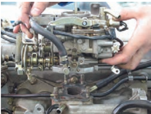
شکل ۱-۱۱۱ پیاده کردن کاربراتور
