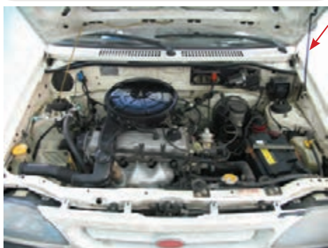
شکل ۱۱۹- ۱ نصب صحیح اهرم نگه‌دارنده درپوش موتور خودرو
