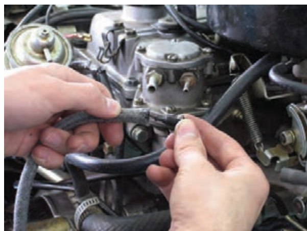
شکل ۴۱-۱ جدا کردن لوله‌ها
