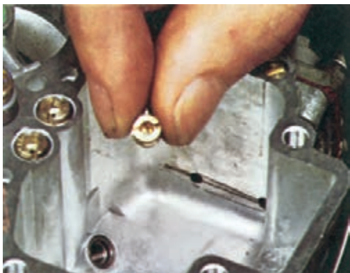
شکل ۱۱۸- ۱ باز کردن ژیکلور اصلی
