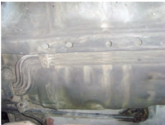
شکل ۱-۳۳ لوله سوخت از مخزن تا پمپ
