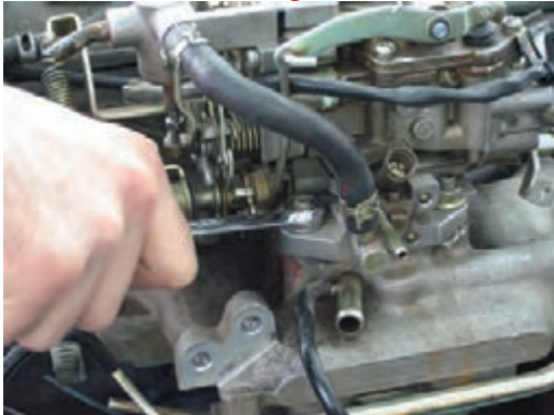
شکل ۱-۱۱۰ باز کردن پیچهای اتصال کاربراتور به موتور
