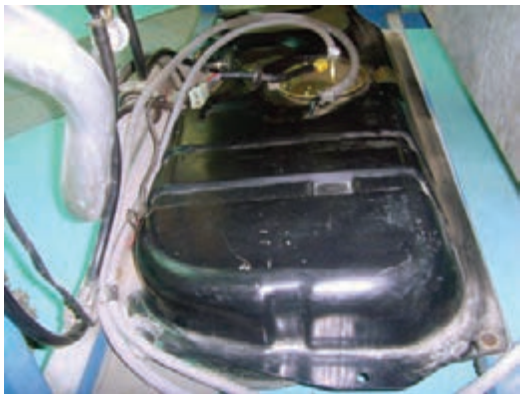
شکل ۱-۲۷ مخزن نصب شده و آماده سوخت گیری
