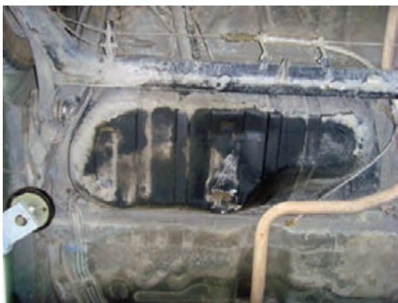
شکل ۱-۲۴ مخزن سوخت از قسمت زیر اتومبیل
