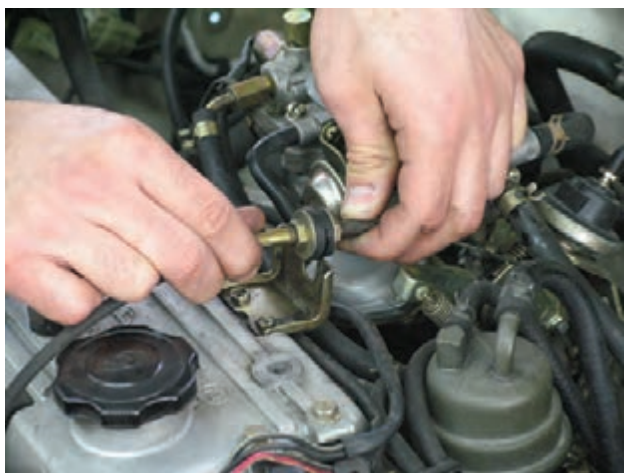
شکل ۱۱۵- پیاده کردن کاربراتور
