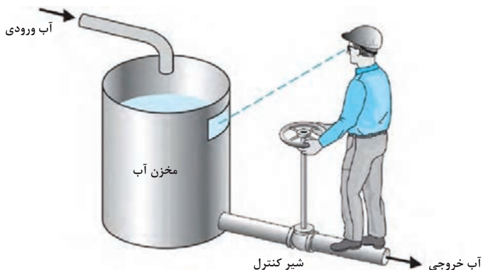
شکل ۵-۱- کنترل دستی ارتفاع آب
