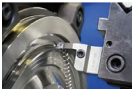
شکل ۶-۴: براده‌برداری به‌وسیله تیغه کاربیدی
