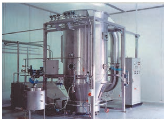
شکل ۲۵-۳- دستگاه مخلوط‌کن بستر سیال
