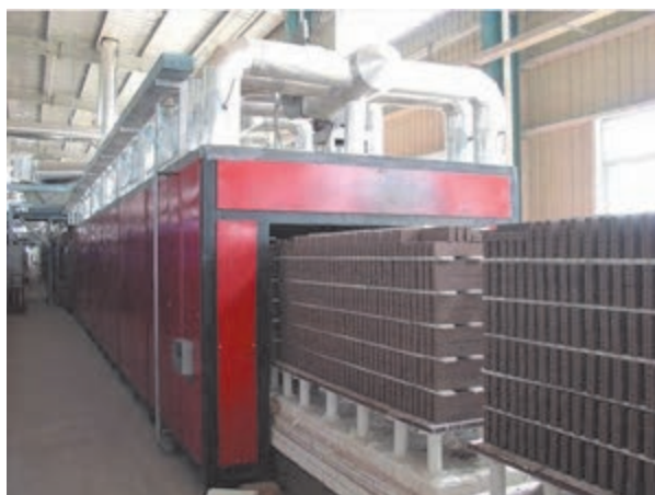
شکل ۱۴-۲- دستگاه خشک‌کن تونلی واگن‌دار
