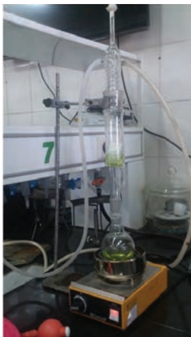
شکل ۱۷-۵- شمای ساده‌ای از سوکسله
