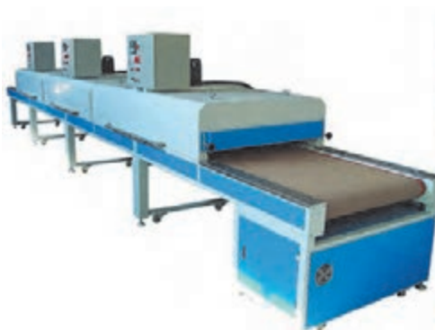
شکل ۱۵-۲- دستگاه خشک‌کن تونلی دارای نوار نقاله
