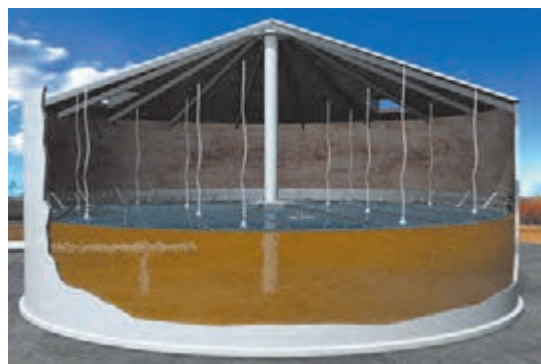
شکل ۱۸-۴ مخازن سقف شناور درونی
