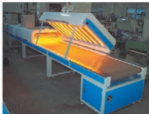
شکل ۱۵-۲- دستگاه خشک‌کن تونلی دارای نوار نقاله
