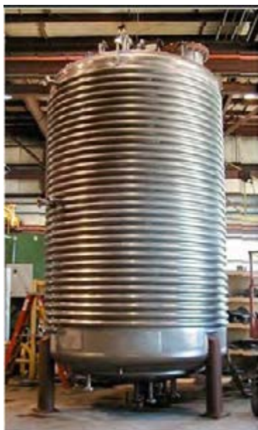
شکل ۵-۴- راکتور ناپیوسته صنعتی با سامانه گرمایی
