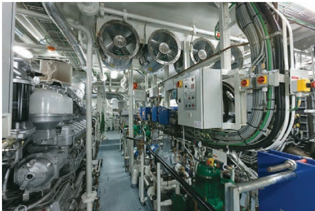
شکل ۱- نمونه‌ای از سامانه تهویه در شناور
