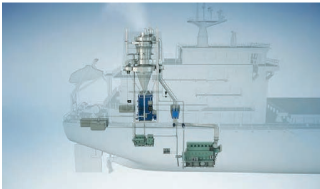
شکل ۲۶- نمایی از سامانه تخلیه دود یک کشتی
