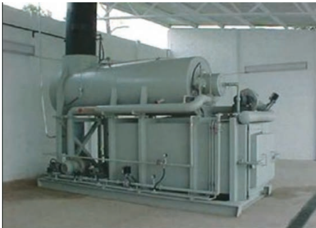
شکل ۱۹- دستگاه زباله‌سوز
