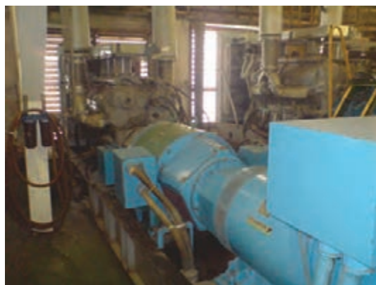
شکل ۱۳- مولدهای DC در شناورها
