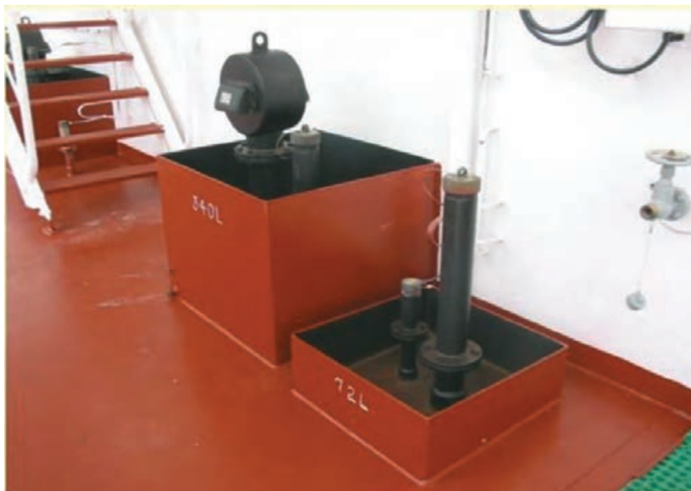
شکل ۲۵- سامانه هوا و اندازه‌گیری مخزن یک کشتی
