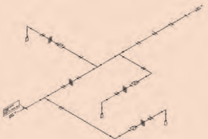
شکل ۵۴- قسمتی از سامانه لوله‌کشی آب توازن
