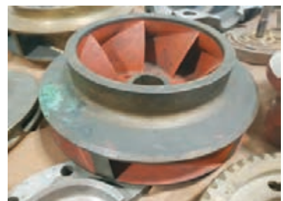
شکل ۳۶ ب) - پروانه بسته
