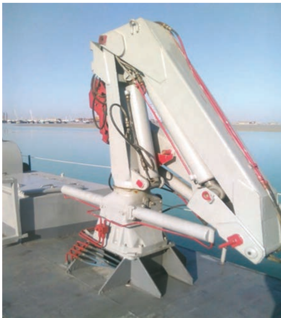
شکل ۲۲- جک هیدرولیکی بر عرشه یک شناور
