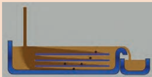
شکل ۲۰- نحوه قرار دادن صفحات موازی درون فیلتر
