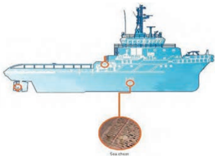
شکل ۲- دریچه ورودی سامانه ورود و توزیع آب دریا
