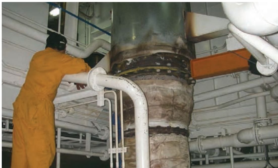
شکل ۲۷- سامانه تخلیه دود یک کشتی
