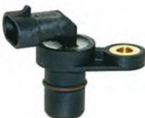
شکل ۱۷- حسگر موقعیت میل بادامک دود
