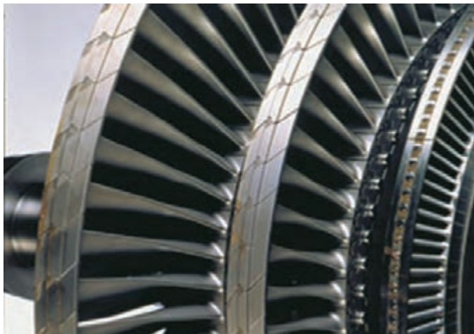
شکل ۷- محل اتصال پره‌ها با چرخ
