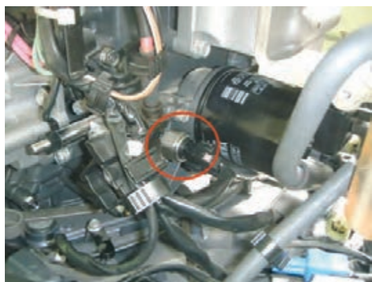
شکل ۲۱- حسگر فشار روغن
