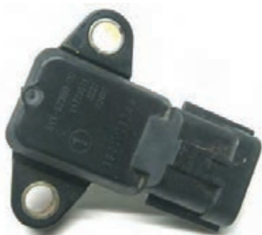
شکل ۱۹- حسگر فشار هوای ورودی
