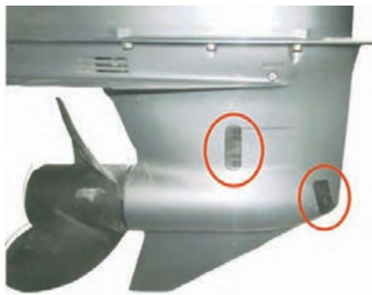
شکل ۳۰- ورودی های آب خنک کننده موتور
