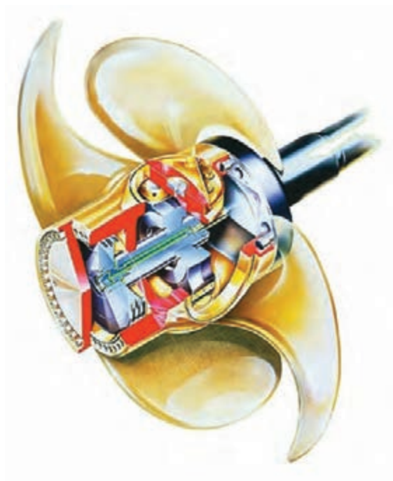
شکل ۷- پروانه گام متغیر
