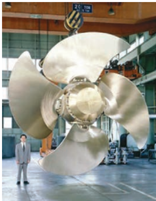
شکل ۷- پروانه گام متغیر
