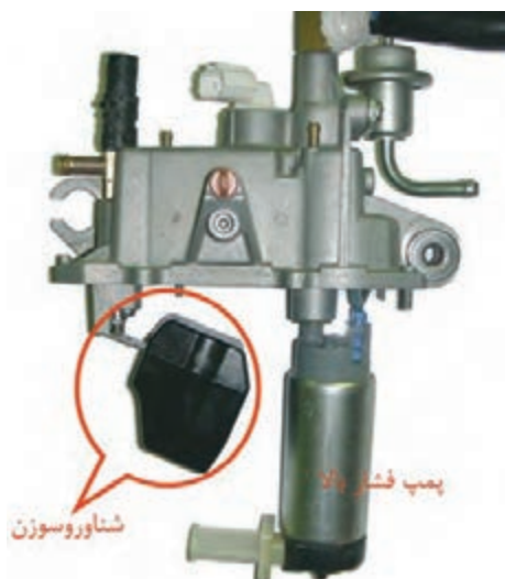
شکل ۸- مجموعه داخل مخزن تفکیک بخار
