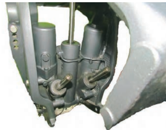
شکل ۳۷- سامانه جک هیدرولیکی
