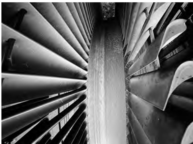
شکل ۸- میله‌های عبور کننده از داخل پره‌ها
