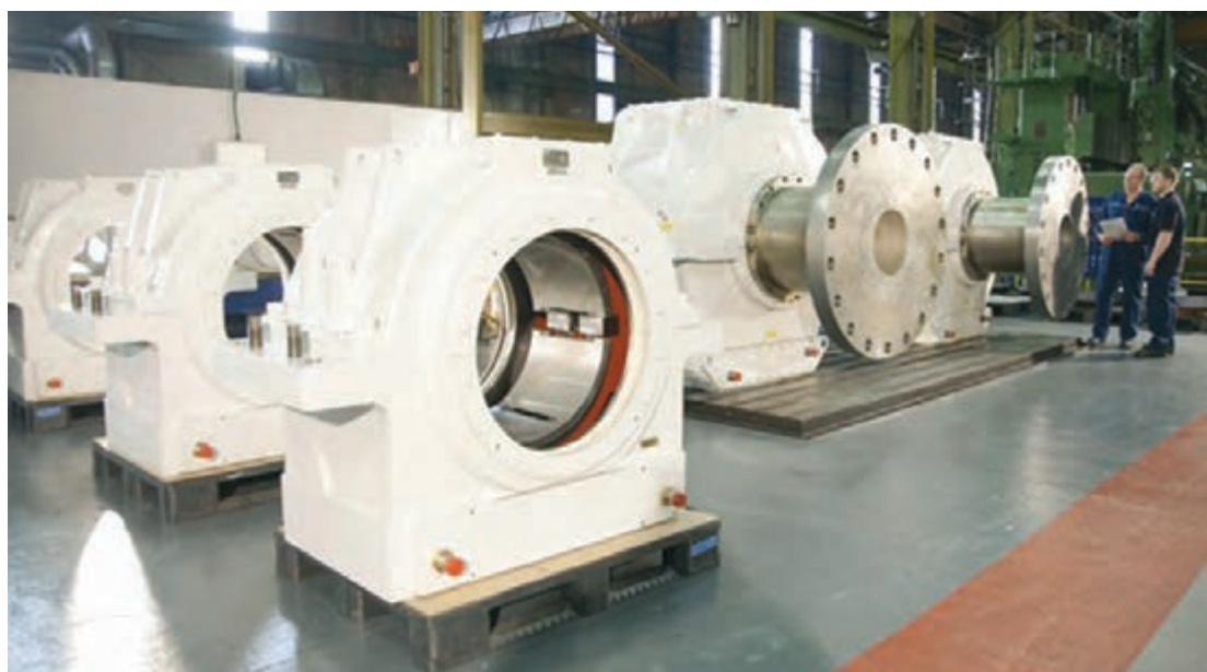
شکل ۲۴- یاتاقان‌های مورد استفاده جهت تکیه‌گاه محور پروانه
