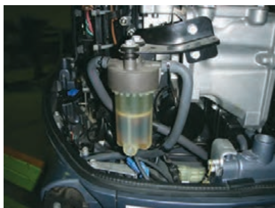
شکل ۴- پالایه اولیه سوخت
