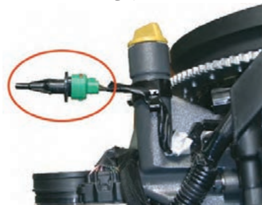
شکل ۱۸- حسگر دمای هوای ورودی
