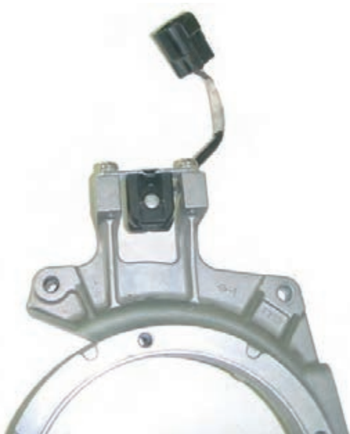
شکل ۱۶- حسگر موقعیت میل لنگ
