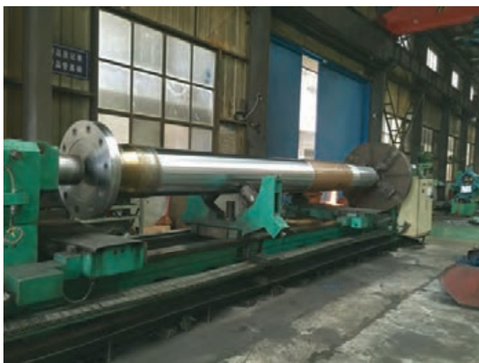
شکل ۹- محور پروانه در کارگاه جهت ماشین‌کاری
