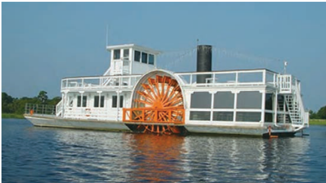
شکل ۱- سامانه پیشران چرخ پدالی
