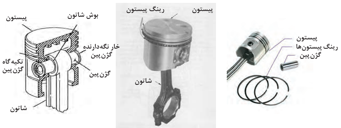
شکل ۲- پیستون و قطعات همراه آن
