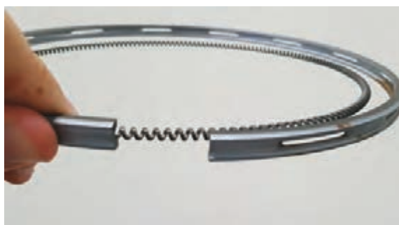
شکل ۱۴- رینگ پیستون
