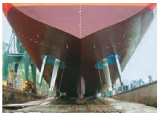
شکل ۲- سامانه پیش برنده وویس اشنايدر
