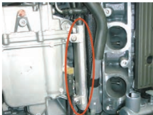
شکل ۱۱- کولر سوخت موتور
