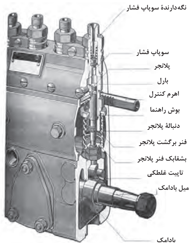
شکل ۳۱- پمپ انژکتور نوع جرک
