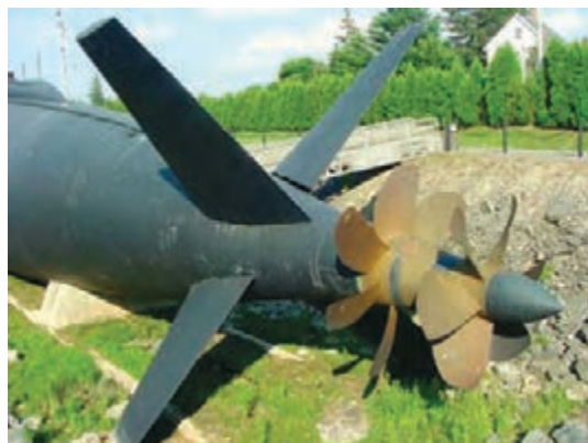
شکل ۸- پروانه های عکس چرخنده
