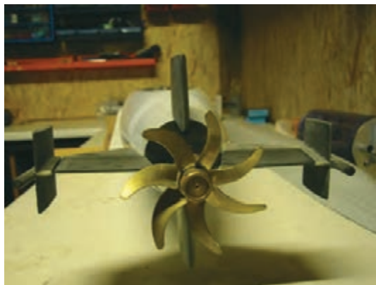
شکل ۶- پروانه گام ثابت
