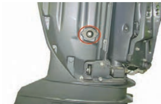
شکل ۲۹- پیچ تخلیه روغن
