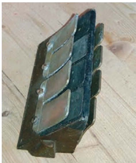
شکل ۴۴- سوپاپ‌های یک‌طرفه
