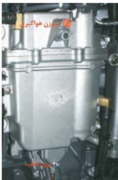
شکل ۷- مخزن تفکیک بخار
