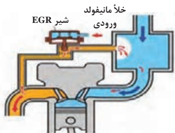
شکل ۱۹- مسیر عبور گازهای خروجی خلائی
