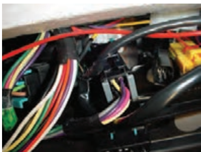
شکل ۵۰- بررسی چشمی اتصالات الکتریکی
