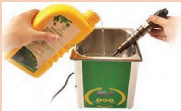
شکل ۷۸- تمیز کردن سوراخ انژکتور با دستگاه اولتراسونیک
