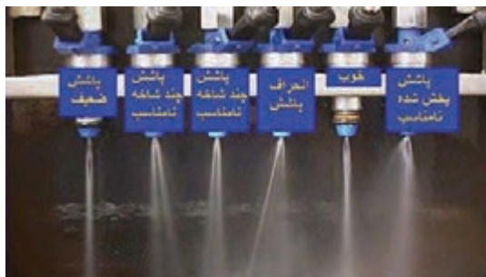
شکل ۷۷- انواع احتمالی پاشش سوخت در انژکتور
