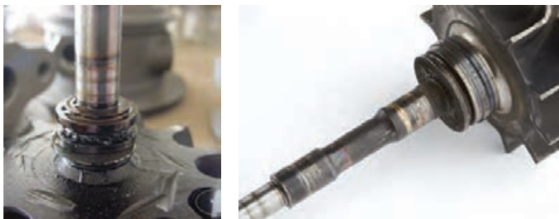
شکل ۸۵- خرابی یاتاقان‌ها و محور توربوشارژر
