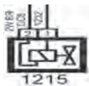
شکل ۵- نماد سوپاپ برقی کنیستر در نقشه‌ها
