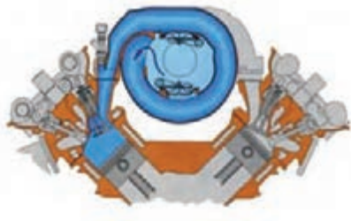
شکل ۴۱- عملکرد سیستم TUMBLE
