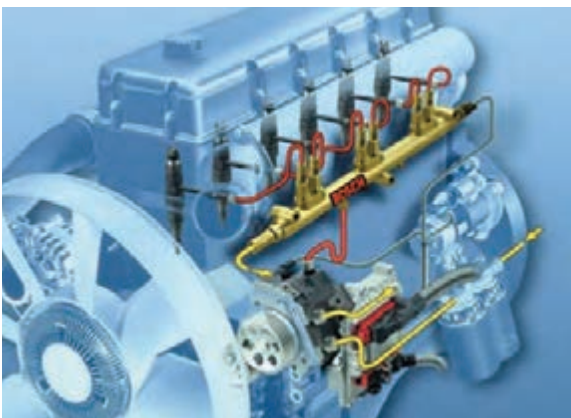
شکل ۶۴ - اجزای سیستم سوخت‌رسانی ریل مشترک
