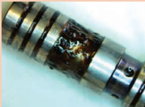
شکل ۷۶- خرابی انژکتور در اثر آب در سوخت
