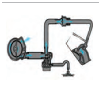
پمپ تزریق ثانویه اسماگ
