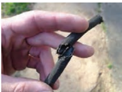
شکل ۴۹- یک نوع نشستی سیستم سوخت‌رسانی
