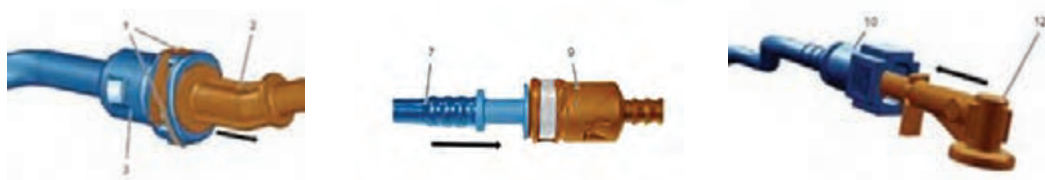
شکل ۷۳- نمونه‌ای از اتصالات سریع در مجموعه شیلنگ‌های سوخت
