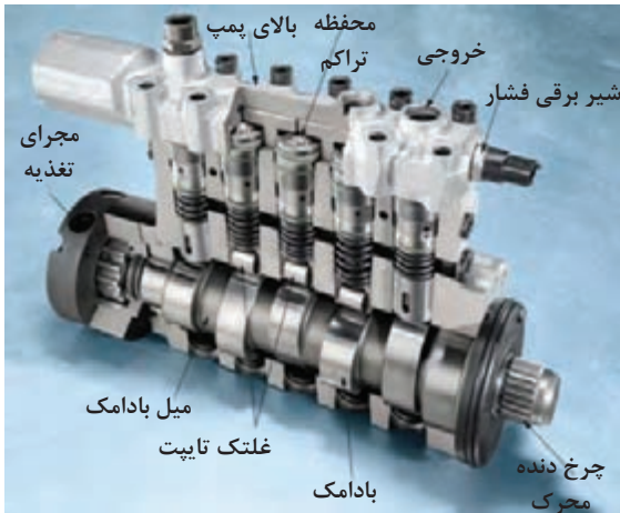
شکل ۲- یک نمونه پمپ انژکتور ردیفی
