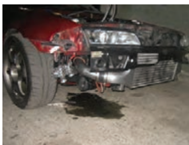
شکل ۴۹- یک نوع نشستی سیستم سوخت‌رسانی
