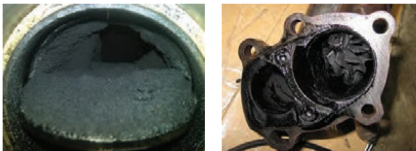
شکل ۸۴- رسوب کربن در ورودی و خروجی توربوشارژر
