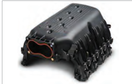
شکل ۳۷- دو نمونه مانیفولد متغیر هوای ورودی
