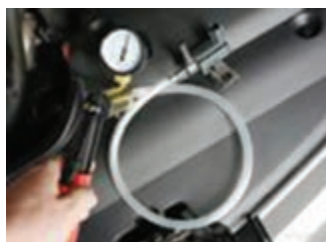
آزمایش میزان عبور هوا در حالت باز و بسته بودن شیر برقی کنیستر
