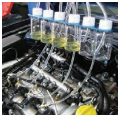
شکل ۵۵- تست اندازه‌گیری مقدار سوخت برگشتی انژکتورها
