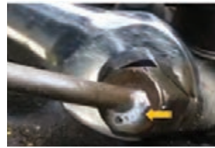
ادامه شکل ۶۰ - انواع مکانیزم‌های هواگیری در سیستم‌های سوخت‌رسانی دیزل
