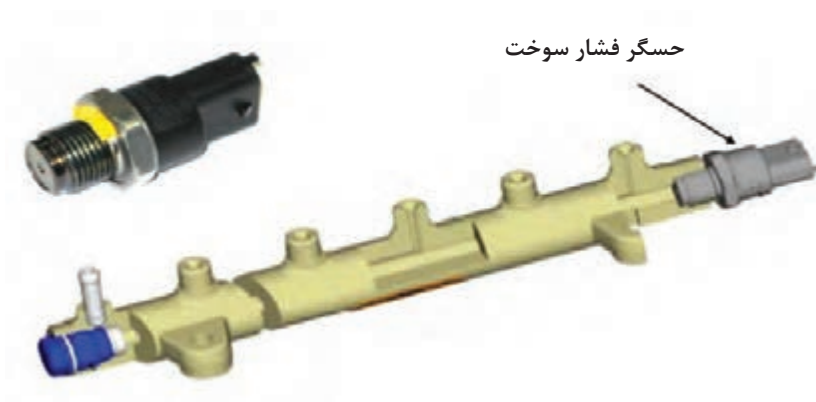
شکل ۳۵- حسگر مقدار فشار سوخت در سیستم تزریق ریل مشترک
