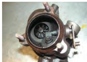
شکل ۸۳- نشستی روغن در توربوشارژر
