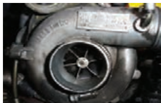
شکل ۸۳- نشستی روغن در توربوشارژر
