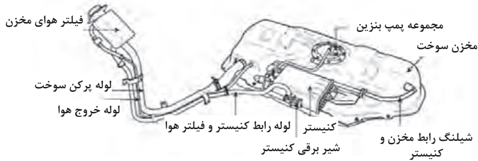
شکل ۳۶- مخزن سوخت و اجزای جانبی آن
