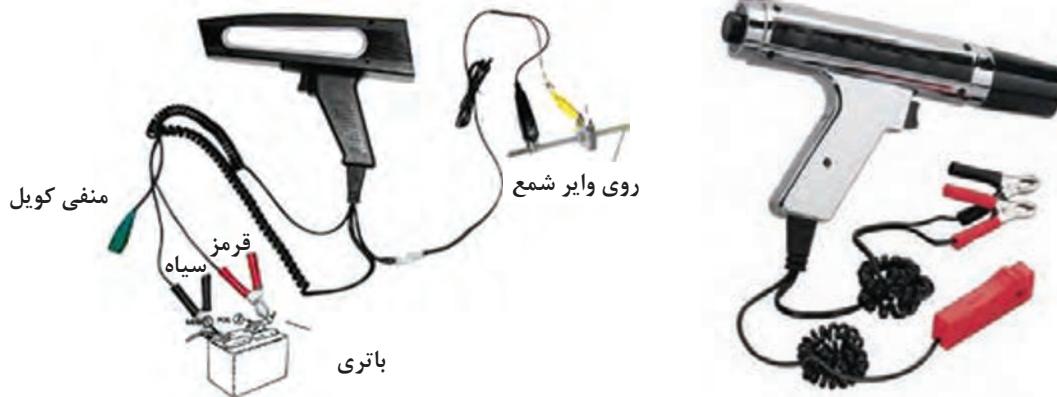
شکل ۲۰- نوعی چراغ تایمینگ و روش اتصال آن به سیم‌کشی خودرو
