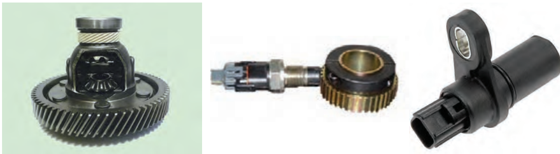
شکل ۵۸- حسگر و چرخ‌دنده بسته شده روی دیفرانسیل
