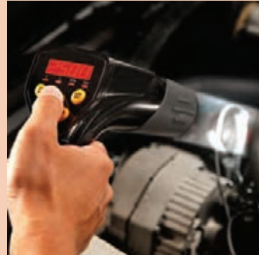
شکل ۲۱- روش کاربری چراغ تایمینگ
