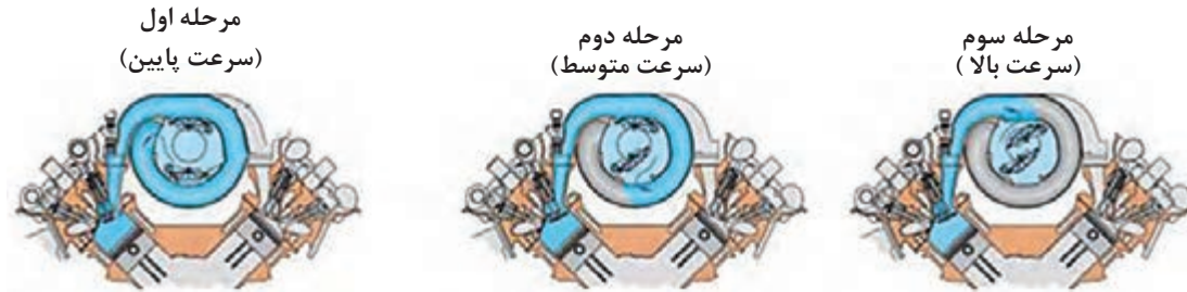
شکل ۴۲- عملکرد سیستم TUMBLE
