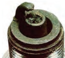
شکل ۳- آسیب به شمع بر اثر خودسوزی
