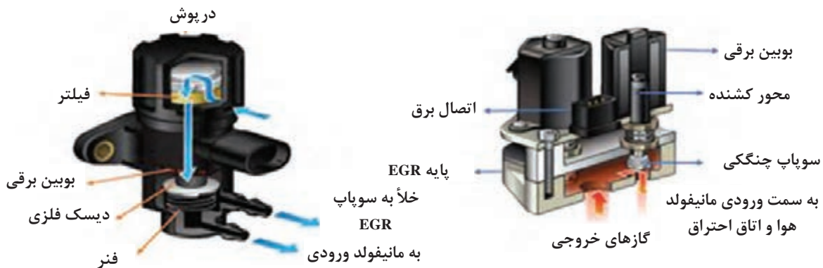
شکل ۱۶- شیر برقی EGR مدل بیرونی و داخلی
