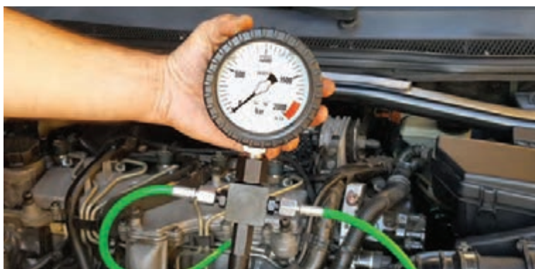
شکل ۵۶- بررسی فشار مدار سوخت‌رسانی دیزل به وسیله ابزار اندازه‌گیری
