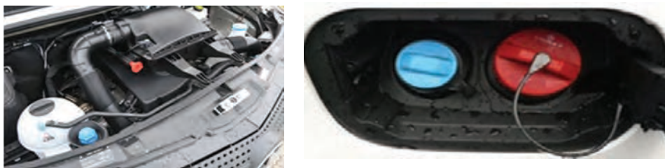
شکل ۹۲- محل‌های قرارگیری در مخزن مایع آگزوز دیزل
