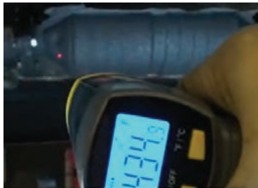
شکل ۹۵- اندازه‌گیری دمای کاتالیست در ابتدا و انتها بعد از اینکه موتور به دمای نرمال برسد جهت صحت عملکرد با دستگاه حرارت سنج لیزری
