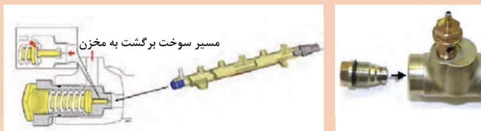
شکل ۳۶- سوپاپ کنترل فشار مکانیکی در تزریق ریل مشترک
