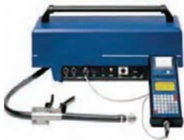
شکل ۵۹- دستگاه تست کدري دود خودروهای ديزلی
