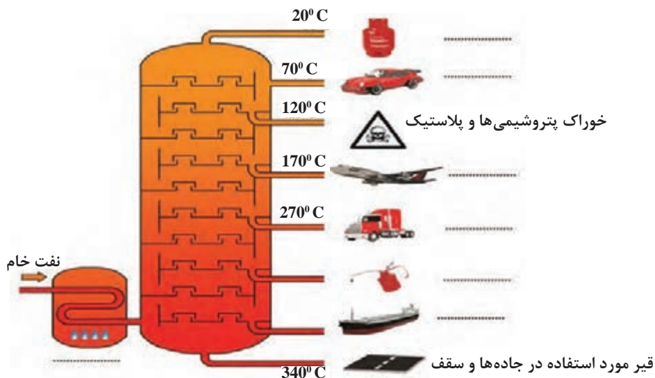
شکل ۵- نمای ساده‌ای از برج تقطیر در پالایشگاه
