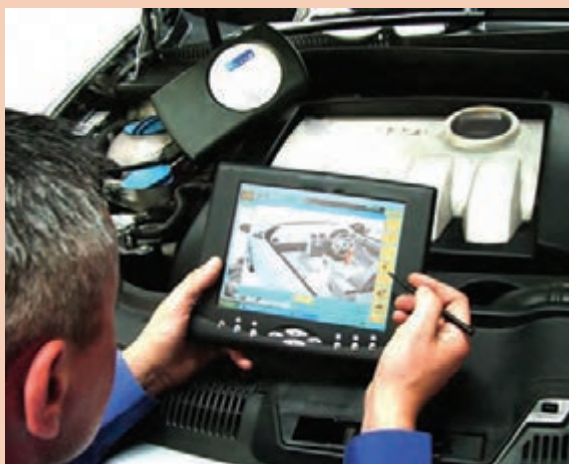
شکل ۷۵- نصب انژکتور الکترومکانیکی جدید توسط دستگاه عیب‌یاب
