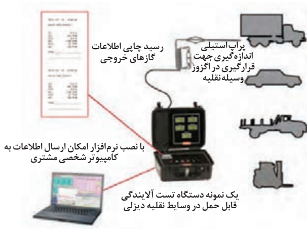
شکل ۷۹- یک نمونه دستگاه تست آلاینده‌ها در وسایط نقلیه دیزلی
