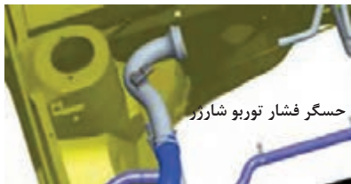
شکل ۳۲- موقعیت حسگر فشار توربو شارژر
