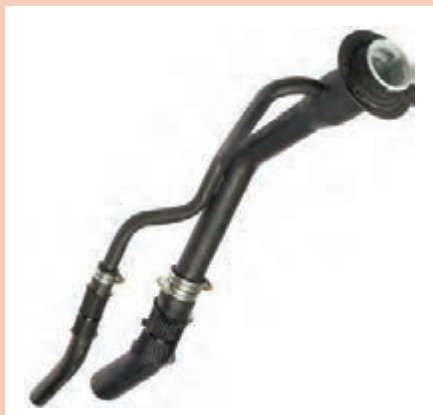
شکل ۳۷- لوله فلزی ورودی و مجرای کناری
