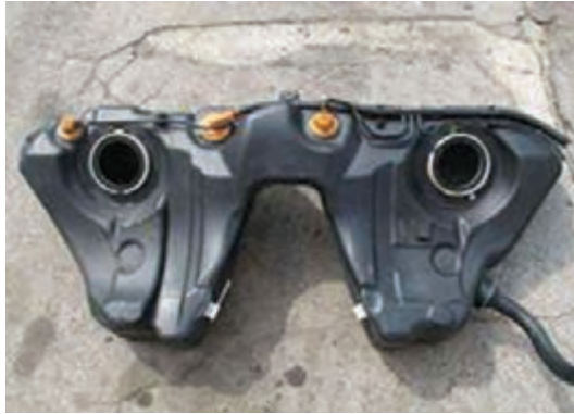
شکل ۷- مخزن سوخت با سوپاپ واژگونی
