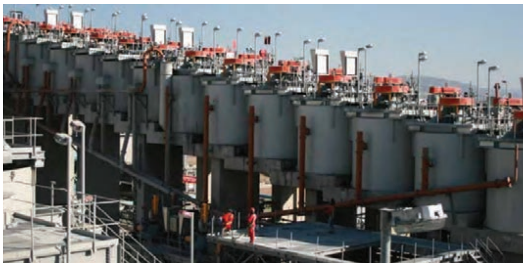
شکل ۵- تصویر واقعی از یک بانک فلوتاسیون
