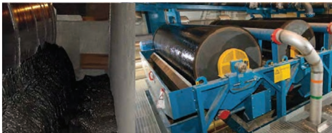
شکل ۳۰- جدا کننده های مغناطیسی استوانه ای تر
