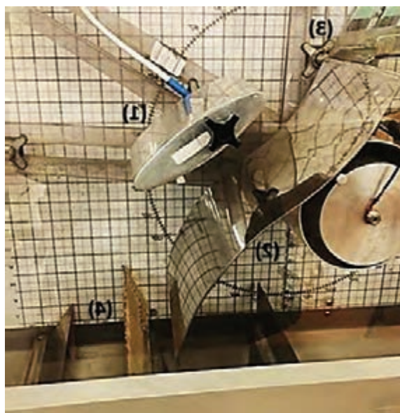
شکل ۳۸- دستگاه جدا کننده الکترواستاتیکی صفحه ای
