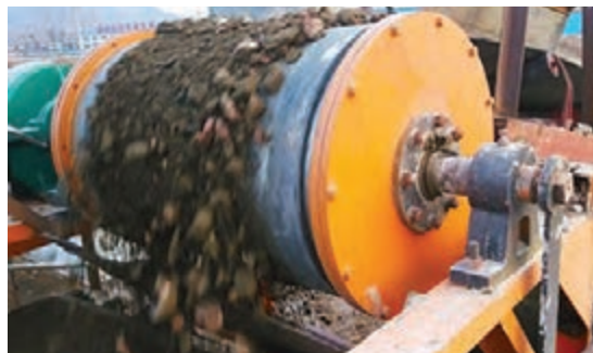
شکل ۲۴- غلتک مغناطیسی
