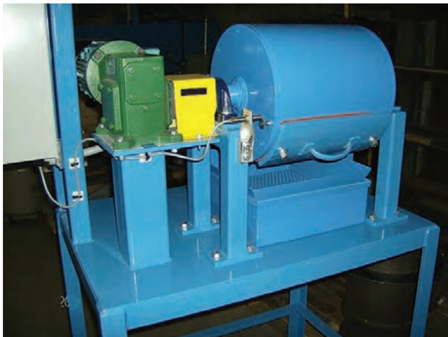
شکل ۲- آسیای گلوله ای آزمایشگاهی باند
