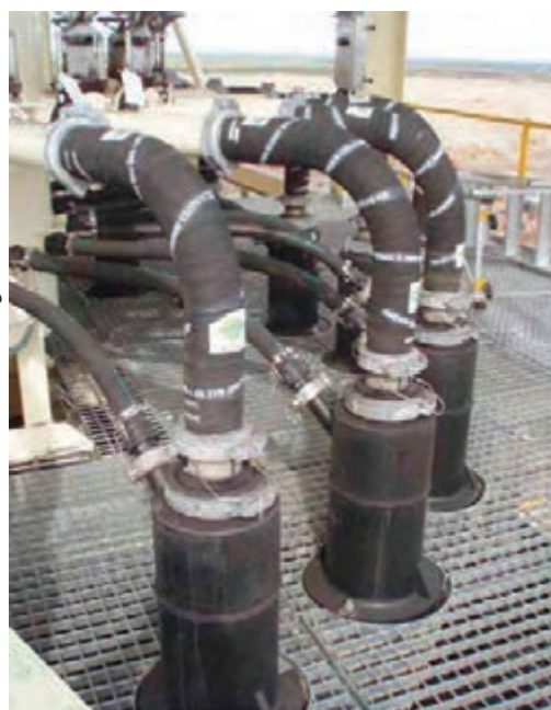
شکل ۲۲- جت‌های تزریق پالپ در سلول فلوتاسیون جیمسون
