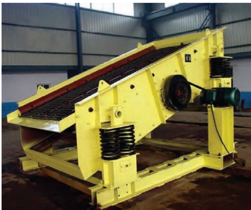
شکل ۵- سرندهای با حرکت نوسانی
