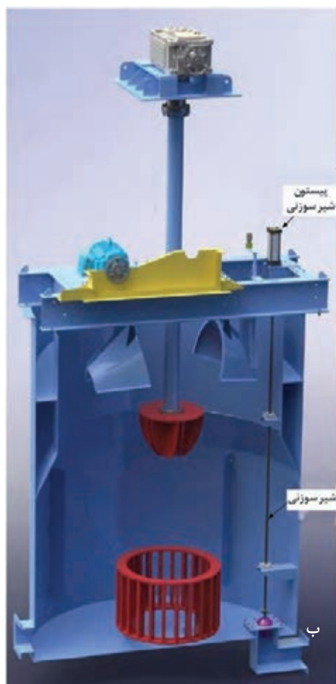
شکل ۴۱- الف) تجهیزات اندازه‌گیری عمق کف در سطح سلول فلوتاسیون، ب) شیر تخلیه سوزنی و پیستون آن
