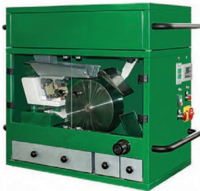
شکل ۴۱- دستگاه جدا کننده تخلیه کرونا
