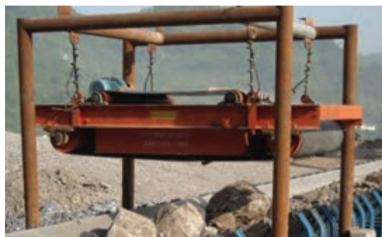
شکل ۲۶- جدا کننده های مغناطیسی معلق نوار متقاطع
