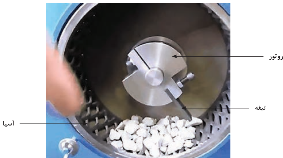
شکل ۳- نمای داخلی آسیای استاندارد ساینده‌گی باند
