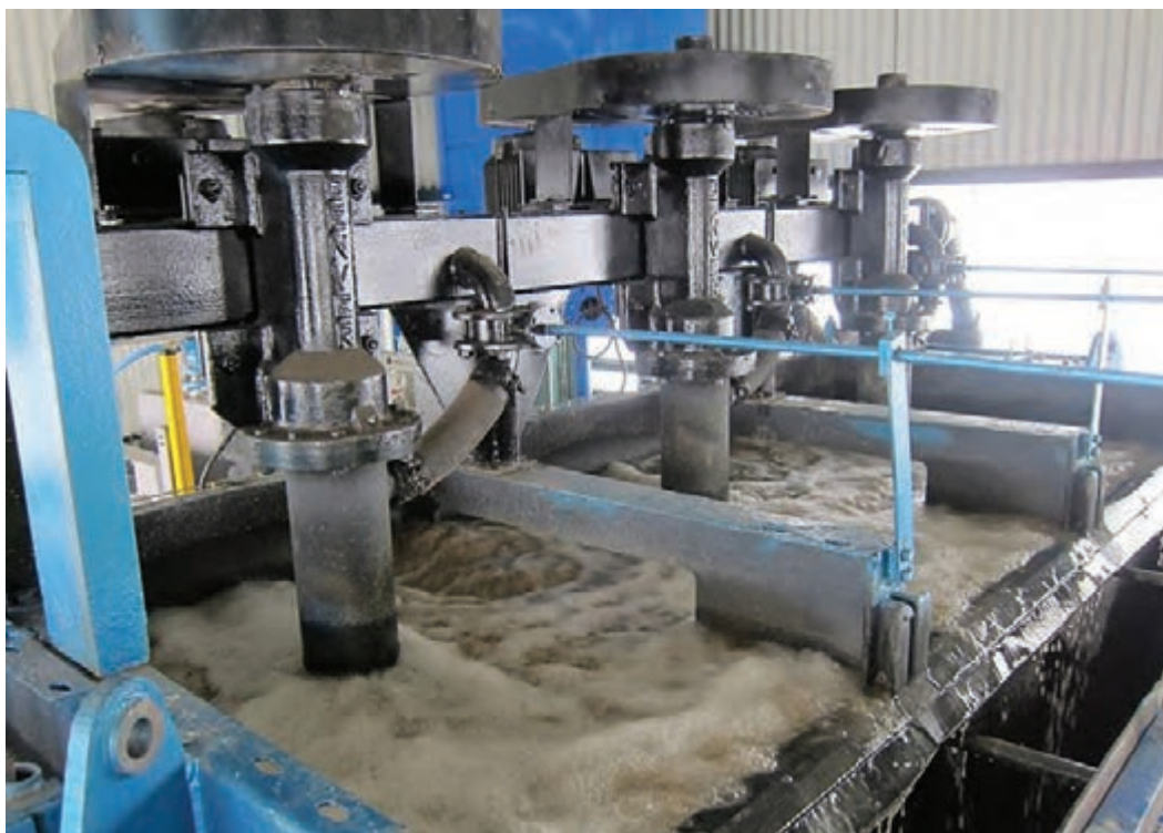
شکل ۱۲- ماشین فلوتاسیون دنور مدل دی- آر
