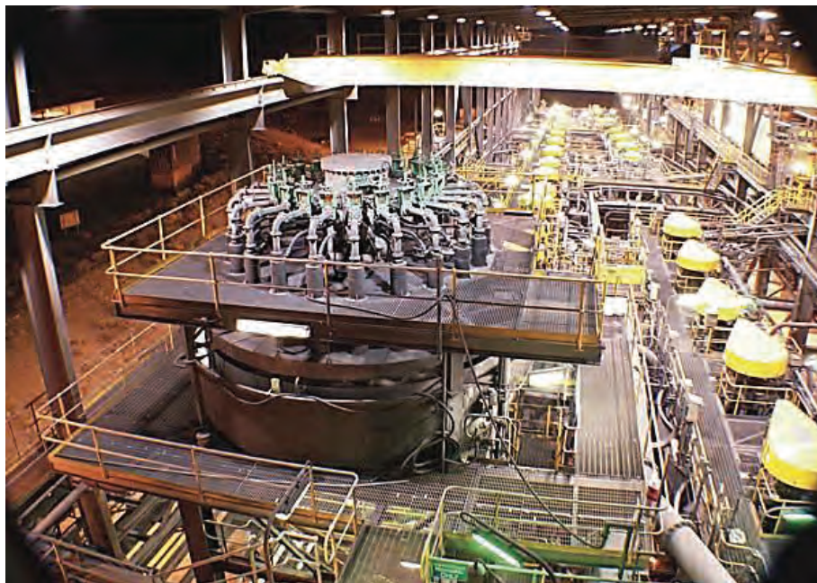
شکل ۲۳- یک ماشین فلوتاسیون جیمسون در کارخانه فراوری
