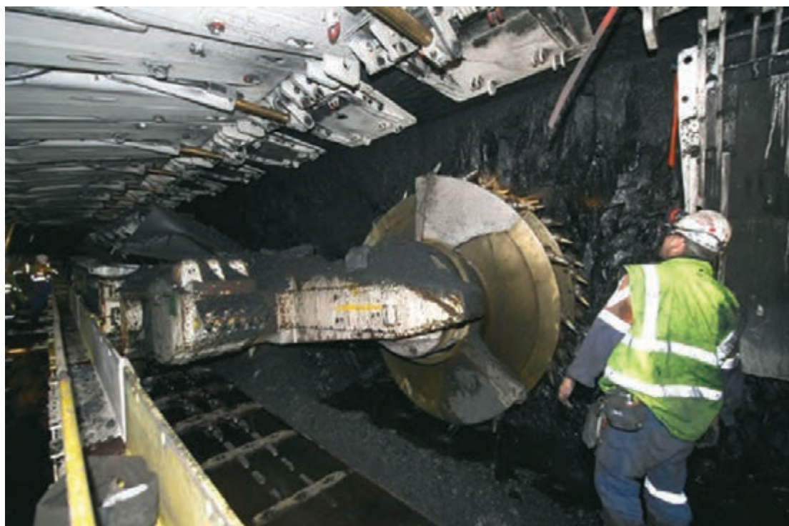
ماشین شیر، ناو زنجیری، جک‌های هیدرولیکی متحرک در استخراج به روش جبهه کار طولانی مکانیزه
