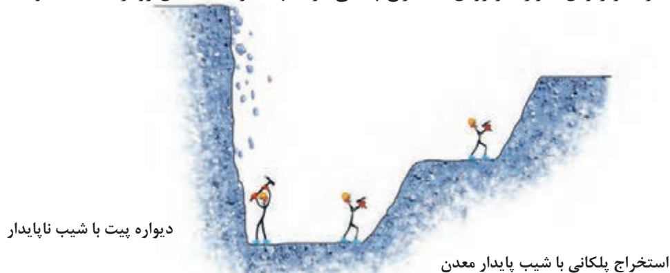
استفاده از روش استخراج پله‌ای و با رعایت شیب استاندارد جهت پیشگیری از ریزش دیواره
