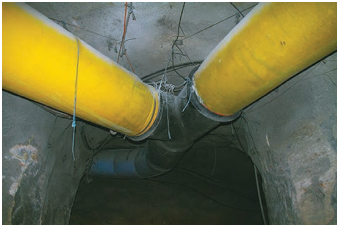
کانال‌های فلزی و برزنتی انتقال هوای معدن
