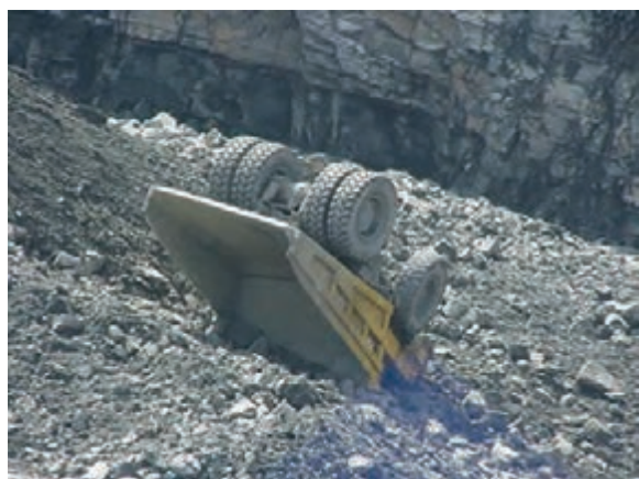
سقوط یک دامپتراک به دلیل عدم وجود دیواره اطمینان
