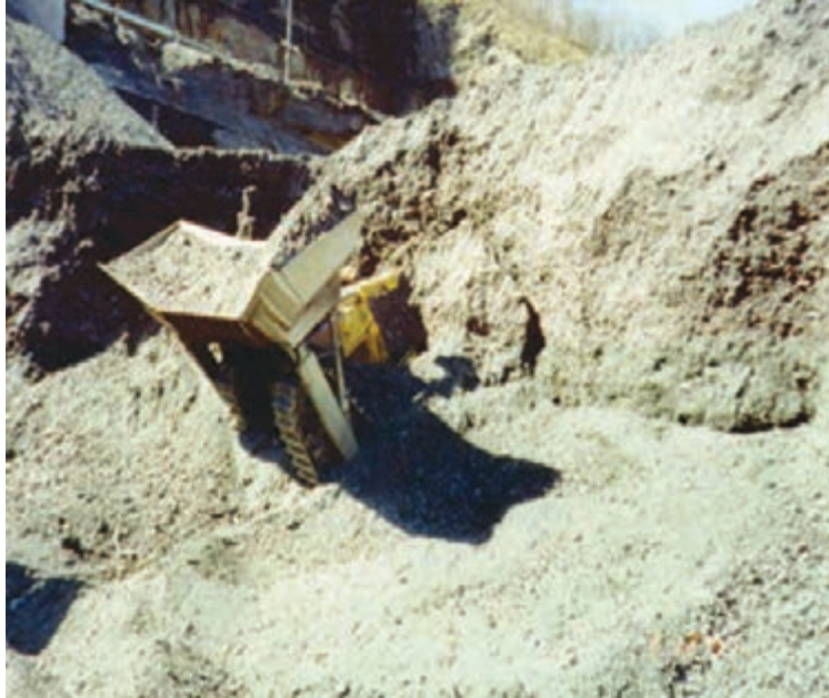
ریزش خاک‌های نرم بر روی ماشین معدنی
