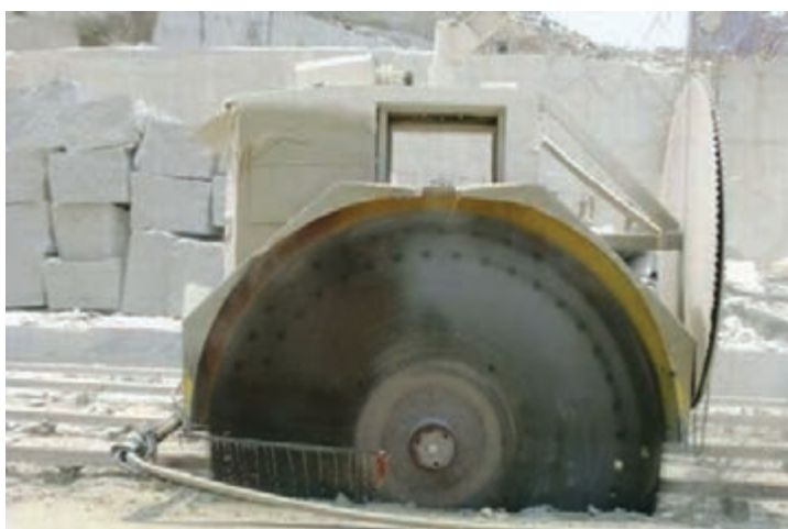
دستگاه دیسک برنده در حال برش سنگ
