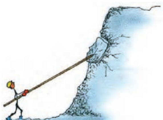
لق‌گیری با چوب بلند و از پایین
