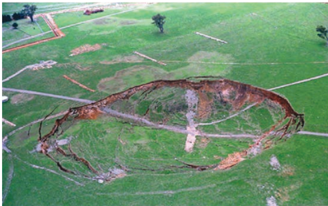
تخریب ایجاد شده در سطح زمین در اثر استخراج به روش تخریب در طبقات فرعی
