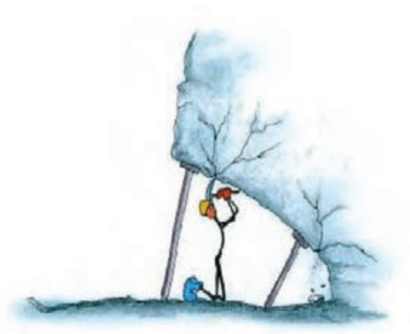
ایجاد زیر برش با نصب وسیله نگهدارنده
