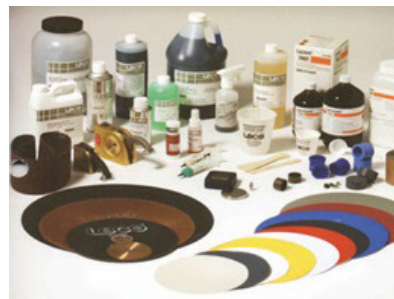
شکل ۱۴- انواع کاغذهای سنبناده و مواد مانت سرد و گرم مورد استفاده در متالوگرافی
