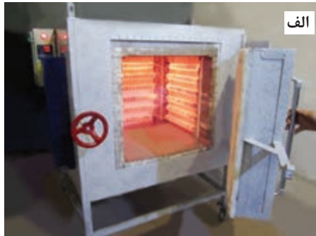
شکل ۲- انواع کوره‌های الکتریکی، الف) بدون فن، ب) فن دار
