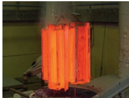
شکل ۳۰- کربوره کردن مایع در حمام نمک
