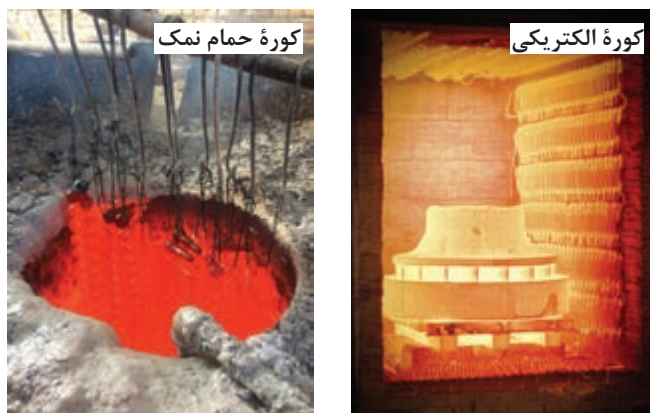
شکل ۲۱- هم‌دما کردن قطعات در کوره‌ها
