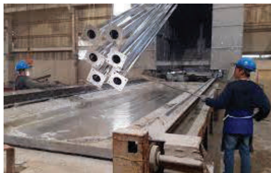
شکل ۱۳- پوشش دهی فلزات به روش غوطه‌وری داخل روی مذاب.
