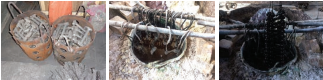
شکل ۲۶- تمپر کردن قطعات
