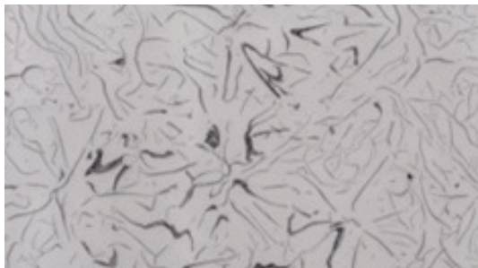
شکل ۳۳- ساختار چدن هیپویوتکتیک (فریت به همراه گرافیت لایه‌ای)
