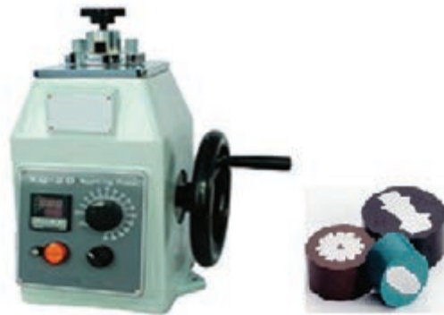
شکل ۱۳- دستگاه مانت گرم و نمونه‌های مانت شده
