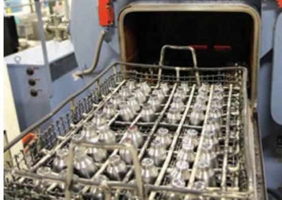
شکل ۱۶- قرارگیری سبد حاوی قطعات جلوی در کوره
