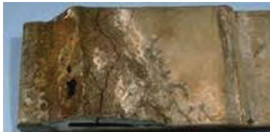
شکل ۱۰- (الف) پیچ در محلول خورنده حاوی ذرات ساینده دچار خوردگی فرسایشی شده است. (ب) پره پمپ به دلیل قرار گرفتن در محلول خورنده حاوی ذرات ماسه دچار خوردگی فرسایشی شده است. (ج) لوله فولادی که در اثر وجود سیال داخل آن دچار خوردگی فرسایشی شده است.
