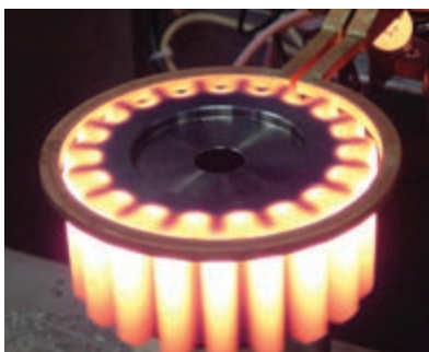
شکل ۳۳- سخت کردن چرخ دنده به روش القا
