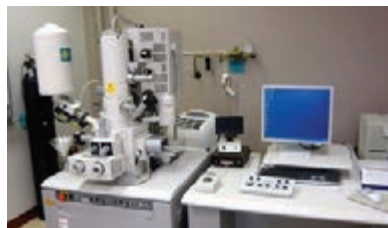
شکل ۸- میکروسکوپ‌های الکترونی با قدرت بزرگ‌نمایی بالا جهت بررسی ساختار درونی فلزات و آلیاژها
