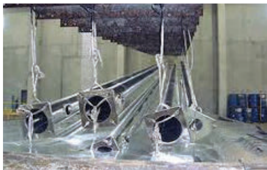
شکل ۱۳- پوشش دهی فلزات به روش غوطه‌وری داخل روی مذاب.
