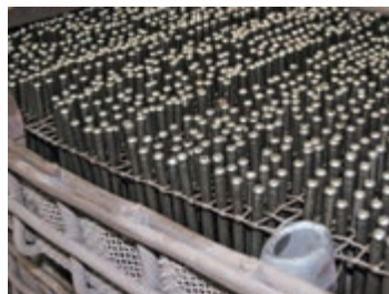
شکل ۱۵- انواع چیدمان قطعات در سبدها و روی صفحه فولادی
