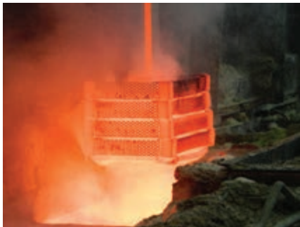
شکل ۳۰- کربوره کردن مایع در حمام نمک
