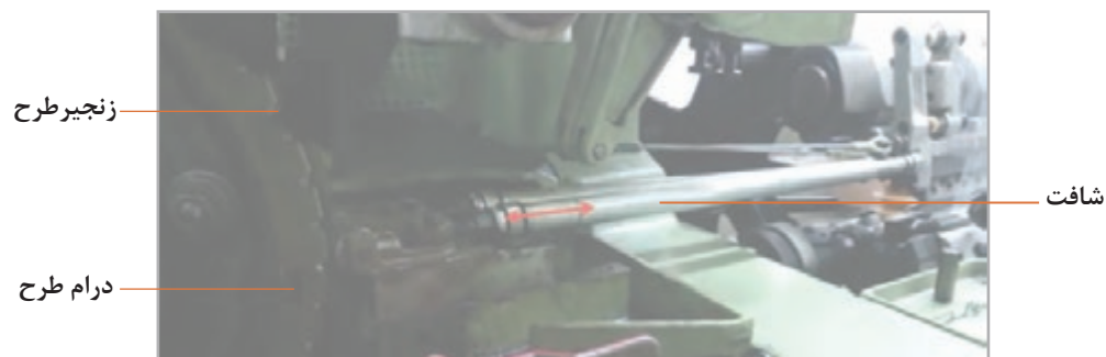
شکل ۵۰- درام طرح و شافت رابط
