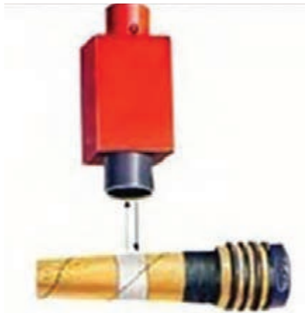
شکل ۸- مکانیزم فتوالکتریکی حس کننده ماسوره خالی
