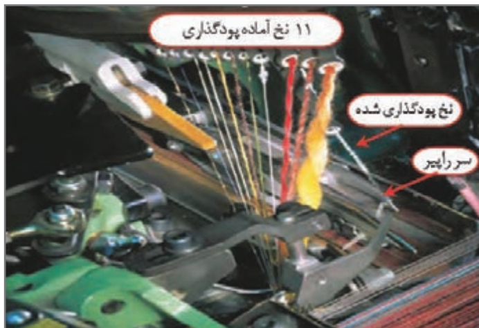
شکل ۲۰- سیستم تغییر پود در پودگذاری راپیری
