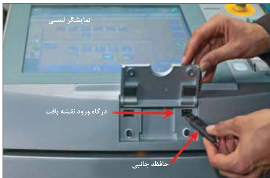
شکل ۳۵- نحوه اتصال حافظه جانبی به ماشین بافندگی
