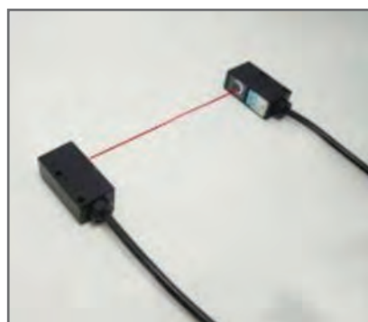
شکل ۲۴- مکانیزم کنترل پارگی نخ تار با استفاده از پرتو نور لیزر
