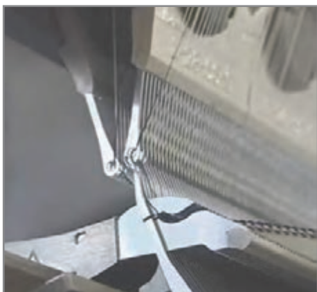
شکل ۳۹- حرکت سوزن از بین شانه‌ها
