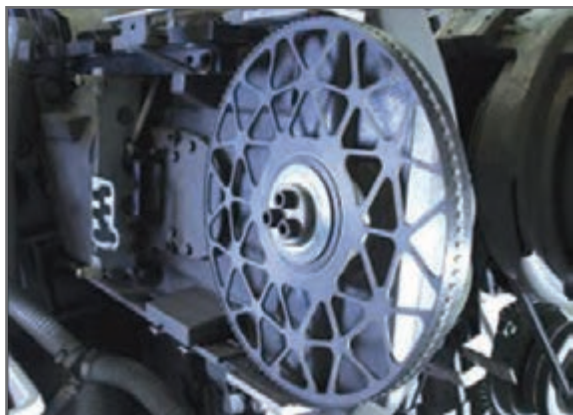
شکل ۱۹- غلتک دوران کننده و محرک راپیر
