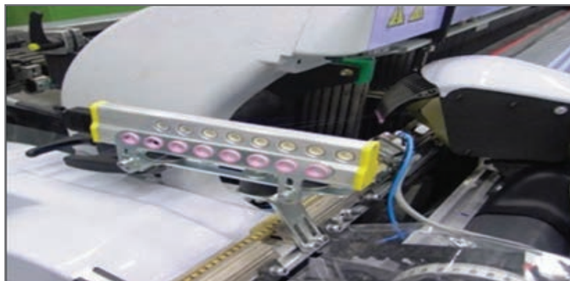
شکل ۲۹- مکانیزم کنترل نخ پود پیزوالکتریک
