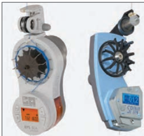
شکل ۲۹- تغذیه کننده الکتریکی نخ
