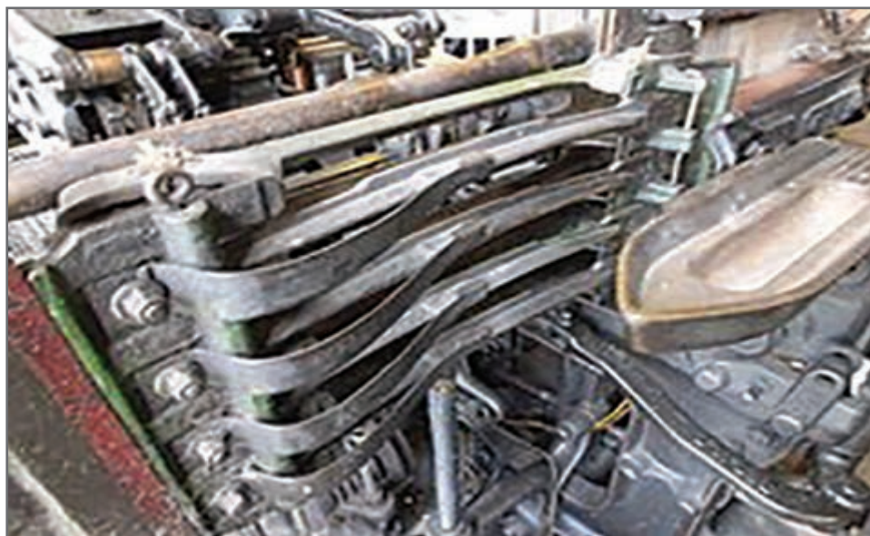
شکل ۹- چهار جعبه ماکو در یک ماشین بافندگی
