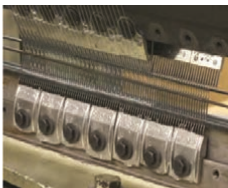
شکل ۳۱ - نصب بلوک سوزن‌ها با پیچ روی صفحه
