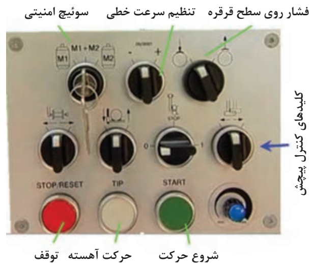
شکل ۱۲ - کلیدهای راه‌اندازی یک دستگاه پیچش قرقره
