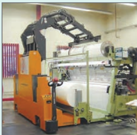
شکل ۱۹ - نحوه انتقال نورد حاوی قرقه‌ها روی ماشین
