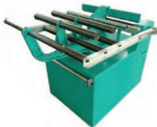
شکل ۹ - دستگاه ذخیره دسته نخ تار
