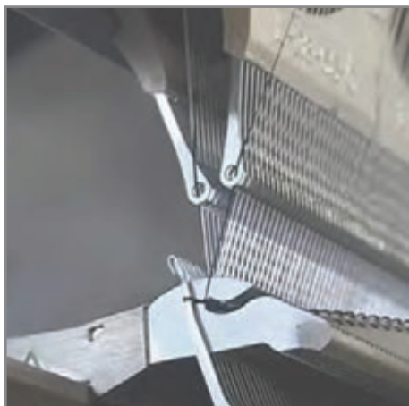
شکل ۳۷- مرحله ۱ قرارگرفتن حلقه روی ساقه سوزن
