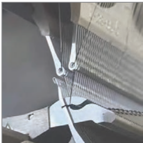
شکل ۳۸- مرحله آندرلپ حرکت شانه پشت سوزن
