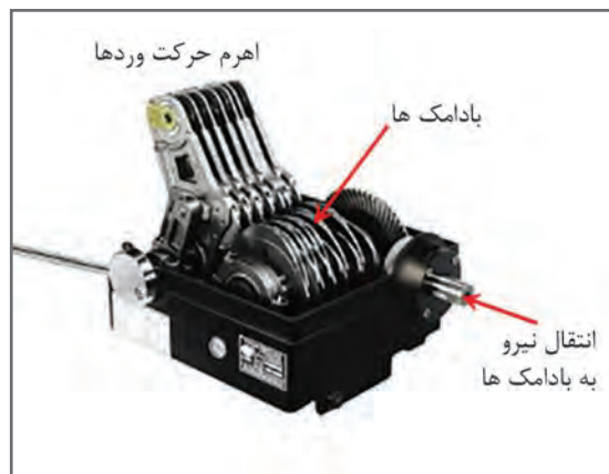
شکل ۱۱- مکانیزم بادامک خارجی
