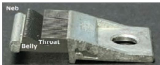
شکل ۳۲ - قالب یک اینچی سینکر
