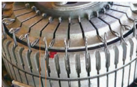
سوزن‌های روی صفحه سوزن‌های روی سیلندر
