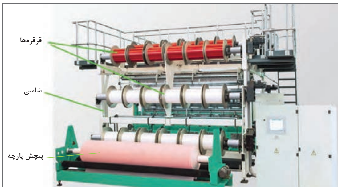
شکل ۱۸ - ماشین تریکو ۴ نوردی (۴ شانه)
