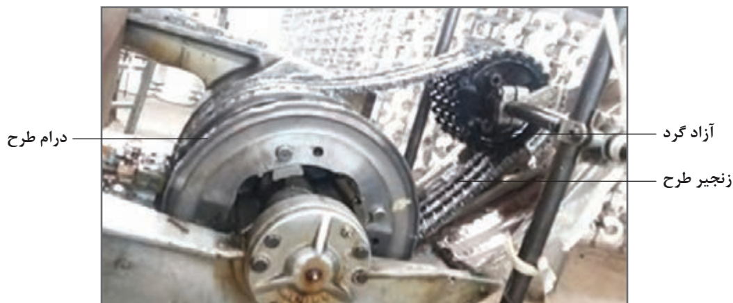
شکل ۴۹- درام طرح و چرخ زنجیر آزادگرد
