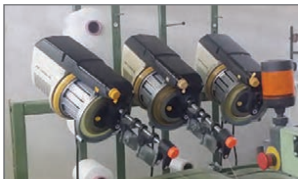
شکل ۲۷- سیستم رزرو نخ پود
