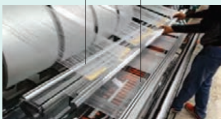
شکل ۲۳- قرار دادن لایه نخ‌های تار قرقره روی شاسی ماشین گره زن
