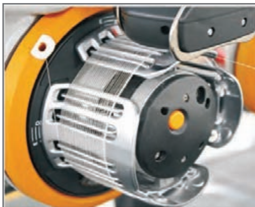
شکل ۲۸- یک مکانیزم ذخیره نخ پود استوانه‌ای
