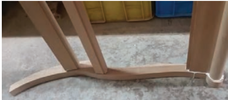
شکل ۴۸- جا زدن پشتی مبل
