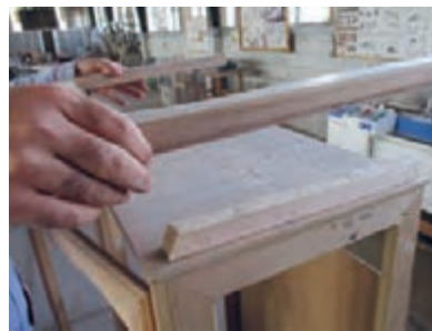
شکل ۸۱- نصب تاج به بدنه
