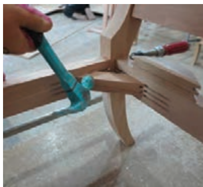
شکل ۵۸- جا زدن نبشی‌های گوشه
