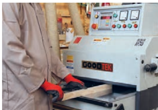
شکل ۷۸- نحوه گندگی کردن چوب‌های کم عرض
