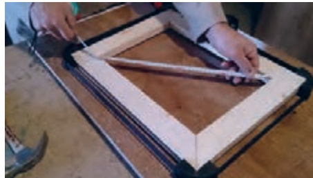
شکل ۲۵- کنترل دوئیدگی و صحیح بودن قاب
