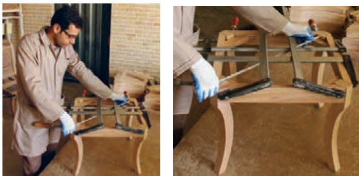
شکل ۶۹- کنترل دوئی‌گی با متر
