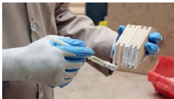
شکل ۱۰۸- چسب زدن نبشی‌ها
