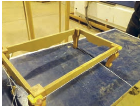
شکل ۷۱- مونتاژ به وسیله گیره کمربندی
