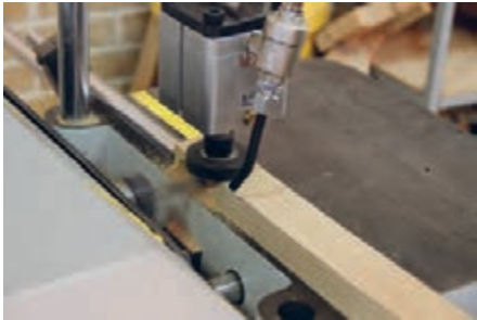
شکل ۵۵- دستگاه کام کن نیمه اتوماتیک
