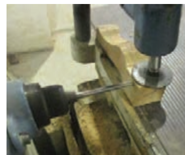
شکل ۶۵- عملیات اتصال دوبل با دستگاه کم کن
