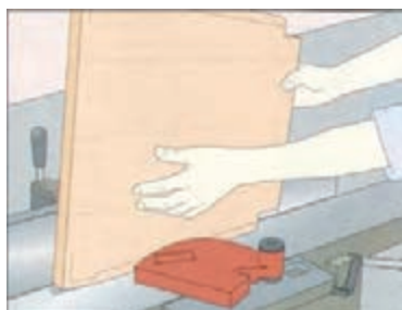
پرداخت کردن کفی با دستگاه کفرند
