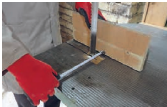
شکل ۷۴- اندازه‌گیری فاصله تیغه با گونیا
