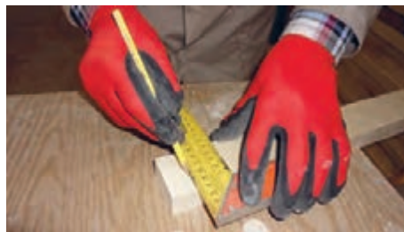
شکل ۸۷- علامت زدن قطعات مختلف برای انجام اتصال
