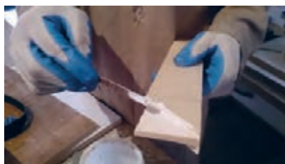
شکل ۲۳- چسب زدن اتصالات قاب
