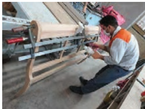
شکل ۵۲- تمیز کردن چسب اضافی روی قطعه کار
