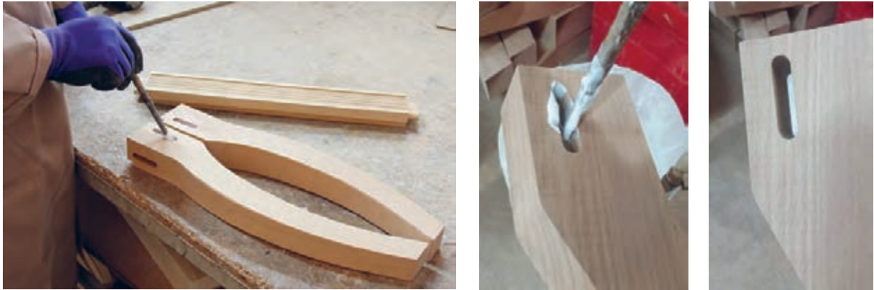
شکل ۶۴- چسب زدن کام پایه‌ها
