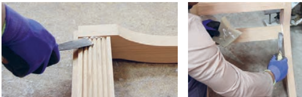
شکل ۶۷- تمیز کردن چسب اضافی با کاردک
