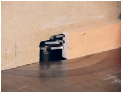
شکل ۶۱- تیغ فرز مخصوص زهوار صفحه
