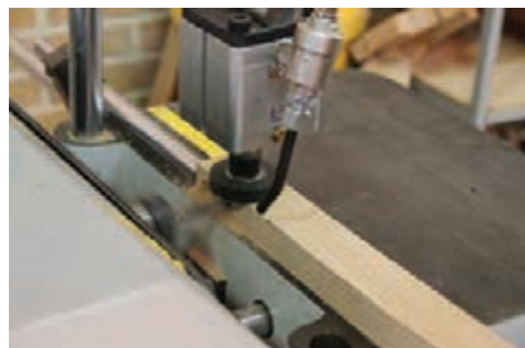
شکل ۴۰- اتصال کام با دستگاه کام کن نیمه‌اتوماتیک
