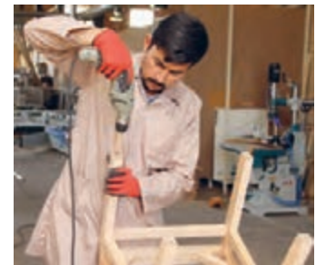
شکل ۱۱۲- سوراخکاری کف پایه با دریل
