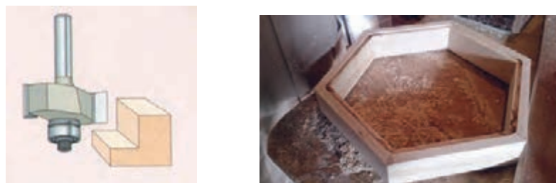
شکل ۴۰- دوراها زدن کف قاب شش ضلعی
