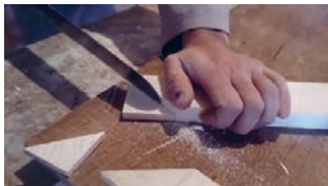
شکل ۱۶- عملیات برشکاری اتصال نیم و نیم رو فارسی
