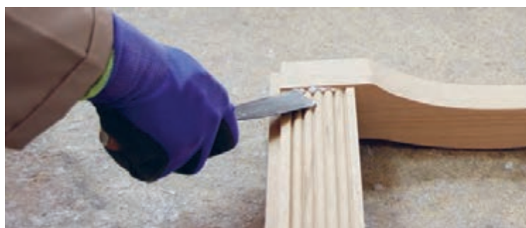
شکل ۱۰۲- تمیز کردن چسب اضافی با کاردک
