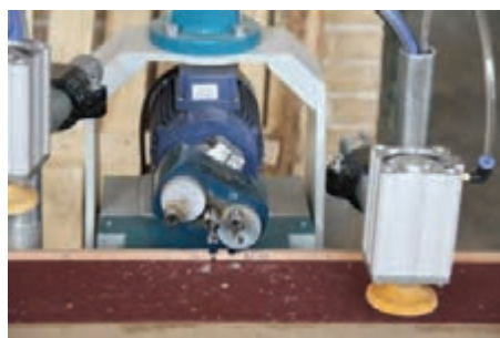
شکل ۳۸- ایجاد اتصال با دستگاه دوبل زن نیمه‌اتوماتیک
