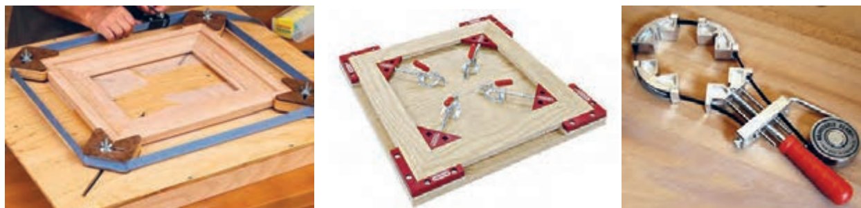
شکل ۷۲- گیره مخصوص بستن قاب
