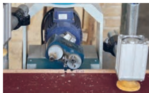
شکل ۵۶- دستگاه دوبل زن
