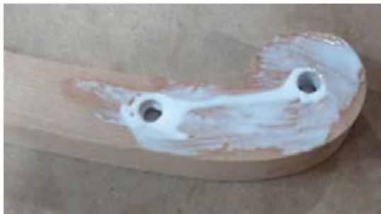
شکل ۴۶- روش چسب زدن اتصال دوبل پایه‌های عقب
