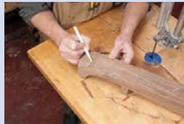
شکل ۴۷- خط‌کشی دوباره روی چوب
