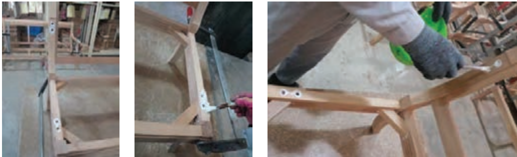
شکل ۵۹- چسب زدن محل اتصالات دسته مبل
