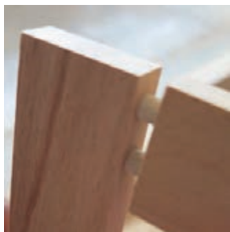
شکل ۱۱- اتصال دوبل (میخ چوبی)
