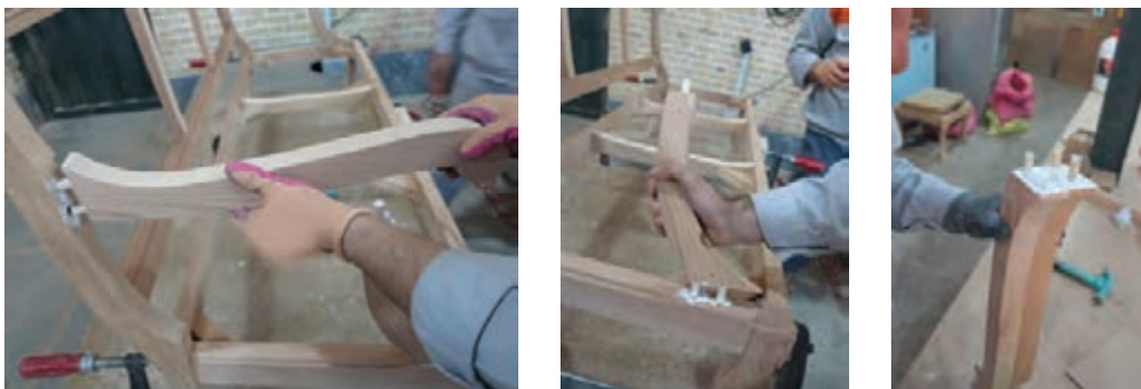
شکل ۶۰- جا زدن دسته مبل در محل اتصالات
