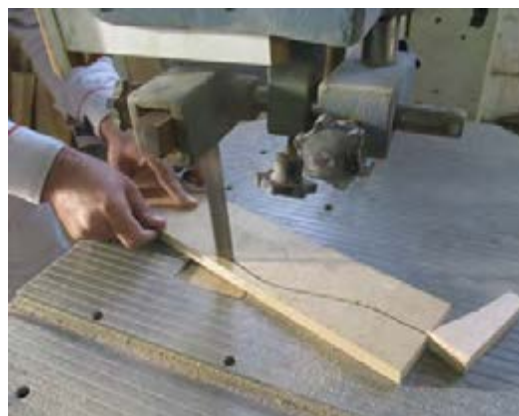
شکل ۶۲- عملیات قوس‌بری با دستگاه اره نواری
