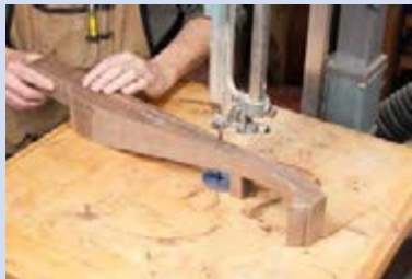
شکل ۴۹- قوس‌بری چوب: مرحله دوم
