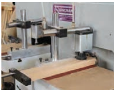
شکل ۴۲- ساخت زبانه با دستگاه زبانه‌زن نیمه اتوماتیک
