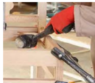
شکل ۱۰۷- جا زدن نبشی به وسیله چکش لاستیکی
