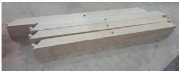
شکل ۶۲- قطعات آماده برای مونتاژ میز عسلی
