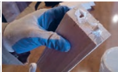
شکل ۳۵- چسب زدن اتصال دوپل
