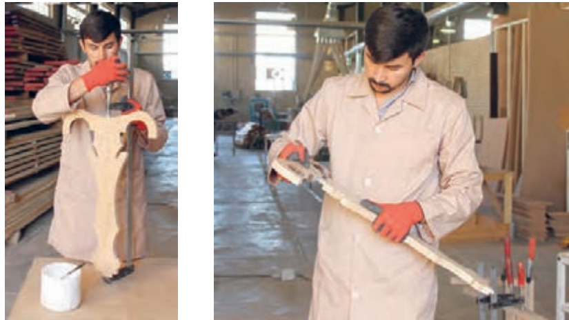
شکل ۱۰۴- کنترل صحیح بودن اتصالات و مونتاژ تاج و پشتی
