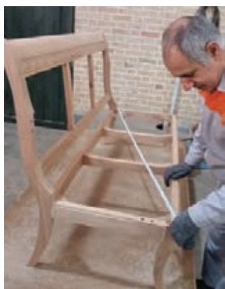
شکل ۵۷- کنترل دوئیدگی (گونیا)ی کردن کار) با متر
