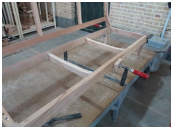
شکل ۵۶- جا زدن اتصالات با گیره دستی
