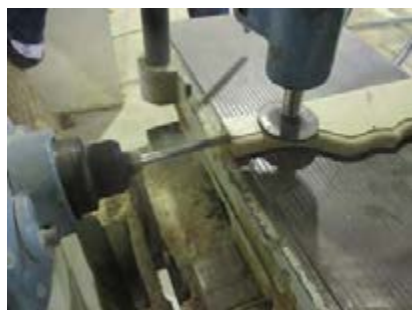
شکل ۶۵- عملیات اتصال دوبل با دستگاه کم کن
