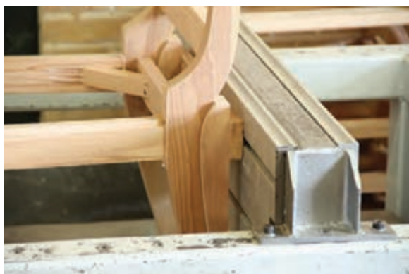
شکل ۵۵- جا زدن اتصالات با تنگ پنوماتیکی
