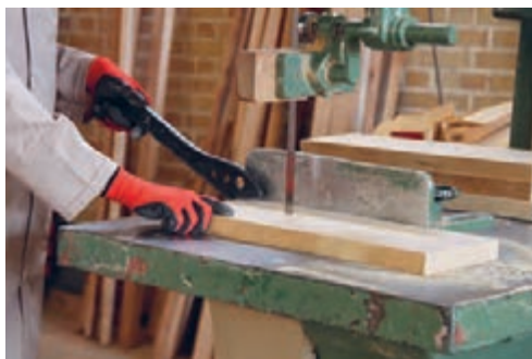
شکل ۴۰- وضعیت برش چوب قیدها
