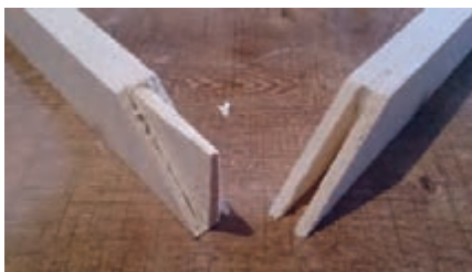
شکل ۲۰- برشکاری اتصال دو رو فارسی
