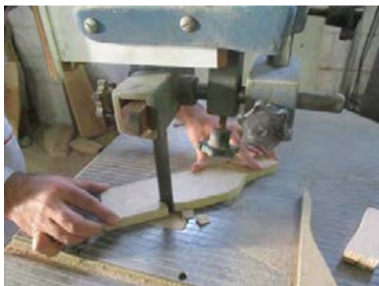
شکل ۶۲- عملیات قوس‌بری با دستگاه اره نواری
