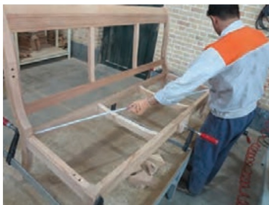
شکل ۵۷- کنترل دوئیدگی (گونیا)ی کردن کار) با متر
