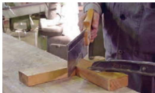
شکل ۲۱- چگونگی اَره‌کشی درز بین اتصال
