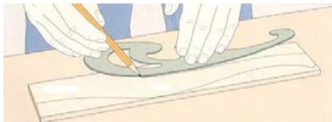
شکل ۴۲- آماده کردن الگوی پایه به وسیله پیستوله
