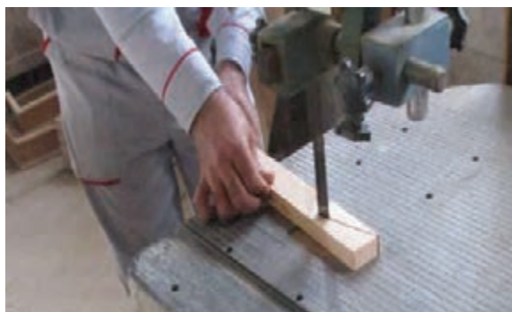
شکل ۶۳- پایان قوس بری با دستگاه اره نواری
