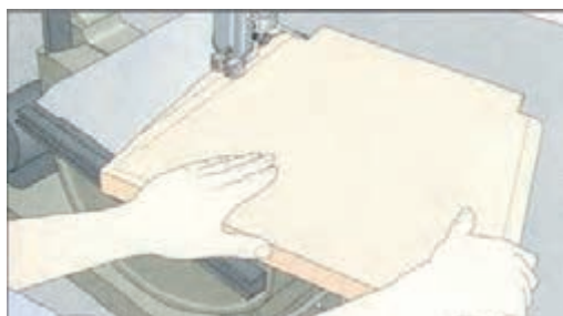
بریدن کفی توسط دستگاه اره نواری
