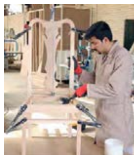
شکل ۱۰۷- جا زدن نبشی به وسیله چکش لاستیکی
