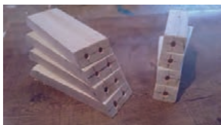
شکل ۳۳- سوراخ کردن قیدها تحت زاویه
