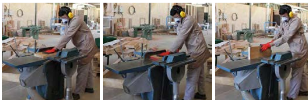
شکل ۷۰- یک رو و یک نرکردن چوب
