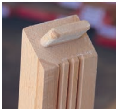
شکل ۵۹- اتصال کام تحت زاویه ۴۵ درجه
