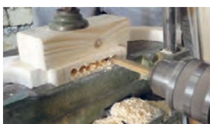
شکل ۸۸- عملیات کم کنی با دستگاه سه کاره
