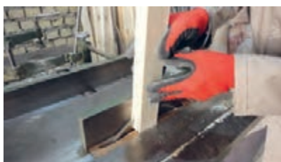
شکل ۹۱- عملیات برش زبانه با دستگاه اره گرد
