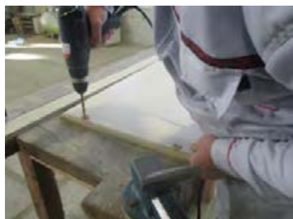
شکل ۶۶- عملیات اتصال دوبل به وسیله دریل دستی
