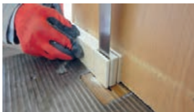
شکل ۹۰- عملیات برش زبانه با دستگاه اره نواری
