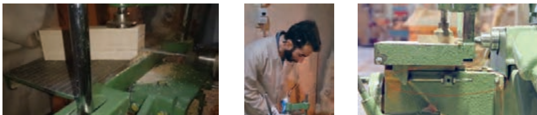
شکل ۳۲- عملیات سوراخ کاری اتصال دوبل
