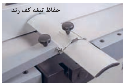
شکل ۳- نمونه‌هایی از حفاظ‌های مخصوص تیغه هر دستگاه
