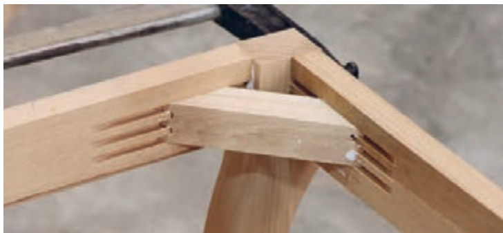
شکل ۱۲- اتصال انگشتی نبشی (بلوک سه‌گوش)
