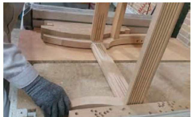
شکل ۵۵- جا زدن اتصالات با تنگ پنوماتیکی
