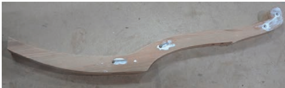
شکل ۴۶- روش چسب زدن اتصال دوبل پایه‌های عقب
