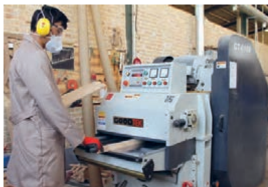
شکل ۷۸- نحوه گندگی کردن چوب‌های کم عرض
