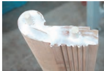
شکل ۴۶- روش چسب زدن اتصال دوبل پایه‌های عقب
