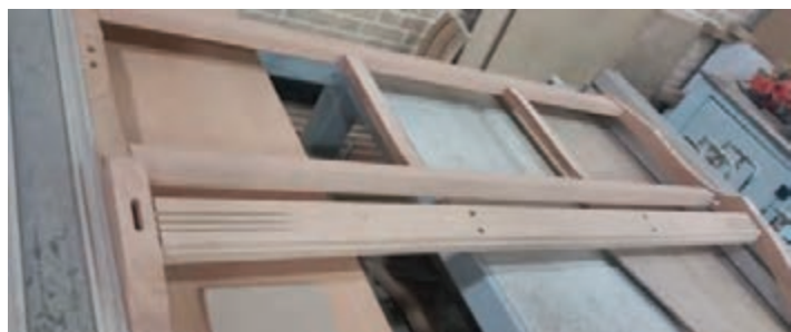
شکل ۵۰- جا زدن پشتی مبل با تنگ پنوماتیک
