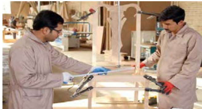
شکل ۱۰۹- کنترل دوئیدگی با متر
