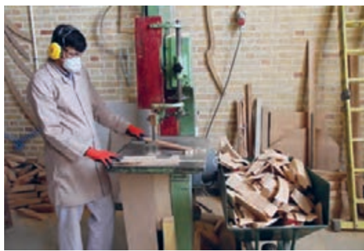
شکل ۸۲- استفاده از چوب کمکی برای ریختن قطعات اضافی در گاری به منظور تمیزی و نظم در کارگاه
