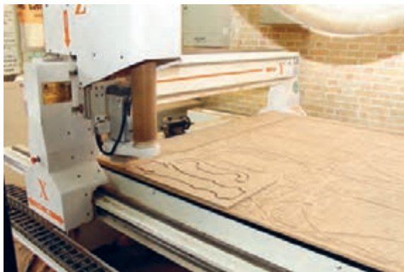
شکل ۶۷- تهیه شابلون با دستگاه فرز CNC
