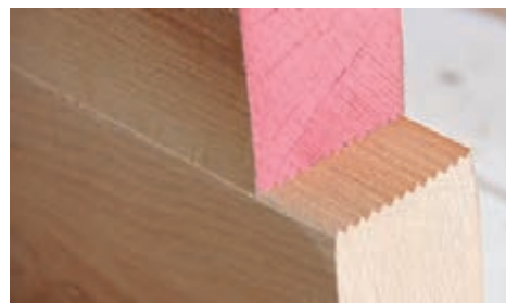
شکل ۱۳- اتصال انگشتی ساخته شده با دستگاه فرز
