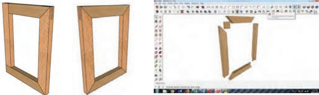
شکل ۱۴- مونتاژ قاب چوبی
