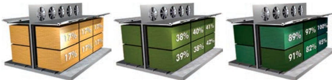
شکل ۶۸- مراحل مختلف خشک کردن چوب در کوره
