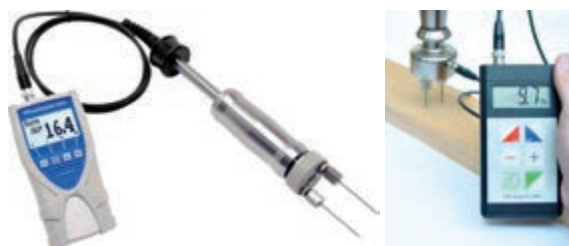
شکل ۷- دستگاه رطوبت سنج نوع مقاومت الکتریکی
