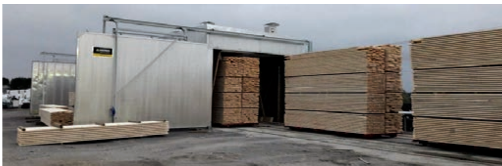
شکل ۶۵- بارگیری دسته‌بندی‌های چوب به طریق طولی
