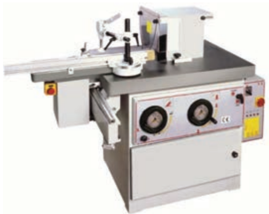
شکل ۳۲- نمونه‌هایی از ماشین فرز میزی
