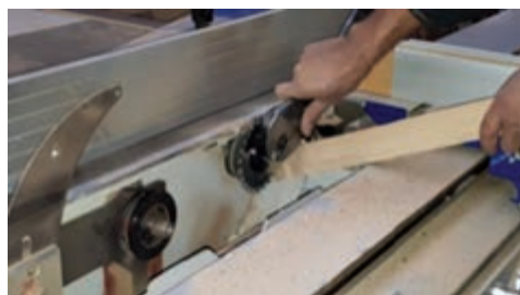
شکل ۶۴- باز کردن و بررسی تیغه خط زن
