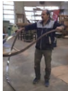
شکل ۱۹- روش جمع کردن تیغه اره نواری
