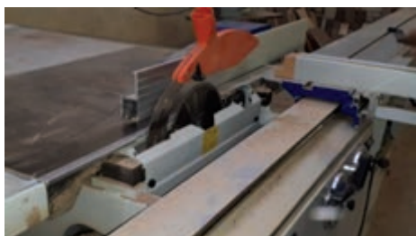
شکل ۶۷- بستن حفاظ و کاور روی تیغه اره
