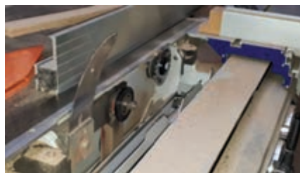
شکل ۶۳- بررسی فلنج پشت تیغه اره
