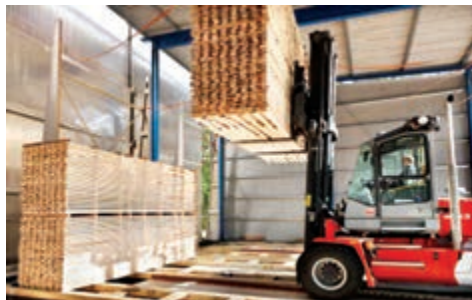
شکل ۲۳- سیستم بارگیری کوره به وسیله لیفت‌تراک
