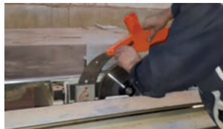
شکل ۶۷- بستن حفاظ و کاور روی تیغه اره
