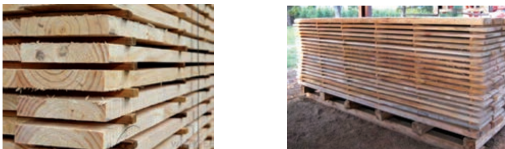
شکل ۱۳- روش چوب‌دستک گذاری در دسته‌های چوب
