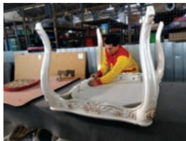
شکل ۸۱- مراحل مونتاژ مبلمان پلیمری
