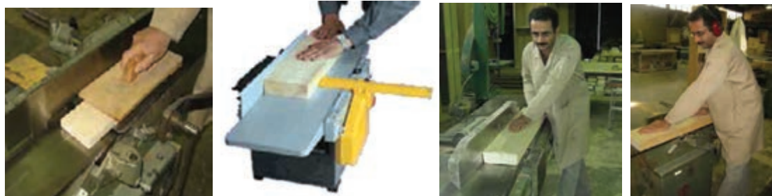
شکل ۲۹- نحوه رندیدن صحیح قطعه کار چوبی
