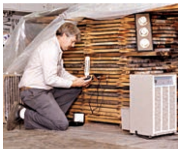
شکل ۵۰- مشخص کردن دمای تر و خشک با لوازم دستی
