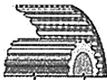
تسمه با مقطع دندانه‌دار
