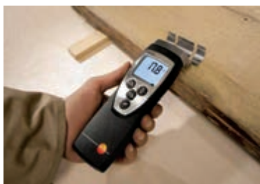
شکل ۶- دستگاه رطوبت سنج نوع دی الکتریک
