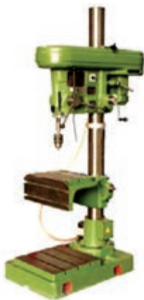
شکل ۳۸- یک نمونه ماشین دریل ستونی
