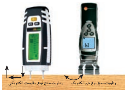
شکل ۸- روش کار رطوبت سنج های الکتریکی
