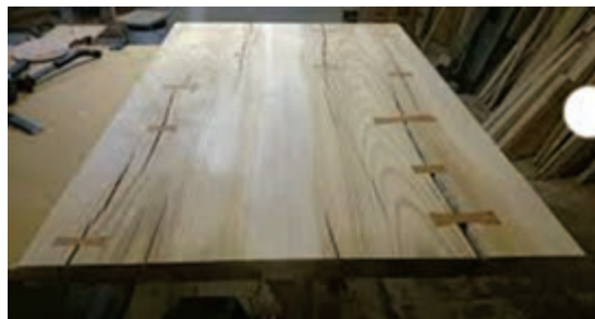
شکل ۶- اتصال دم چلچله پروانه‌ای
