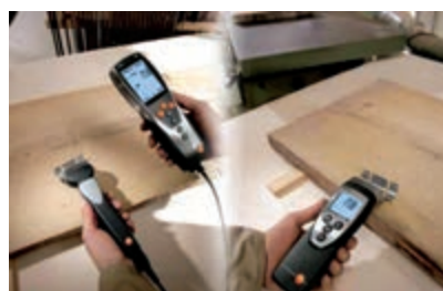
شکل ۶- دستگاه رطوبت سنج نوع دی الکتریک
