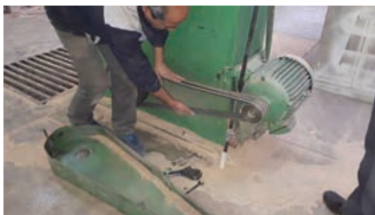
شکل ۵۹- روش باز کردن حفاظ و بررسی تسمه
