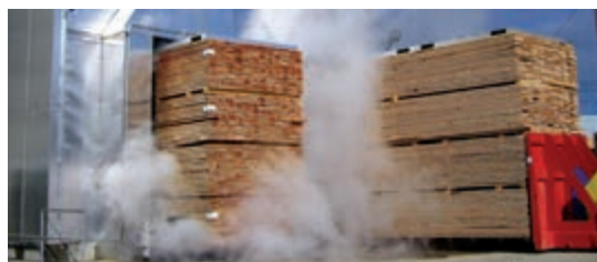
شکل ۶۴- اصول دسته‌بندی چوب روی واگن
