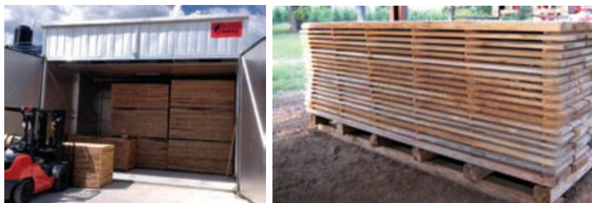
شکل ۶۶- بارگیری دسته‌بندی‌های چوب به طریق عرضی
