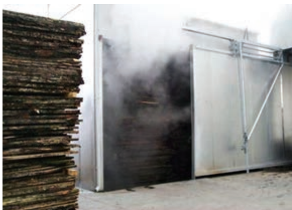
شکل ۶۹- خروج چوب‌های خشک شده از کوره
