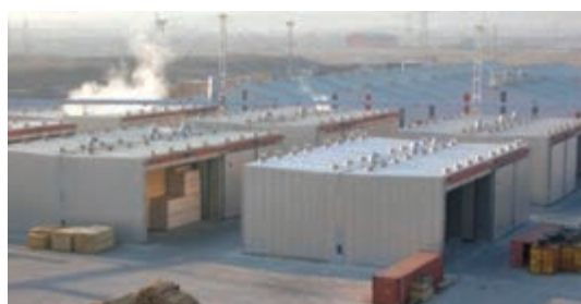
شکل ۲۹- کوره‌های چوب خشک‌کنی ساخته شده با آلومینیوم
