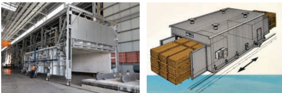
شکل ۶۷- نمونهٔ کوره‌های متحرک و سیستم عملکرد آن
