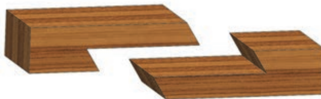
شکل ۳۸- اتصال طولی نیم و نیم
