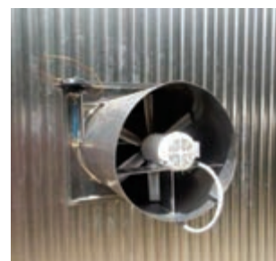
شکل ۴۳- نصب دمنده در خارج از کوره
