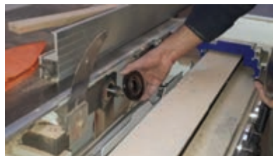
شکل ۶۲- باز کردن مهره و فلنج جلوی تیغه
