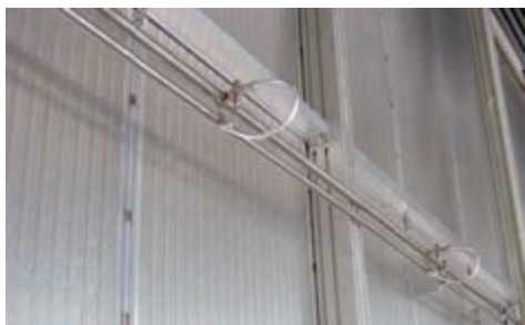
شکل ۳۵- محل قرارگیری اسپری بخار در کوره
