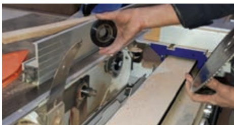
شکل ۶۳- بررسی فلنج پشت تیغه اره
