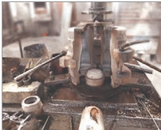
شکل ۱۳- قالب پرس بادی
