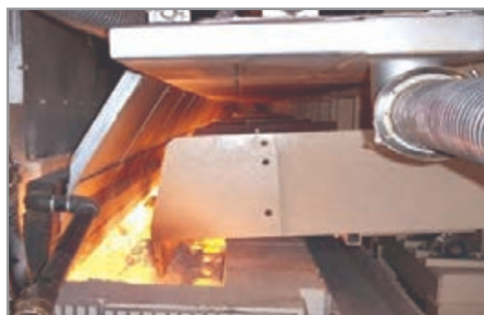
شکل ۱۷- دریچه بارریز کوره‌های شیشه تخت
