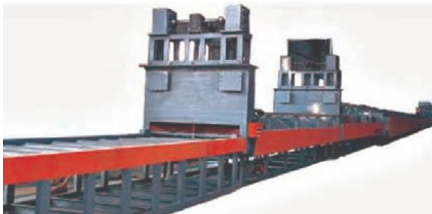
شکل ۱۲- کوره رولری برای عملیات تمپر حرارتی
