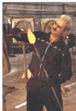
شکل ۷- شکل دهی گوی با کمک ابزار
