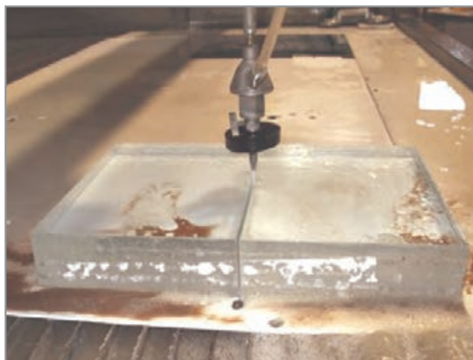
شکل ۳۱- برش شیشه با واتر جت
