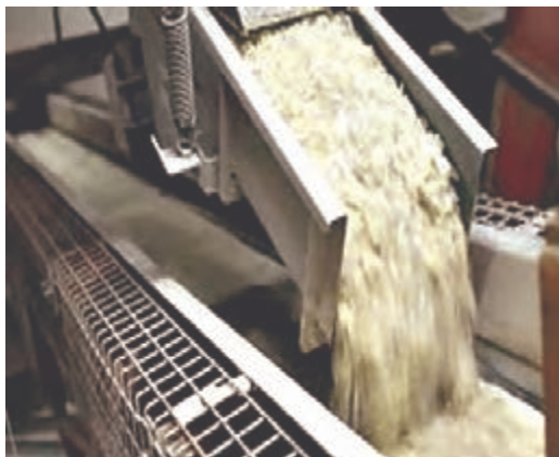
شکل ۲۶- خردایش و آهن‌گیری مواد اولیه
