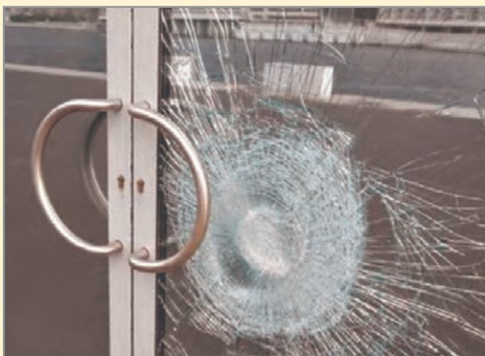
شکل ۳۹- شیشه طلقی (لمینیت) پس از شکسته شدن
