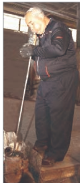
الف) شیشه‌گر در حال دمیدن در قالب
