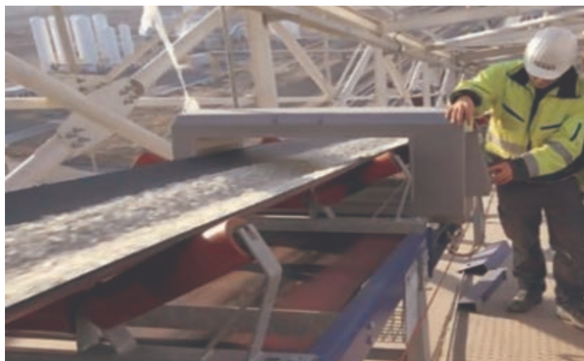
شکل ۳۱- فرایند آهن‌گیری هنگام انتقال مواد پودر شده
