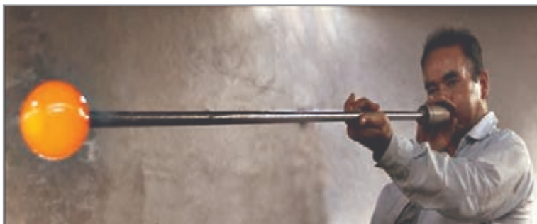
شکل ۵- ایجاد حباب در لقمه مذاب با دمیدن
