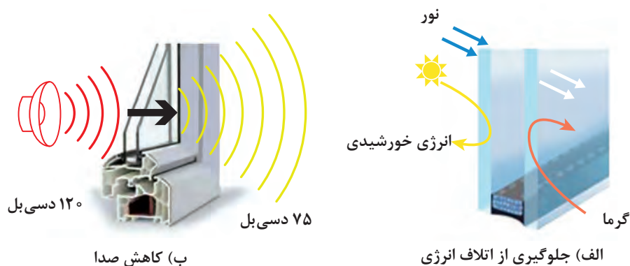
شکل ۴۲- عایق حرارتی و صوتی شیشه دو جداره
