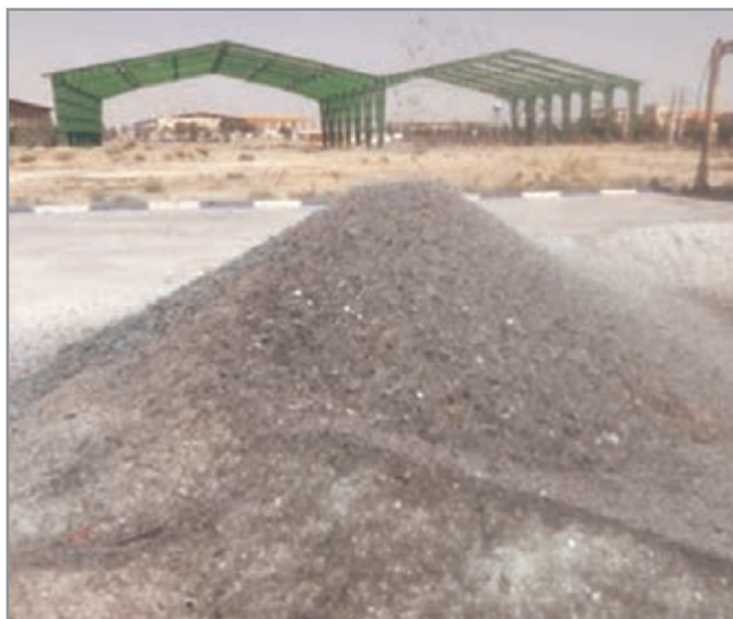
شکل ۳۹- آمیز شیشه سودا-آهکی تهیه شده از خرده شیشه
