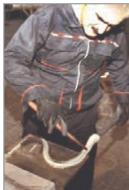
شکل ۷- شکل دهی گوی با کمک ابزار
