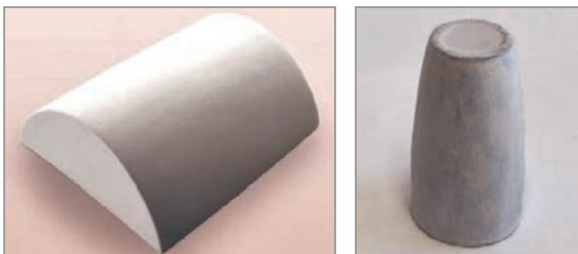
شکل ۲۷- قالب فلزی مورد استفاده در دراپینگ
