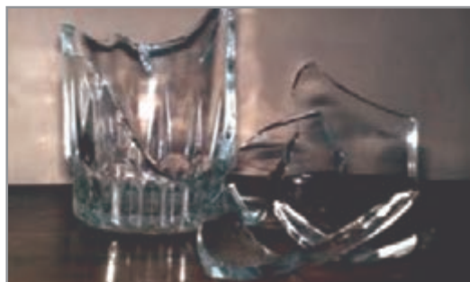
شکل ۸- شکستن شیشه سرد با ریختن مایع داغ
