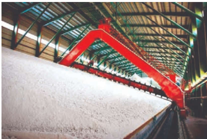
شکل ۳۰- سیلوی سقف دار و برداشت برشی مواد
