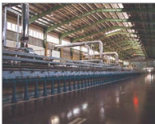
شکل ۳۰- گرمخانه تنش زدایی شیشه
