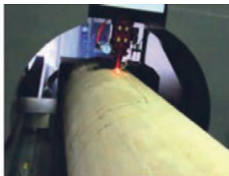
شکل ۱۵- دستگاه برش لیزر روتاری
