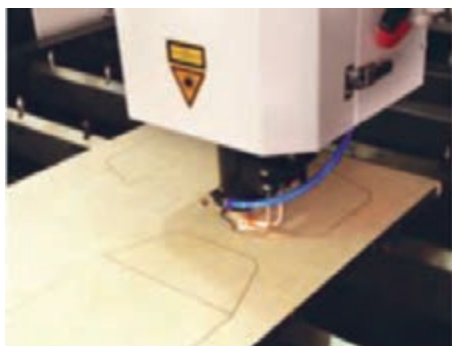
شکل ۱۶- دستگاه برش لیزر تخت
