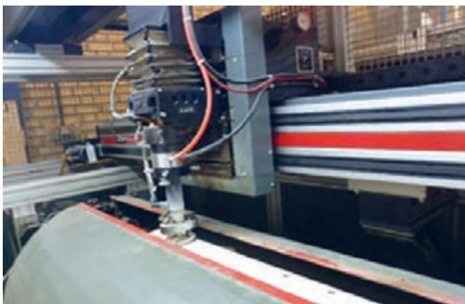
شکل ۱۲۵- دستگاه برش لیزری
