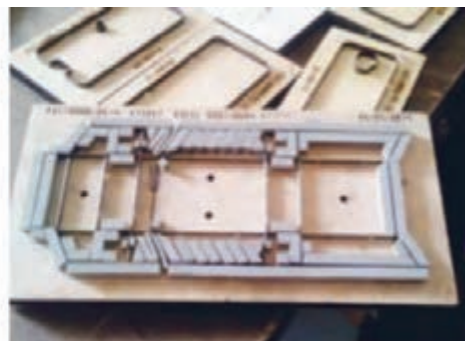
شکل ۱۷- قالب برش تخت
