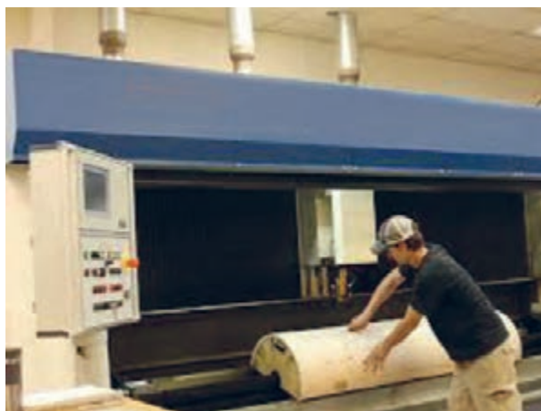
شکل ۱۲۳- قرارگیری سیلندر در دستگاه برش
