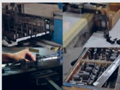
شکل ۱۰۲- خم کن با قطعات مختلف آن
