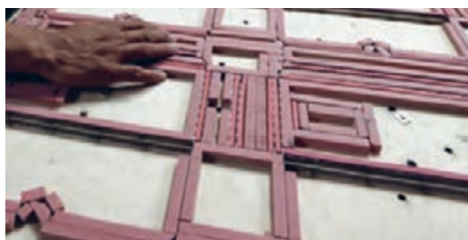
شکل ۱۲۲- قرار دادن لاستیک‌های جدا کننده روی قالب
