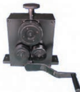
شکل ۱۳۱- دستگاه دستی گردکن تیغ
