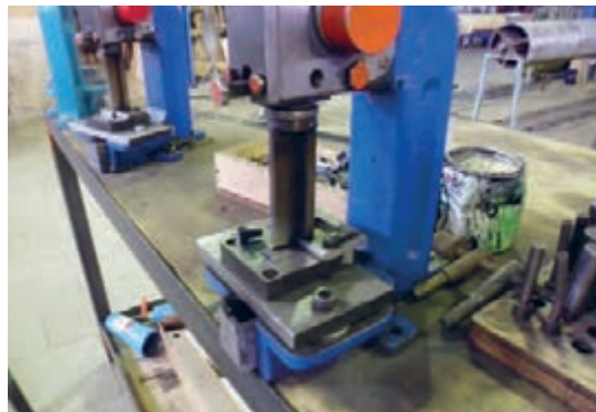
شکل ۱۳۰- دستگاه پانچ تیغ
