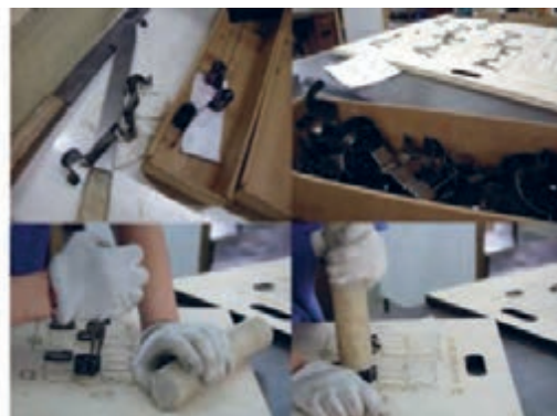
شکل ۱۰۴- قرار دادن تیغ‌ها در قالب
