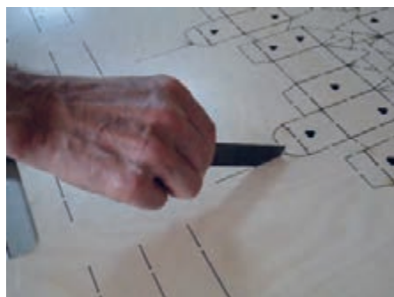
شکل ۱۴۳- بررسی ضخامت شکاف روی تخته
