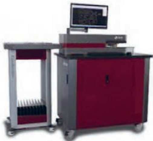
شکل ۱۱۸- دستگاه خودکار برش و خم کن
