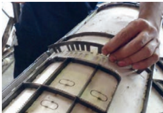
شکل ۱۳۳- قرار دادن تیغ‌ها در سیلندر
