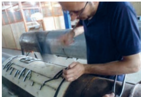
شکل ۱۳۴- جا زدن تیغ‌ها با چکش
