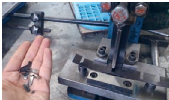
شکل ۹۶- دستگاه جداکننده پل روی تیغ
