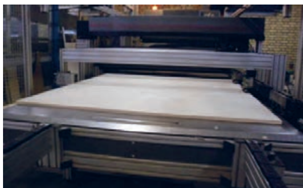
شکل ۱۱۵- تخته قالب در دستگاه قرار داده شده
