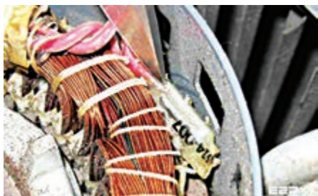
شکل ۳۶- محافظ حرارتی سیم پیچ موتور
