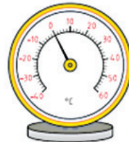
شکل ۱۰- دماسنج دوفلزی حلزونی شکل
