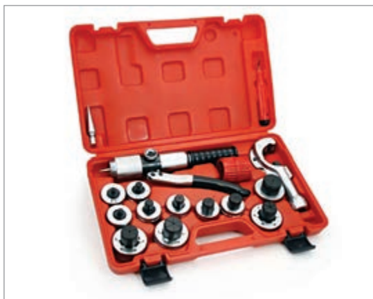
شکل ۲۳- لوازم گشادکن لوله هیدرولیک
