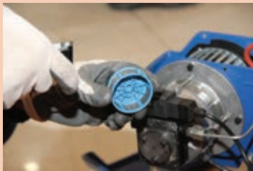
بازکردن درپوش پمپ و تمیز کردن فیلتر
