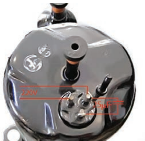
شکل ۱۶- اجزای خارجی کمپرسور
