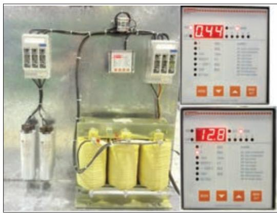
شکل ۱۷- میزان جریان و ضریب توان بار بدون خازن
