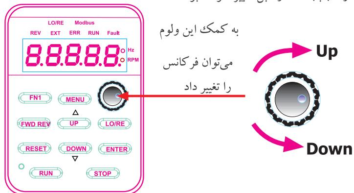
شکل ۲۴-۲: دو نمونه صفحه کلید روی اینورترها
