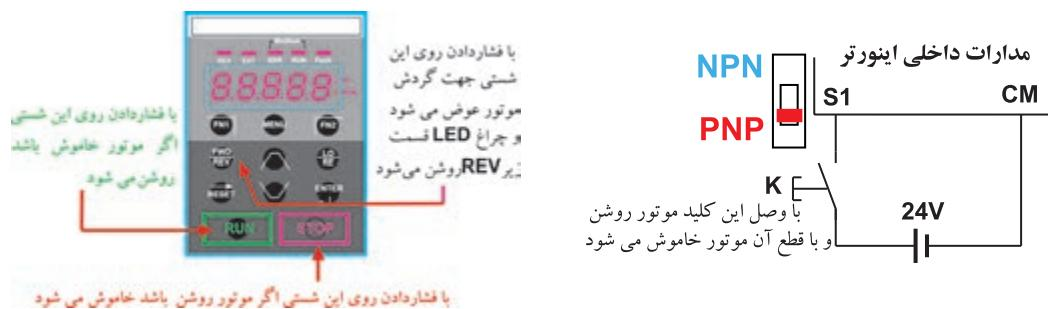
شکل ۲۱- این سه شستی روی اغلب کی پدها برای راهاندازی موتور در حالت Forward و Reverse وجود دارد.
