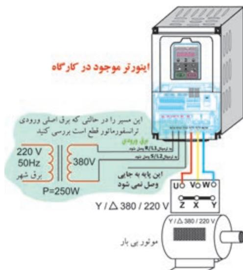
با استفاده از روش فوق ضمن ایزوله کردن برق ورودی اینورتر از برق شهر، می‌توان با برق تک‌فاز، اینورتر را روشن کرد. این روش در جایی که برق سه فاز نیست و قرار است یک اینورتر مورد آزمایش قرار گیرد روش مناسبی است و در حال حاضر نیز مورد استفاده قرار می‌گیرد.
