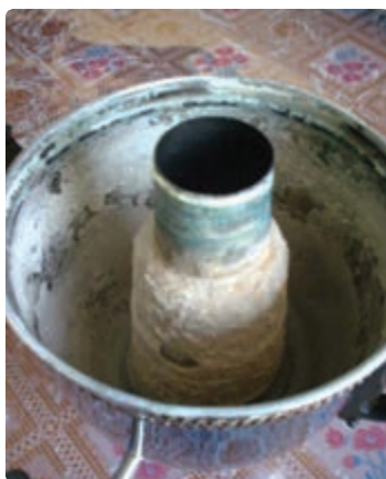
شکل ۸- تشکیل رسوب در سماور و لوله‌ها
