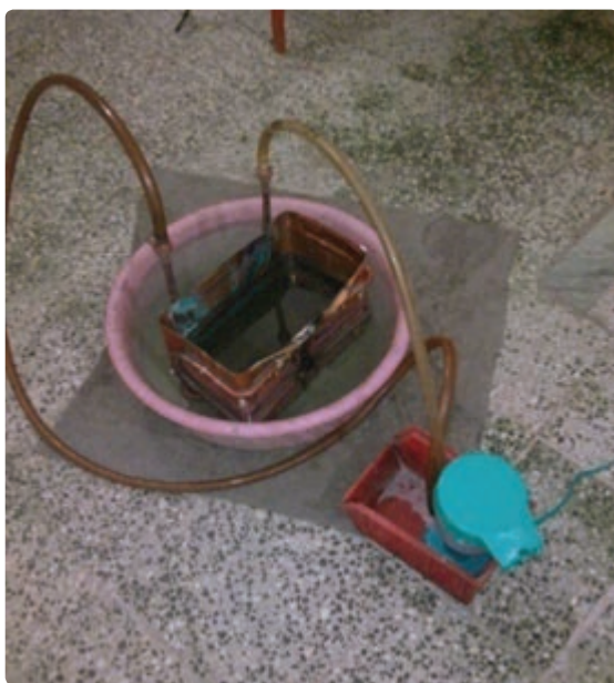
شکل ۱۹- رسوب‌زدایی با پمپ
