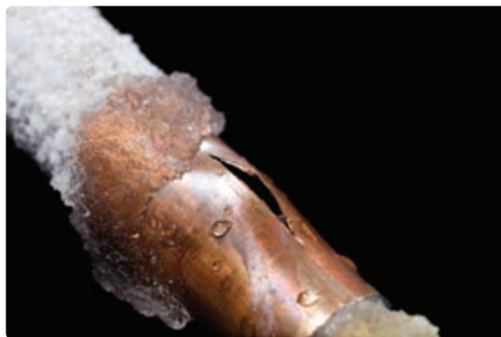
شکل ۶- شکستن لوله آب در اثر انجماد آب
