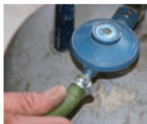
شکل ۱-۶۶ الف شیلنگ با بست
