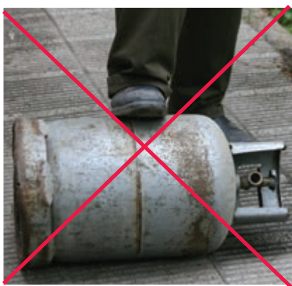
شکل ۶۹-۱ حمل و نقل نادرست کپسول گاز مایع
