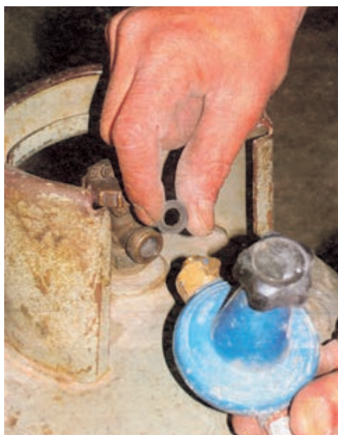
شکل ۱-۶۲ ب رگولاتور قابل تنظیم
