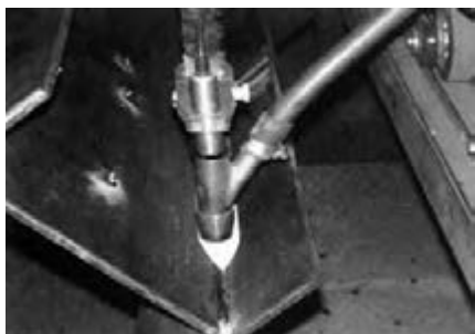
جوشکاری زیر پودری
