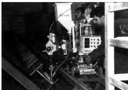
جوشکاری زیر پودری
