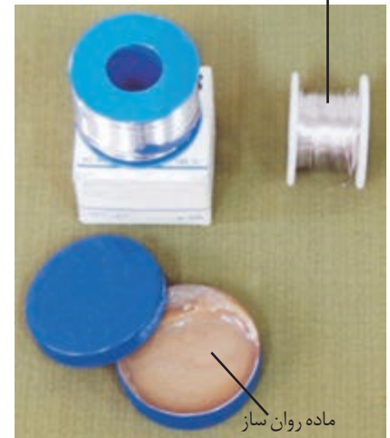
شکل (۱-۱۹) ماده روان ساز (روغن لحیم)
