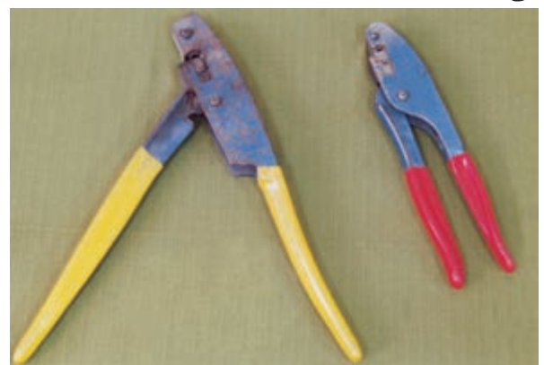
شکل ۱-۳۵- قیچی کابل بری
