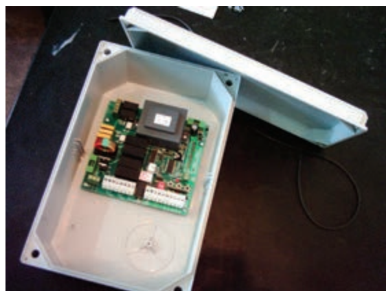
شکل ۱۷-۴ برد الکترونیکی در اتوماتیک لولایی
