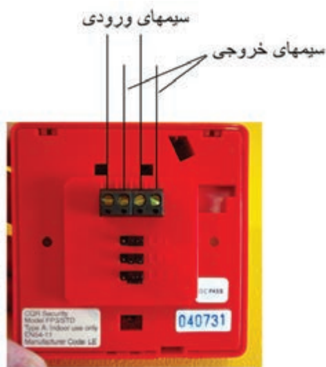
شکل ۳۹-۱ سیمهای اتصال شستی
