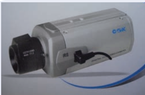
شکل ۳-۲۲ اتصال کابل لنز اتوایریز به دوربین
