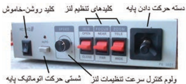
شکل ۳-۵۵ قسمت‌های مختلف جلو کنترل‌کننده
