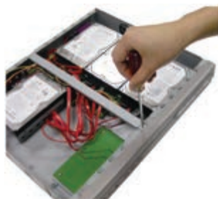
شکل ۶۸-۳ دیسک سخت نصب شده در داخل دستگاه
