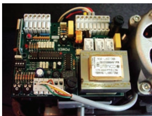
شکل ۱۸-۴ برد الکترونیکی در اتوماتیک ریلی
