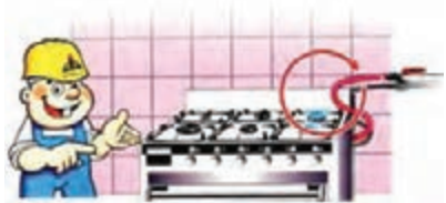
شکل ۸-۷- لوله پلاستیکی حامل گاز نباید از یک متر و نیم بیشتر باشد.
