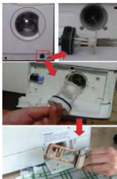
شکل ۳-۴ نحوه تمیز کردن فیلتر لباسشویی
