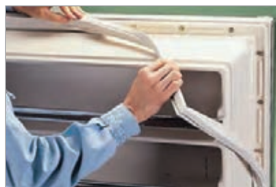
شکل ۹-۵- تعویض نوار لاستیکی در یخچال
