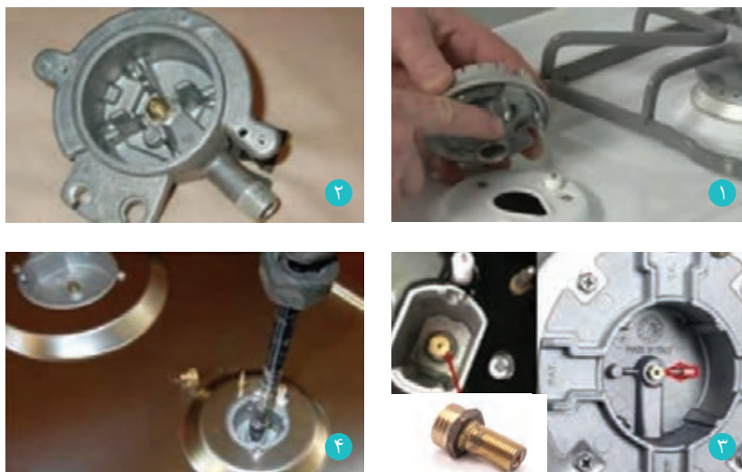
شکل ۴-۷- مراحل تعویض ژینگلور یا پستانک گازی
