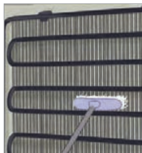
شکل ۵-۶- تمیز کردن کندانسور یخچال
