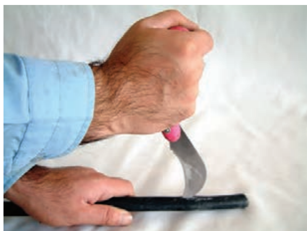
شکل ۵-۳۲ روکش برداری غلط
