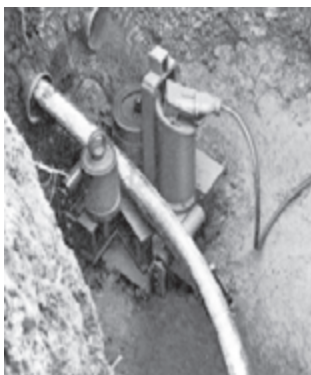
شکل ۵-۵۱- دستگاه کشش کابل
