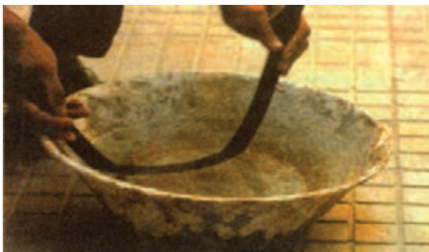
شکل ۴-۴۵ سرد کردن لوله پس از خم‌کاری
