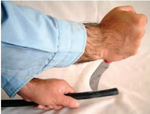
شکل ۵-۳۳- طریقه‌ی صحیح روکش برداری کابل
