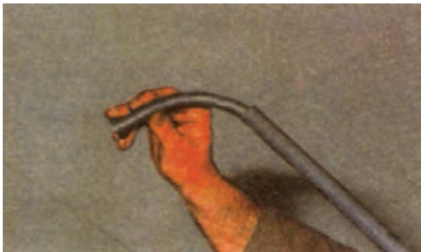
شکل ۴-۴۴ قرار دادن فنر خم‌کاری در داخل لوله
