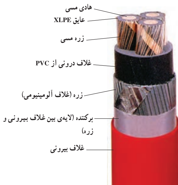
شکل ۵-۷ کابل با غلاف آلومینیومی
