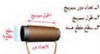
شکل ۳-۸- پارامترهای مهم در یک سلف
