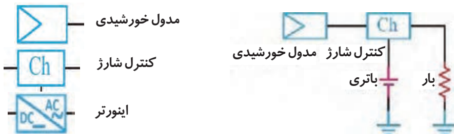
شکل ۹- شمای فنی سامانه فتوولتائیک
