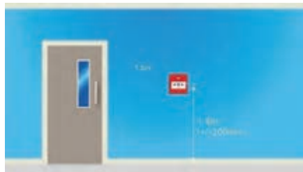
شکل ۸۴- محل و ارتفاع نصب شستی اعلام حریق
