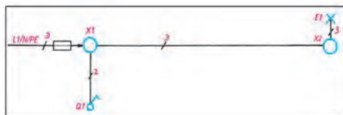
شکل ۱۱- شمای فنی مدار کلید یک پل
