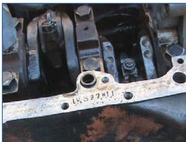
شکل ۸۲-۴- محفظه میل‌لنگ بدون پمپ روغن
