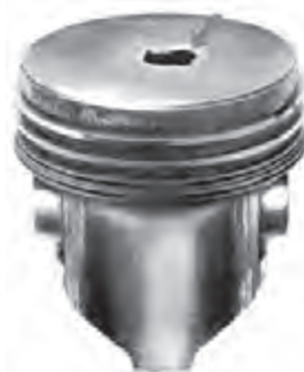
شکل ۴-۱۰۲- سوراخ شدن سر پیستون
