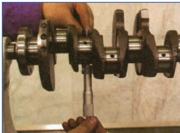
شکل ۱۶۲-۴ اندازه گیری قطر محورها میل لنگ
