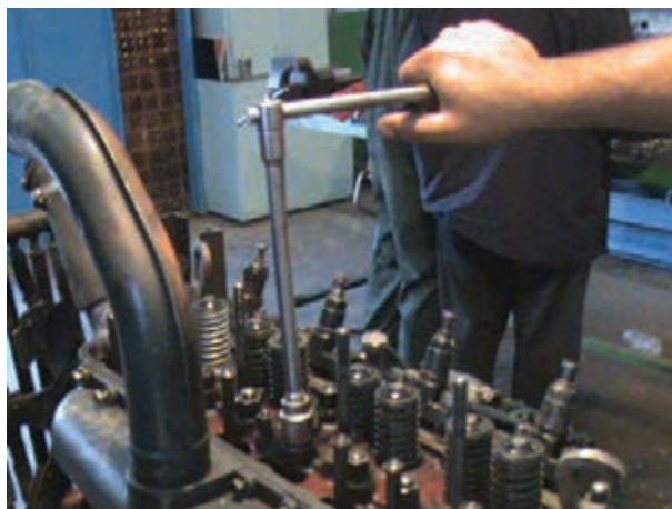
الف) باز کردن پیچ‌های سرسیلندر تراکتور U650
