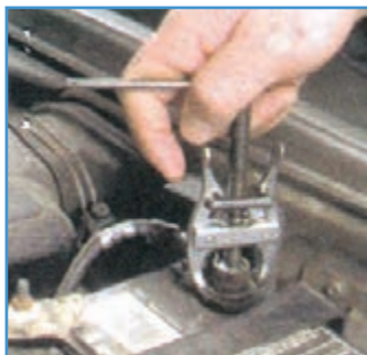
شکل ۶-۷ جدا کردن بست منفی باتری
