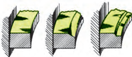
شکل ۱۳۲-۴- فرم خاص در لبه داخلی رینگ
