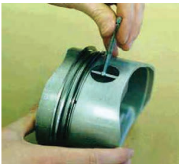
شکل ۱۱۷-۴ اندازه‌گیری سوراخ انگشتی روی پیستون
