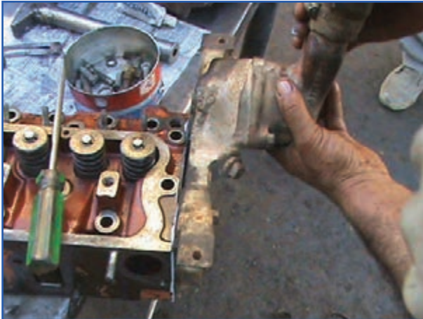
الف) باز کردن محفظه ترموستات تراکتور MF399
