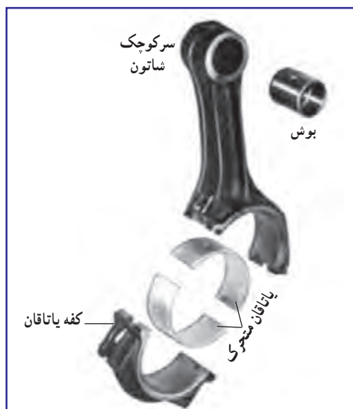
شکل ۲۹-۲- اتصال کفه به شاتون
