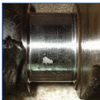
ب) پوسته کردن لایه سخت لنگ
