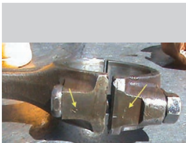
شکل ۸۷-۴- علامت روی کپه شاتون و شاتون
