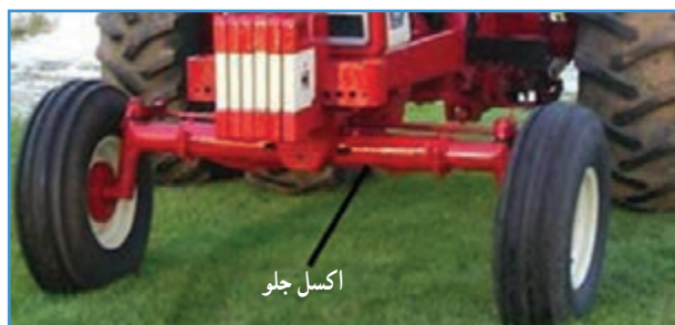
شکل ۲۲-۲- اکسل جلو تراکتور
