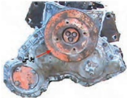
شکل ۴-۶۴- پولی نصب‌شده روی میل‌لنگ
