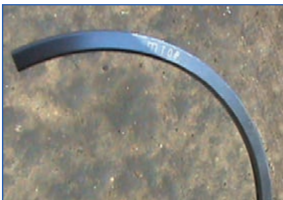
شکل ۱۳۴-۴- علامت TOP روی رینگ
