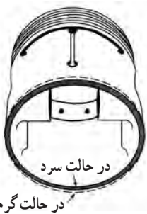
شکل ۱۹-۲ وضعیت پیستون در حالت گرم و سرد
