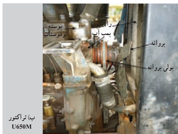
شکل ۳۵-۲ پمپ آب تراکتور
