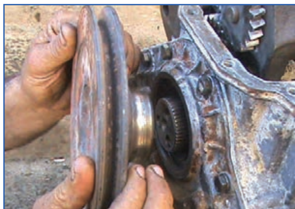
شکل ۴۶- ۷- جازدن چرخ تسمه سر میل لنگ
