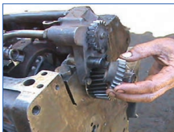
شکل ۸۰-۴- خارج کردن چرخ‌دنده پمپ روغن
