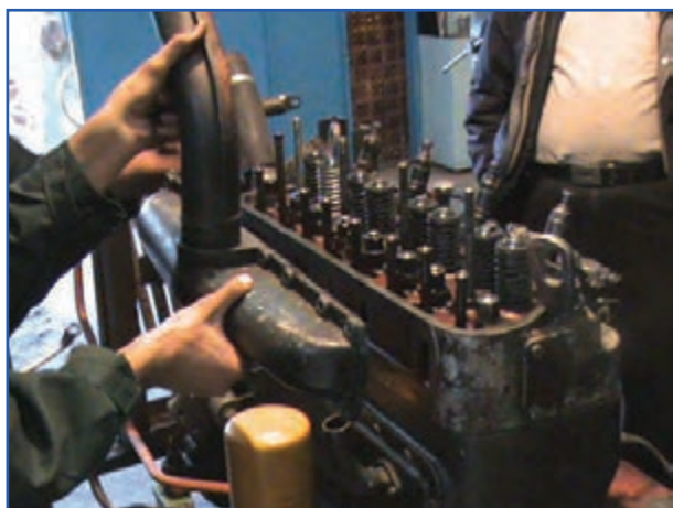
شکل ۴-۴- باز کردن مانیفولد هوا
