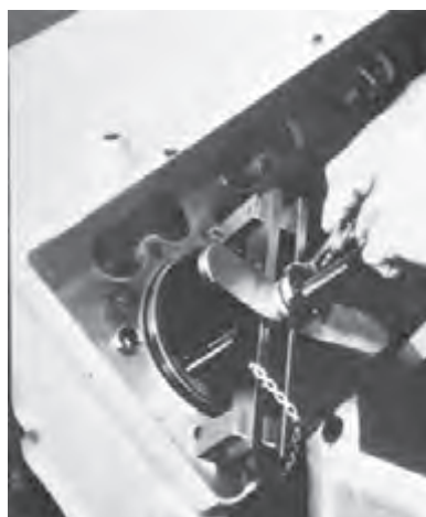
شکل ۱۴۳-۴- نحوه پیاده کردن بوش سیلندر
