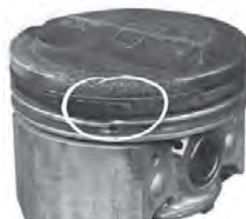
شکل ۴-۹۹- شکستن رینگ و تخریب جای رینگ
