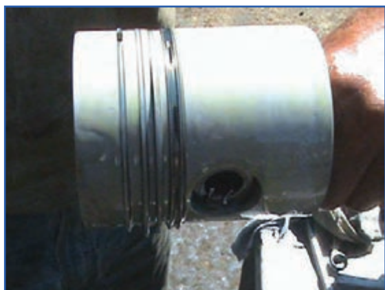
شکل ۱۴۰-۴ روغن‌کاری همه رینگ‌ها و پیستون
