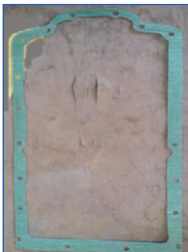
ب) واشر کارتر چوب‌پنبه‌ای MF285
