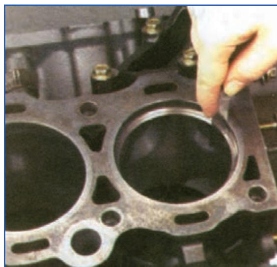
شکل ۱۲۸-۴ طرز اندازه‌گیری دهانه رینگ با فیلر
