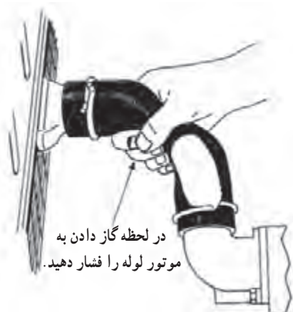
شکل ۲۰-۳ نحوه فشار دادن شیلنگ بالای رادیاتور
