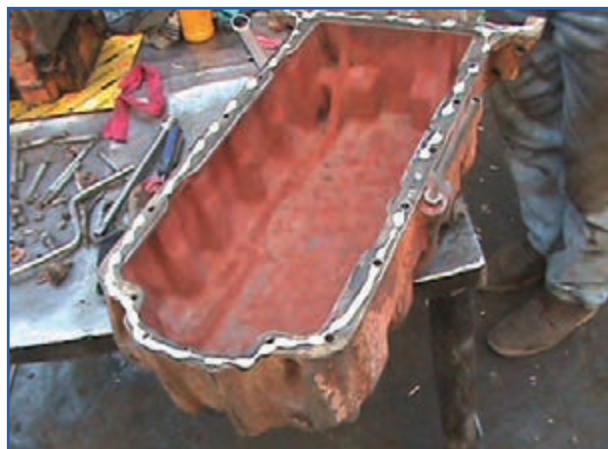
شکل ۲۵-۷- کارتیر تراکتور MF285
