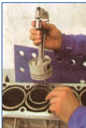
شکل ۱۲۷-۴ طرز قرار دادن رینگ داخل سیلندر
