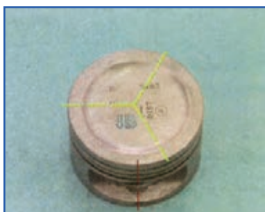
شکل ۱۳۵-۴ زاویه قرار گرفتن رینگ‌ها نسبت به هم
