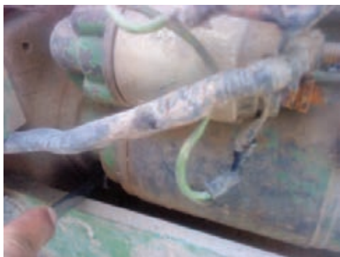
شکل ۵۱-۶ باز کردن پیچ‌های اتصال استارت به بدنه موتور
