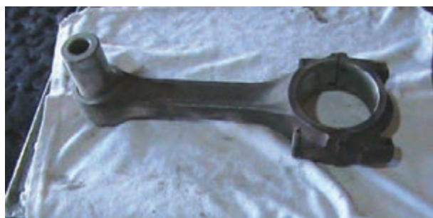
شکل ۱۲۱-۴ امتحان کردن انگشتی روی شاتون
