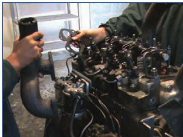
شکل ۴-۴- باز کردن مانیفولد هوا
