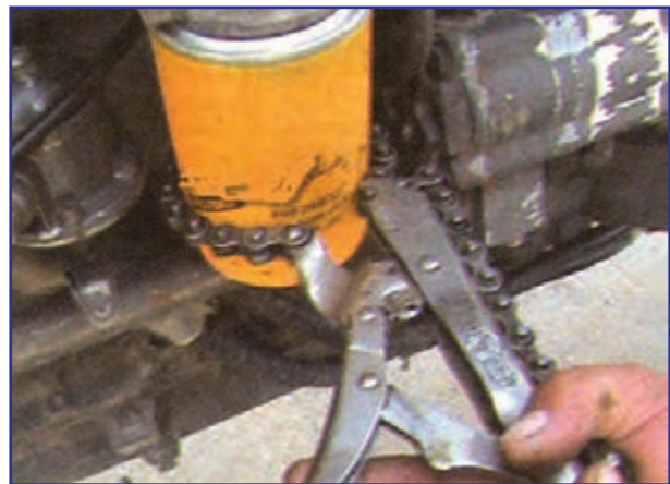
شکل ۱۶-۷ باز کردن صافی روغن با آچار مخصوص
