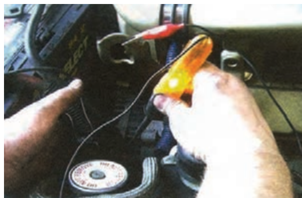
شکل ۷۷-۶ اتصال لامپ آزمایش به مدار
