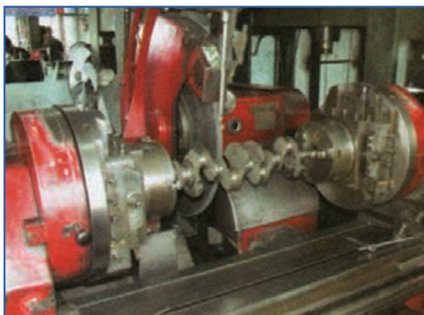
شکل ۱۶۴-۴ دستگاه میل لنگ تراشی
