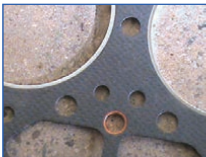
ب) سمت باریک نوار فلزی واشر سرسیلندر
