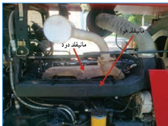
شکل ۲۷-۲ مانیفلد هوا و دود تراکتور MF399
