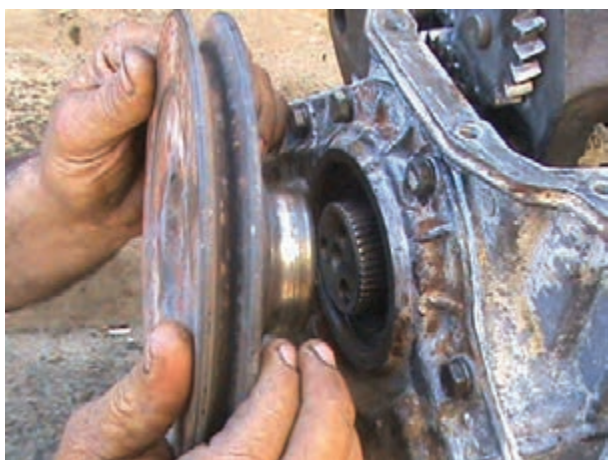
شکل ۴-۵۷- خارج کردن پولی میل لنگ
