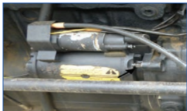
شکل ۳-۸ پیچ های نگهدارنده استارت تر تراکتور MF285
