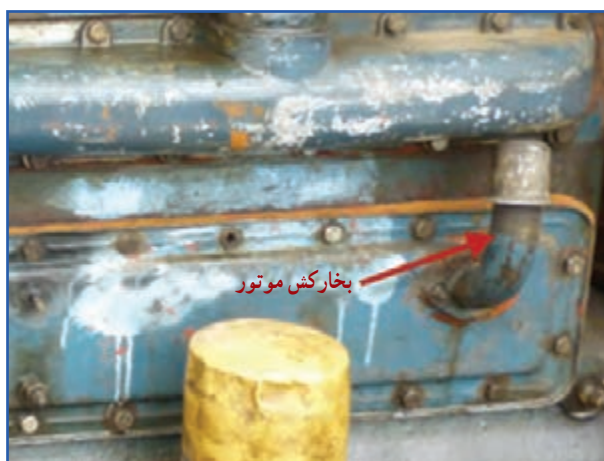
شکل ۲۶-۷- تهویه محفظه کارتیر تراکتور U650M
