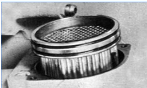
شکل ۳۵-۷- محل قرار گرفتن کویل روغن
