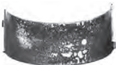
شکل ۱۶۸-۴ اثرات سوختگی روی یاتاقان
