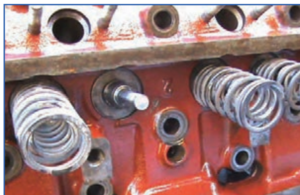
شکل ۲۱-۴- نحوه برداشتن فنر سوپاپ
