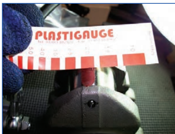
شکل ۱۷۶-۴ اندازه گیری دو بهنی پلاستی گیج شابلون
