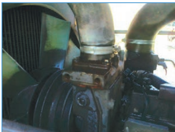
شکل ۱۱-۳- محل بست شیلنگ محفظه ترموستات
