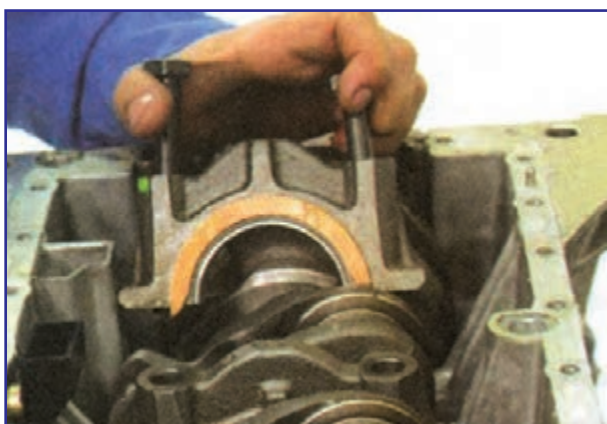
شکل ۱۸۱-۴ برداشتن کپه یاتاقان دارای بغل یاتاقانی
