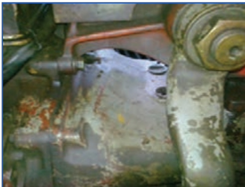
شکل ۹-۳- پیچ‌های اتصال موتور به جعبه‌دنده قسمت بالا
