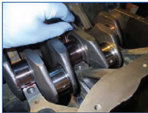
شکل ۱۸۳-۴ خارج کردن بغل یاتاقانی
