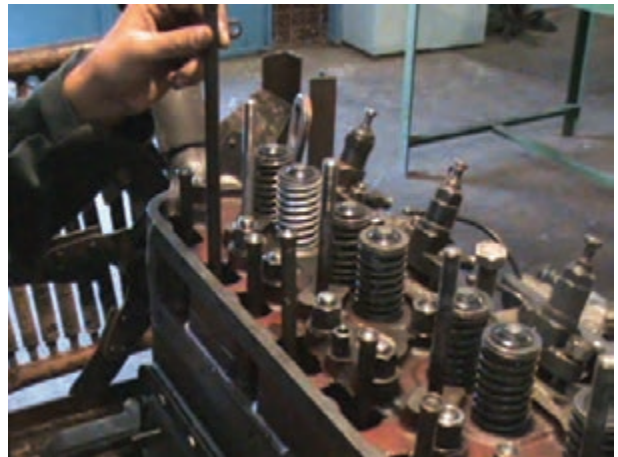
الف) برداشتن میل تایپت
