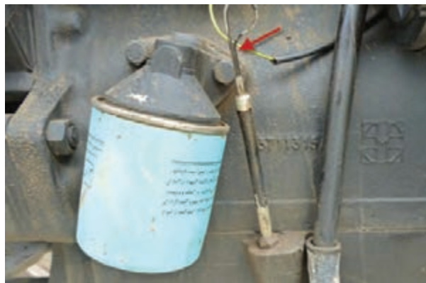
شکل ۳۰-۷ میله سنجش سطح روغن تراکتور MF285
