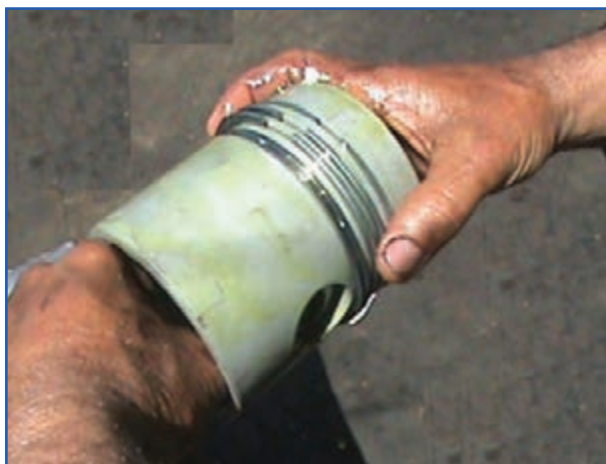
شکل ۱۹۶-۴- تنظیم کردن دهانه رینگ‌ها
