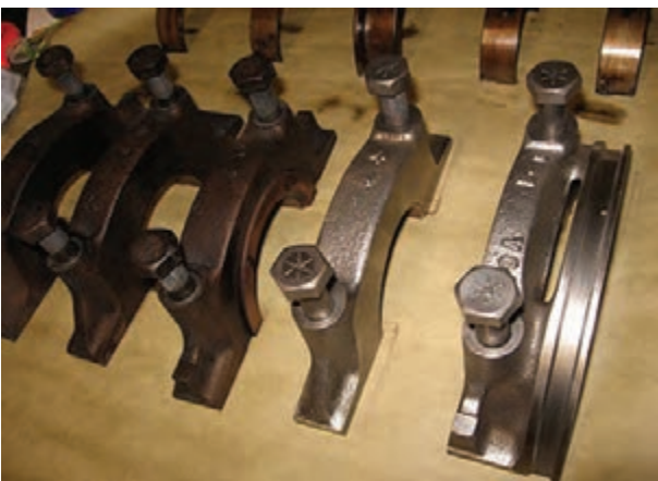
شکل ۱۵۴-۴- چیدن کپه یاتاقان‌ها
