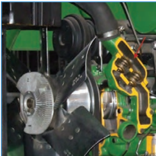
شکل ۲۴-۳ - طرز صحیح قرار گرفتن ترموستات
