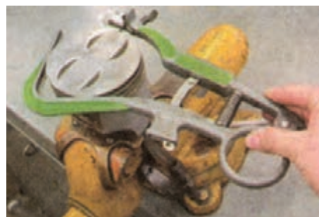
(ب) کاربرد ابزار تمیزکننده شیار رینگ‌ها
