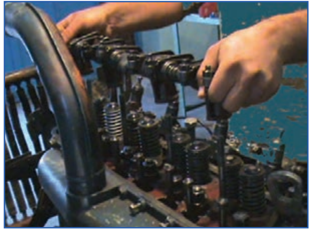
شکل ۹-۴ برداشتن محور اسبک و اسبک‌ها تراکتور U650
