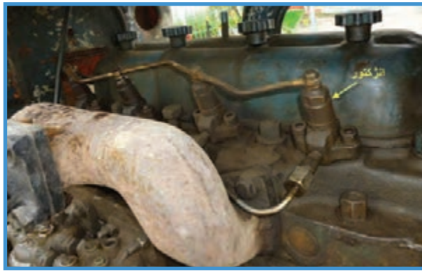
شکل ۳۲-۲- انژکتورهای تراکتور U650M
