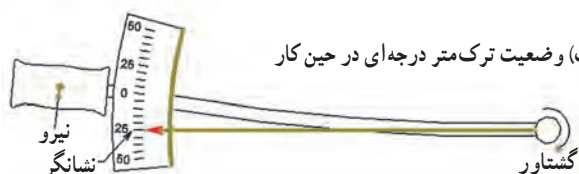
شکل ۳-۵۵- ترک متر درجه‌ای
