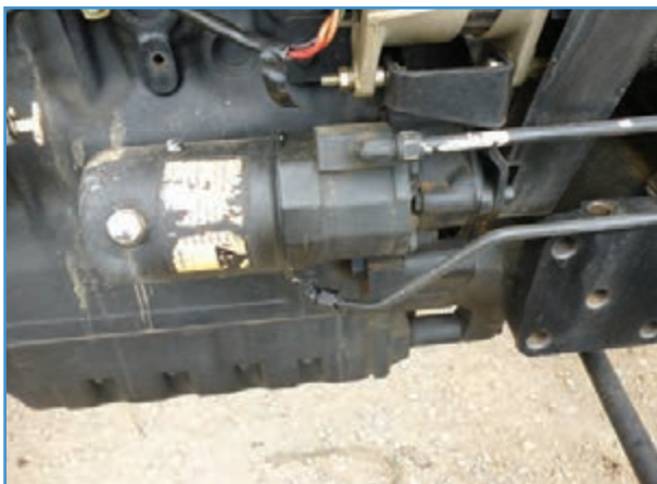
شکل ۲۳-۲. پمپ هیدرولیک فرمان و صافی تراکتور MF285
