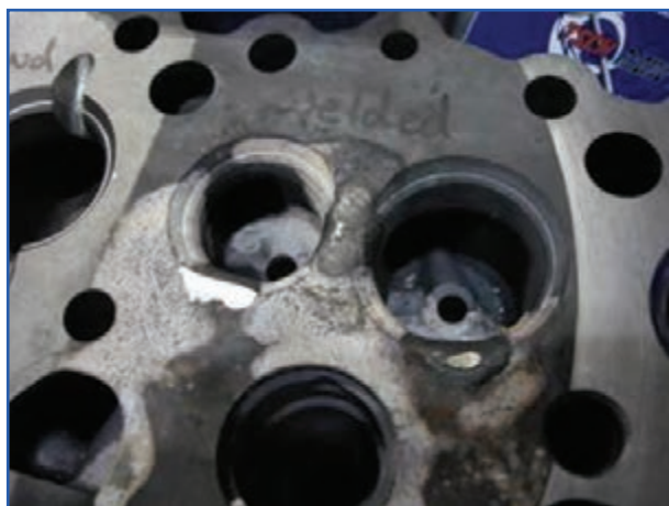
شکل ۲۶-۴- ترمیم ترک سرسیلندر با جوشکاری
