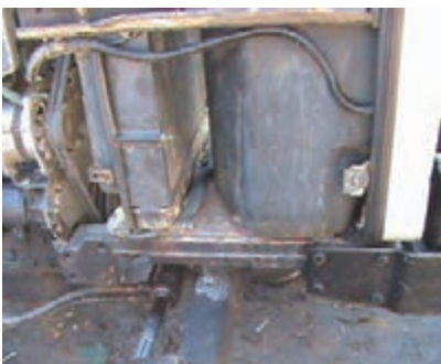
و) باز کردن بست نگهدارنده باک
