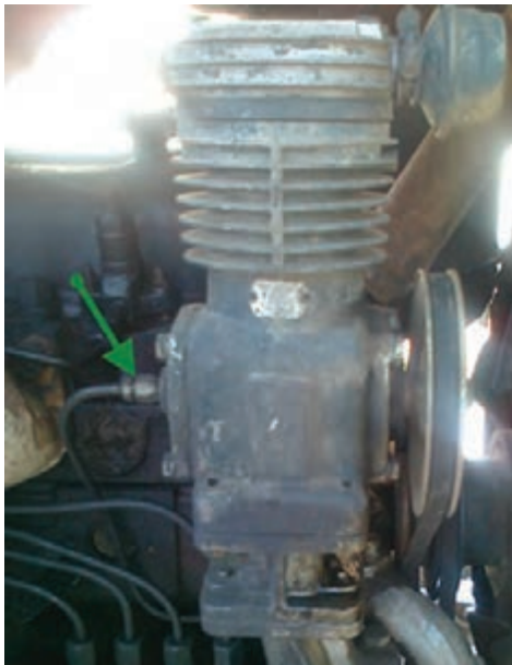
شکل ۵-۸- لوله روغن کاری کمپرسور در تراکتور U650
