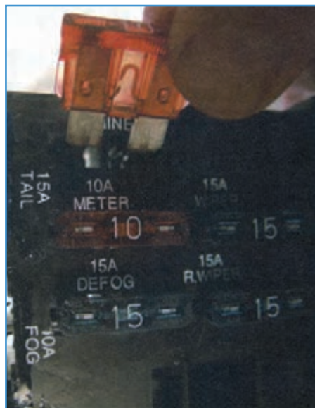
شکل ۶۹-۶ جازدن فیوز در محل آن
