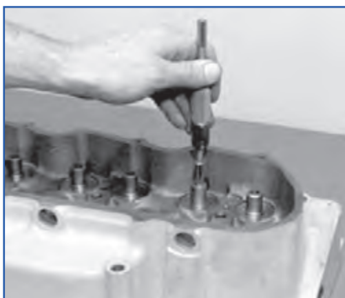
شکل ۴-۴۰- تمیز کردن گیت سوپاپ
