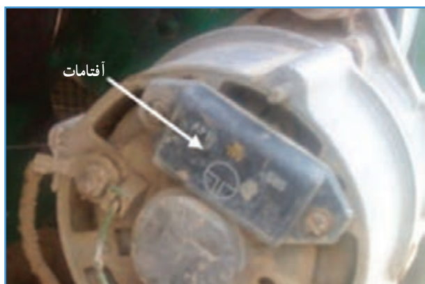
الف) آفتامات روی آلترناتور تراکتور JD3140
