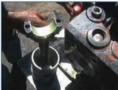
شکل ۱۹۲-۴ روغن‌کاری رینگ‌ها، پیستون و یاتاقان
