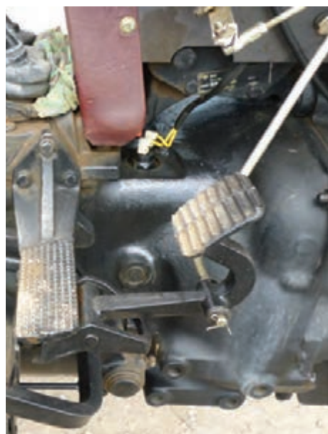
شکل ۱۱-۳- پیچ‌های اتصال موتور به جعبه‌دنده قسمت پایین
