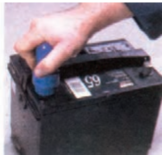
شکل ۲۳-۶- تمیز کردن قطب‌های باتری با ابزار مخصوص
