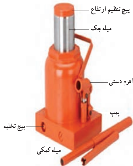
شکل ۹-۴- اجزای جک روغنی
