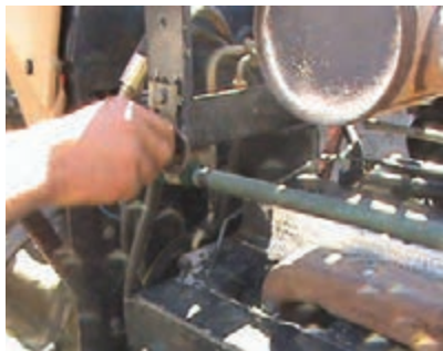
ج) باز کردن شاسی نگهدارنده رادیاتور
