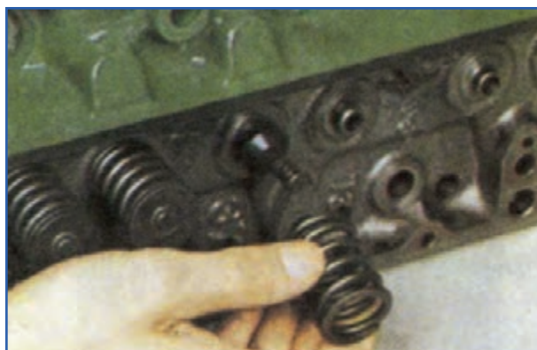
شکل ۲۱-۴- نحوه برداشتن فنر سوپاپ
