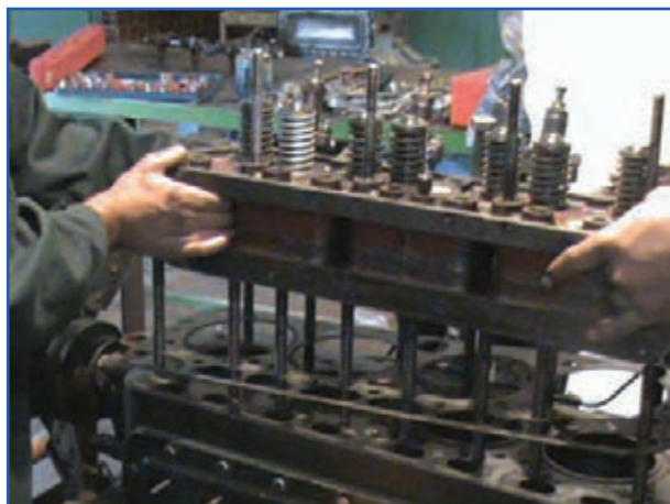
شکل ۱۴-۴ بلند کردن سرسیلندر از روی بدنه سیلندر
