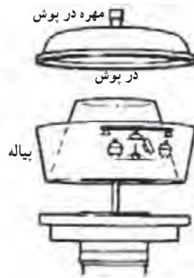
شکل ۳-۵ - قطعات پیش صافی
