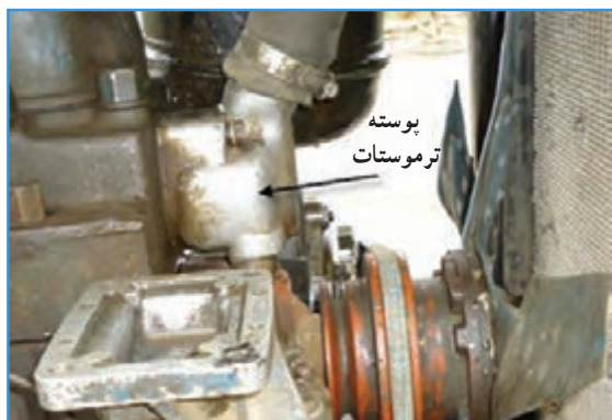
شکل ۳۷-۲ پوسته ترموستات تراکتور U650
