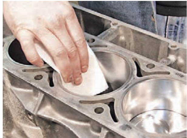
شکل ۴-۲۸- تمیز کردن داخل سیلندر
