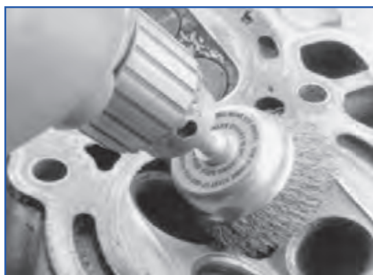
شکل ۴-۴۱- تمیز کردن اتاق احتراق
