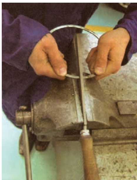
شکل ۱۳۰-۴ ساییدن دهانه رینگ با سوهان
