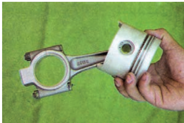
شکل ۱۲۶-۴ طرز آزمایش لقی شاتون روی انگشتی
