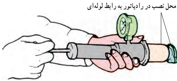
شکل ۱۶-۳ - آزمون سوپاپ فشار در رادیاتور
