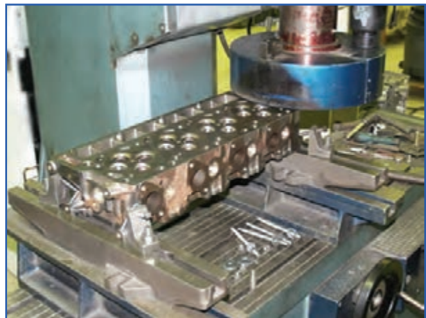
شکل ۳۲-۴- دستگاه کف تراشی سرسیلندر
