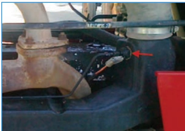
ب) شمع گرم کن تراکتور MF399
