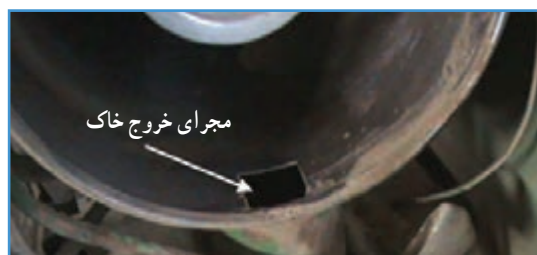
شکل ۱۱-۵ محل خاکدان در تراکتور جاندیر
