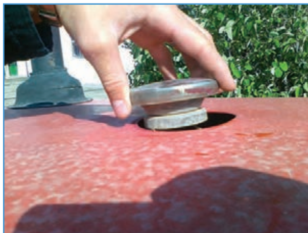
شکل ۷-۳- باز کردن در رادیاتور تراکتور MF285
