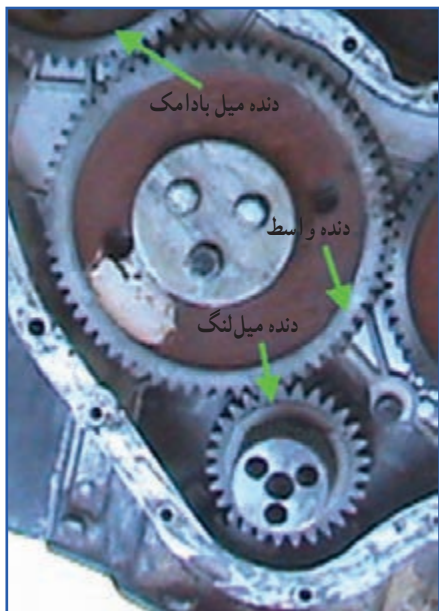
شکل ۱۲-۲- نسبت دنده میل بادامک به میل لنگ
