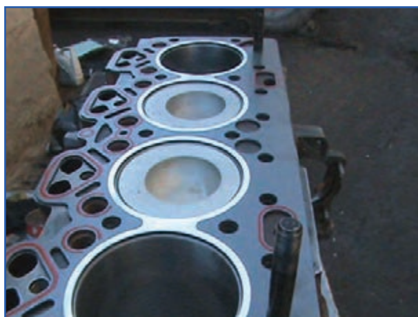
شکل ۵۲-۴ قرار دادن واشر سرسیلندر روی بدنه سیلندر
