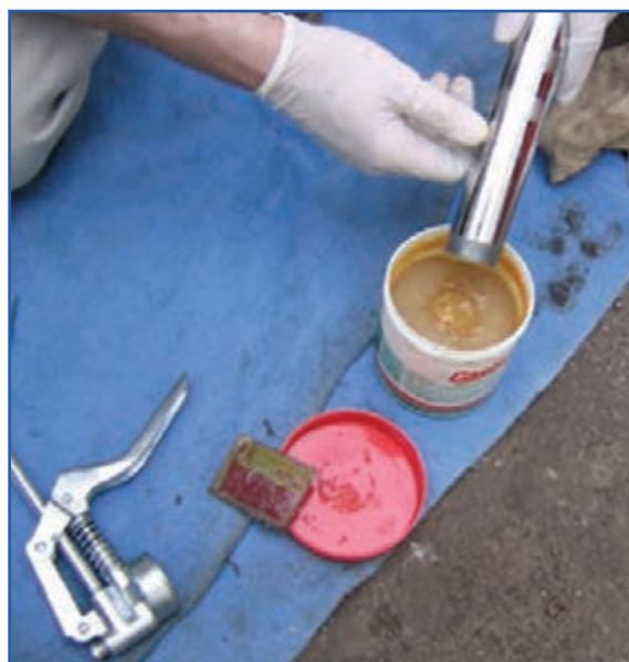
شکل ۴۸- ۷- مراحل پر کردن گریس پمپ دستی
