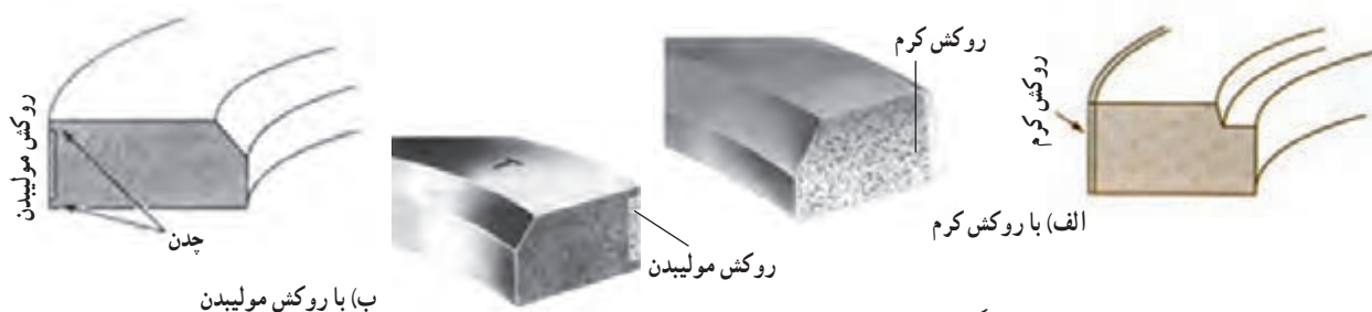
شکل ۲۴-۲- مقطع رینگ‌های تراکم روکش‌دار
