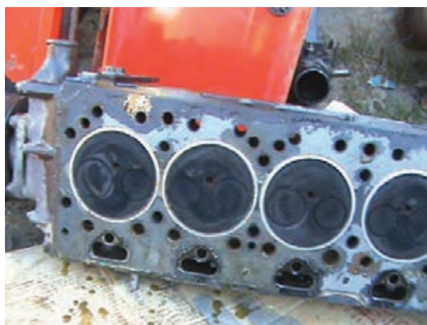
شکل ۱۵-۴ طرز قرار دادن سرسیلندر روی سطح صاف
