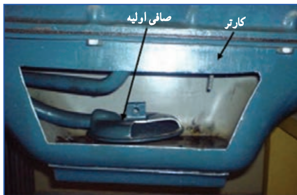
شکل ۲۴-۷- کارتیر برش خورده تراکتور U650
