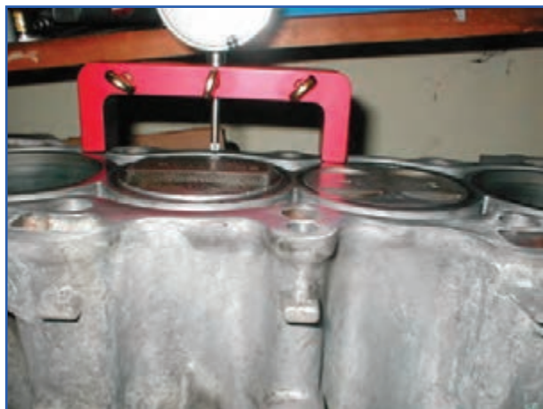
شکل ۲۰۵-۴ کنترل ارتفاع پیستون
