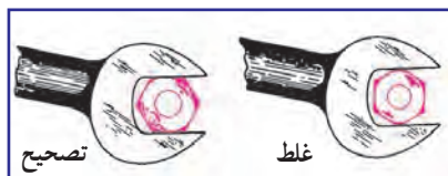
شکل ۲۹-۳ طرز درگیر کردن آچار تخت با مهره
