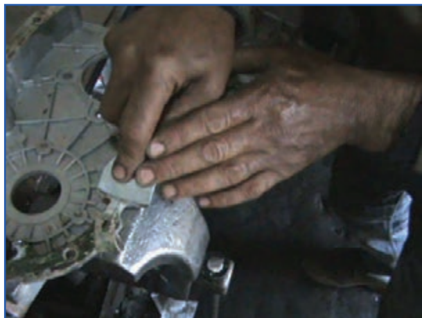
شکل ۷۶-۴- تمیز کردن واشر محفظه جلو موتور
