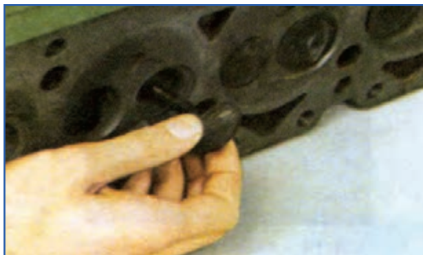
شكل ۲۳-۴- نحوه خارج کردن سوپاپ‌ها
