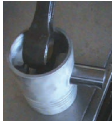
شکل ۱۲۲-۴ اتصال شاتون به پیستون و جازدن انگشتی
