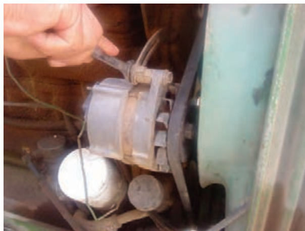
شکل ۳۸-۶ سفت کردن پیچ تنظیم آلترناتور
