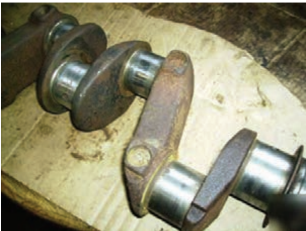
شکل ۴-۳۰- میل لنگ با رسوبات کربن
