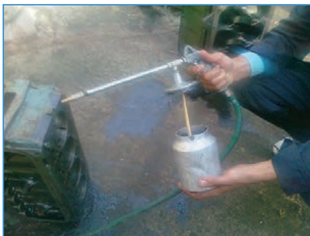
شکل ۱-۳- باز کردن مخزن پیستوله شستشو
