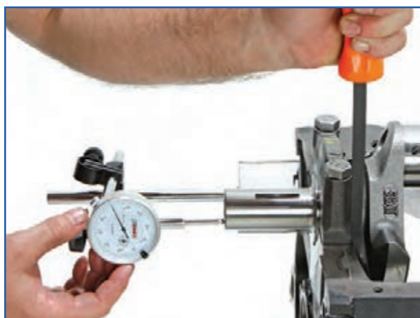
شکل ۱۷۹-۴ اندازه گیری لقی طولی میل لنگ با ساعت اندازه گیری
