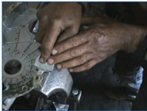
شکل ۴۱-۷ تمیز کردن واشر سینی جلو با کاردک
