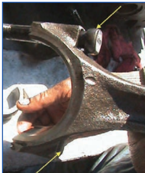
شکل ۸۵-۴- خارج کردن پیچ شاتون
