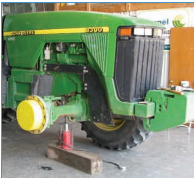
شکل ۱۱-۴- قرار دادن جک روغنی زیر جسم سنگین
