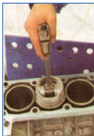
شکل ۱۲۷-۴ طرز قرار دادن رینگ داخل سیلندر
