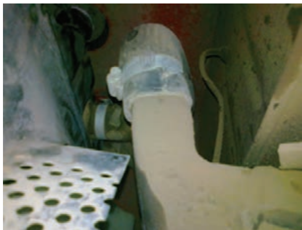
شکل ۱۵-۳- اتصال شیلنگ رادیاتور
