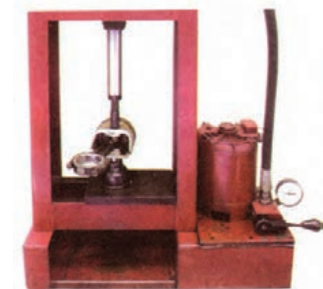
شکل ۸-۴- خارج کردن انگشتی با پرس هیدرولیک
