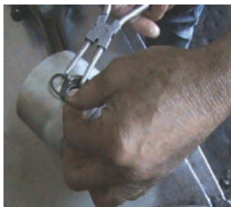
شکل ۱۲۵-۴ طرز جازدن خار انگشتی
