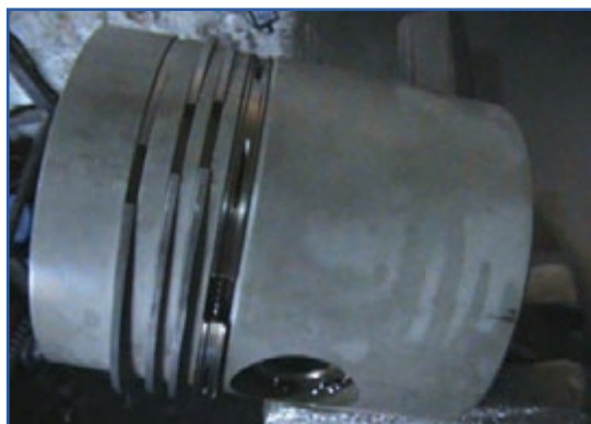
شکل ۱۳۹-۴ ترتیب قرار گرفتن رینگ‌ها روی شیار پیستون
