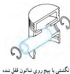
شکل ۳۱-۲- انواع اتصال انگشتی به پیستون
