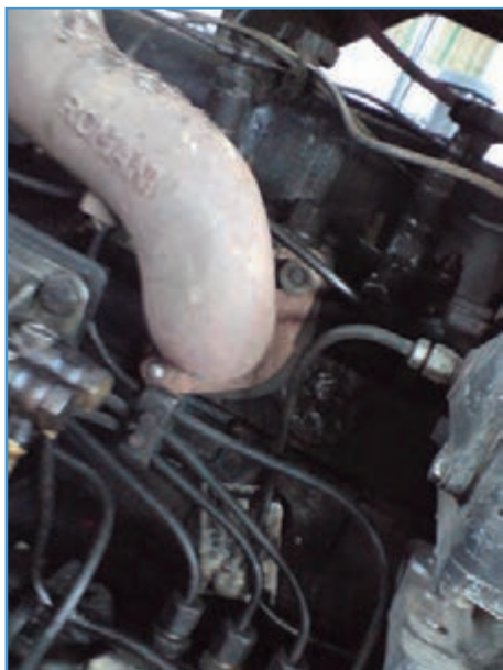
شکل ۳۱-۵- محل اتصال مانیفلد به سرسیلندر تراکتور U650
