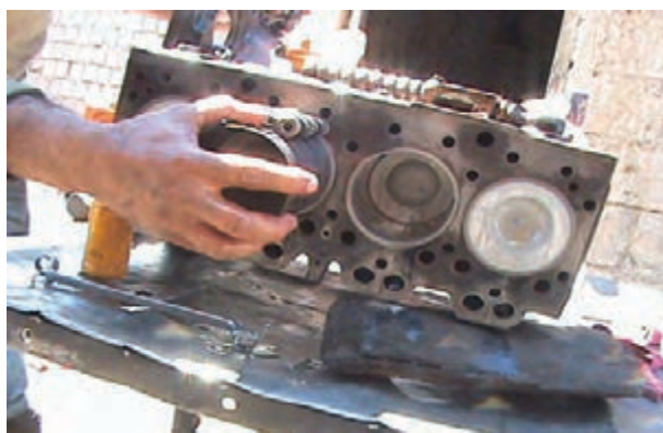
شکل ۱۹۹-۴- چسباندن رینگ جمع کن به سیلندر
