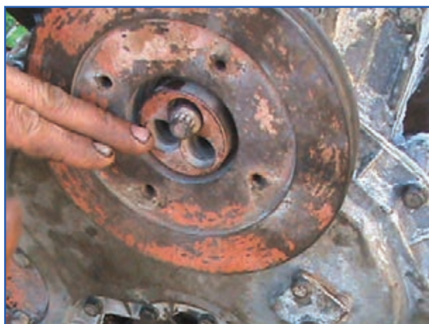
شکل ۴-۵۵- بستن پیچ سر میل لنگ تراکتور
