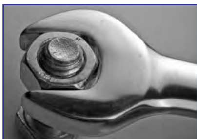
شکل ۲۸-۳ آچار تخت با سر زاویه دار (اینجی)
