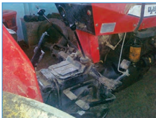
شکل ۲۱-۲- اهرم‌های تعویض دنده و دنده کمک
