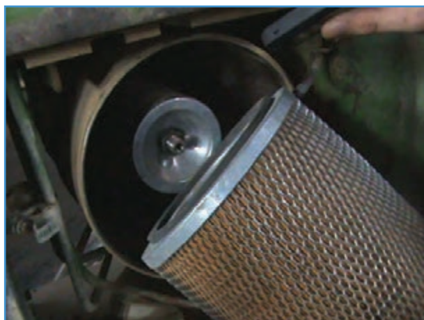
شکل ۵-۵ - صافی خشک و محل قرار گرفتن آن
