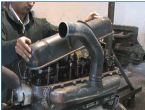
شکل ۴۰-۷ برداشتن قالباق سوپاپ
