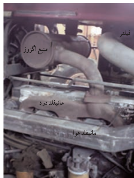
شکل ۲۲-۵- محل مانیفلد دود و هوا در تراکتور MF399
