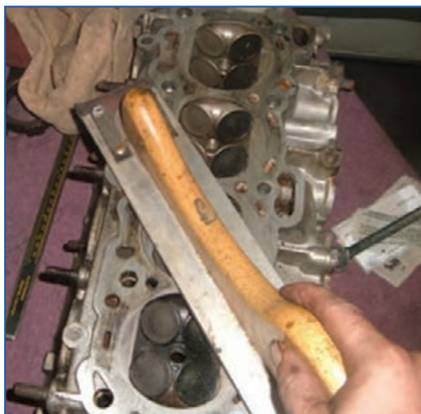
شکل ۴۴-۴- تمیز کردن سرسیلندر با سوهان نرم
