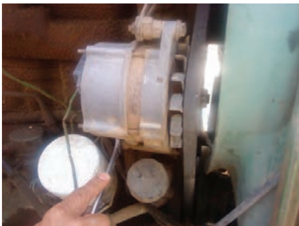
شکل ۳۹-۶ سفت کردن پیچ پایه
