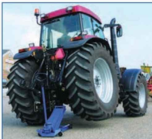
شکل ۱۳-۴ کاربرد جک سوسماری
