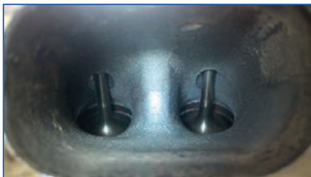
ب) محفظه تمیز پشت سوپاپ‌ها
