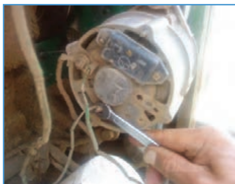
شکل ۳۵-۶ بستن سیم نازک
