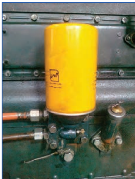
شکل ۱۸-۷ صافی روغن تراکتور U650M
