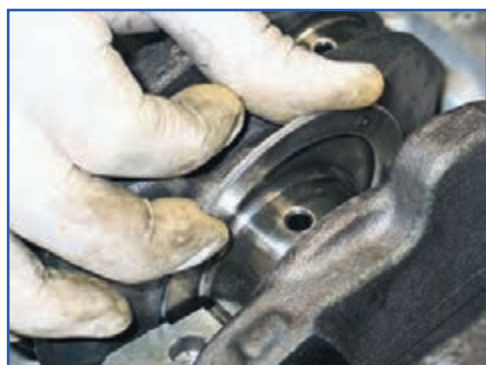
شکل ۱۸۴-۴ جازدن بغل یاتاقانی
