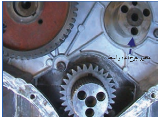
شکل ۶۷-۴ چرخ‌دنده واسط برداشته شده است.
