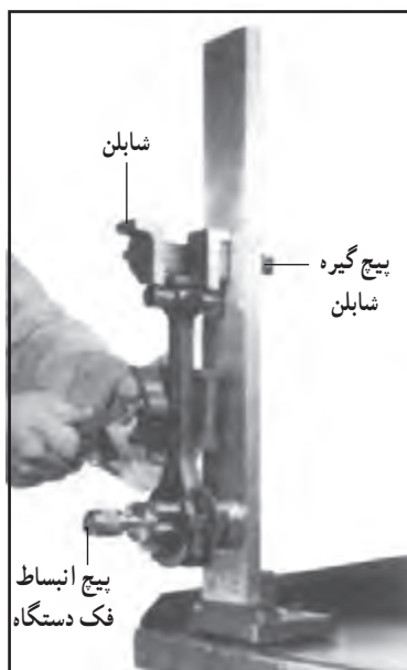
شکل ۴-۱۱۵- طرز صاف کردن شاتون خمیده
