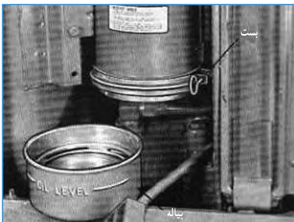
شکل ۱۷-۵ باز کردن پیاله زیر صافی
