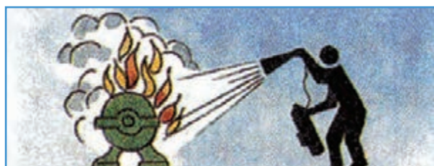
شکل ۱۴-۱- خاموش کردن آتش با دی اکسید کربن
