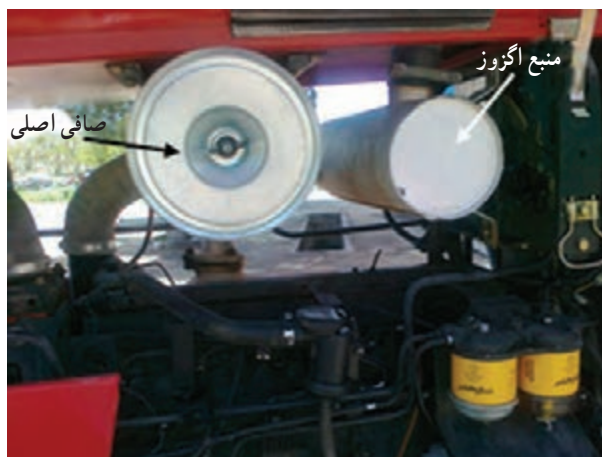
شکل ۲۶-۲ صافی اصلی تراکتور MF399
