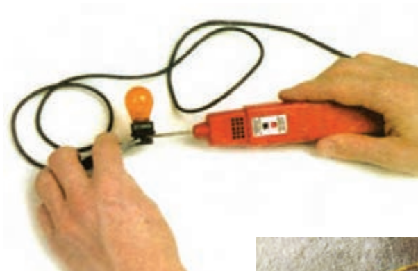
الف) لامپ آزمایش باتری دار
