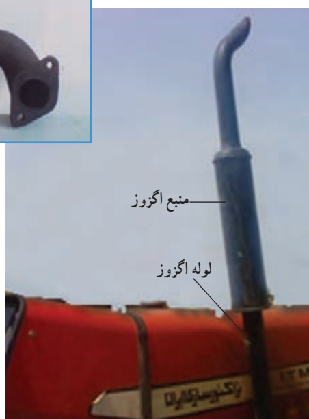
شکل ۲۳-۵- اگزوز تراکتور MF285
