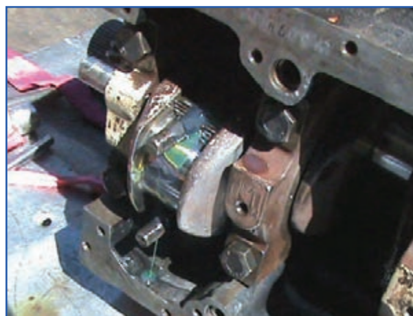
شکل ۲۰۳-۴ جا زدن شاتون روی میل لنگ
