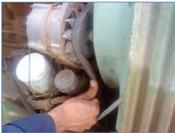
شکل ۲۸-۳ اندازه‌گیری کشش تسمه با فشار انگشت
