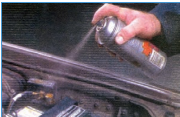
شکل ۱۱-۶ پاشیدن اسپری ضد خوردگی روی بست باتری
