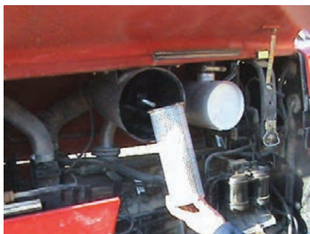
الف) خارج کردن صافی ثانویه
