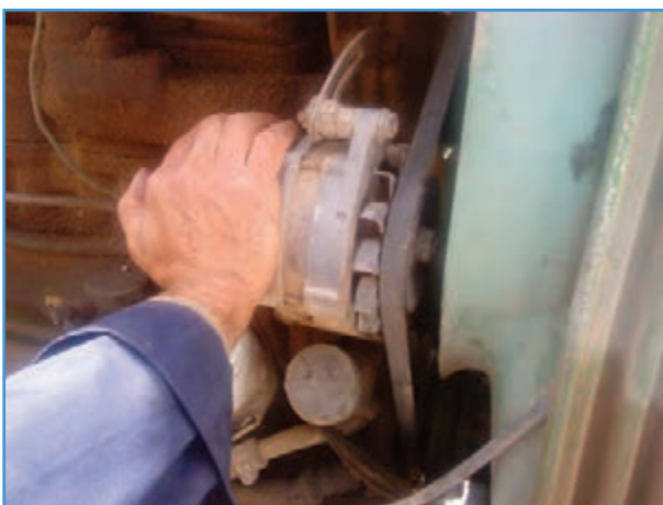
شکل ۳۰-۶ فشار دادن آلترناتور به عقب
