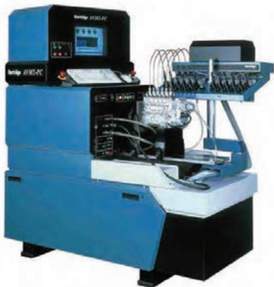
شکل ۲۴-۴ دستگاه آزمودن و تنظیم پمپ انژکتور
