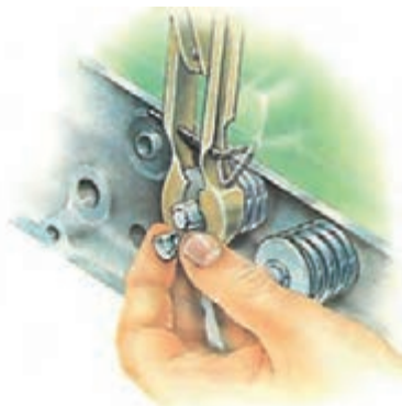
شکل ۱۸-۴- نحوه خارج کردن خار سوپاپ
