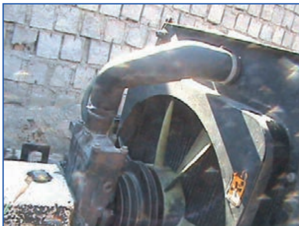
الف) باز کردن لوله لاستیکی رادیاتور
