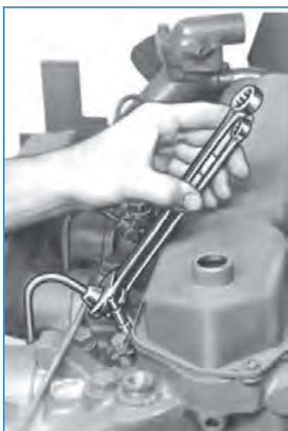
شکل ۲۲-۴ باز کردن لوله‌های فشارقوی انژکتورها
