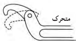
شکل ۵۹-۳ نحوه استفاده از آچار مهره‌ای گرد
