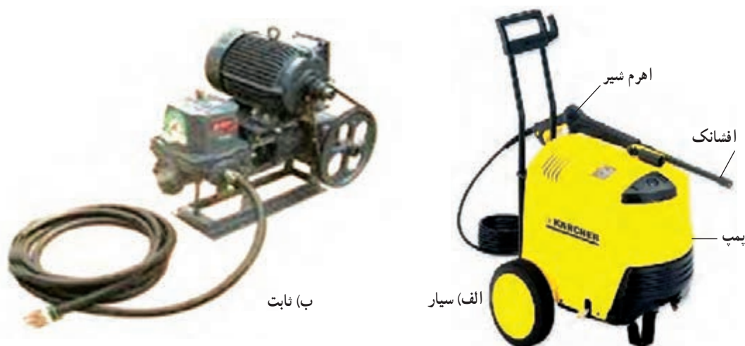
شکل ۱-۱- پمپ موتور شویی سیار و ثابت
