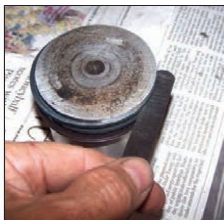
شکل ۹۳-۴ طرز اندازه‌گیری لقی رینگ در شیار رینگ‌ها با فیلر
