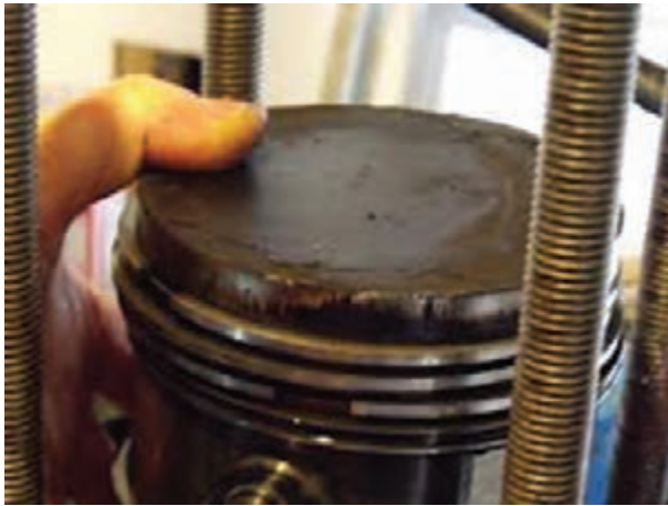
شکل ۴-۲۷- رسوبات کربن روی سطح پیستون
