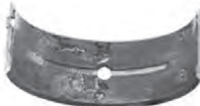
شکل ۱۶۷-۴ نقاط ذوب‌شده روی یاتاقان
