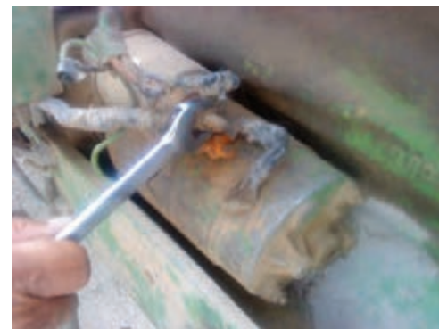
شکل ۵۰-۶ باز کردن کابل مثبت از استارت
