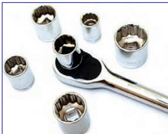
شکل ۴۸-۳ اتصال بکس به دسته بکس جفجغه ای
