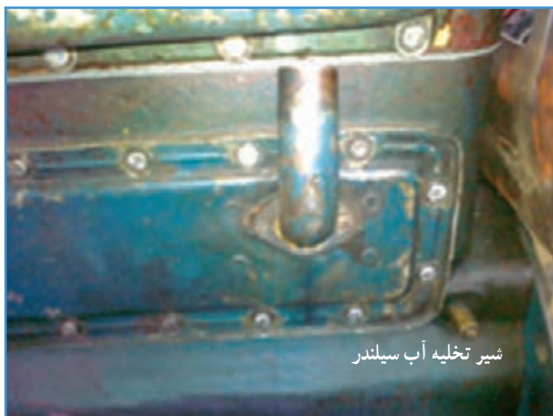
شکل ۸-۳- شیر تخلیه آب سیلندر تراکتور U650
