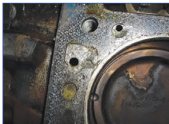
شکل ۴-۴۲- واشر سرسیلندر چسبیده به سیلندر
