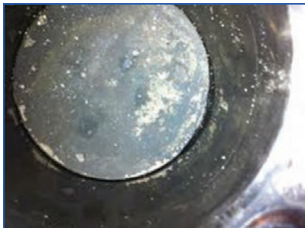
شکل ۲۰۶-۴ رسوبات کربن روی سطح پیستون
