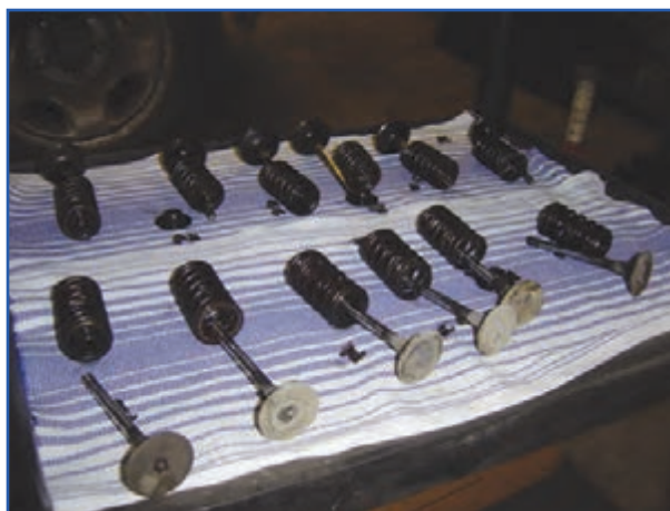
(الف) اجزای باز شده سوپاپ
