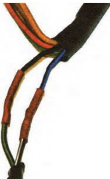
شکل ۶۷-۶- اتصال کامل سیم‌ها با روکش تیوپ عایق
