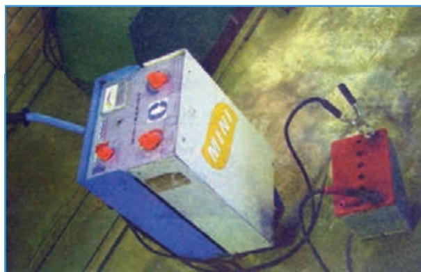
شکل ۱۸-۶ اتصال کابل‌های شارژر به باتری
