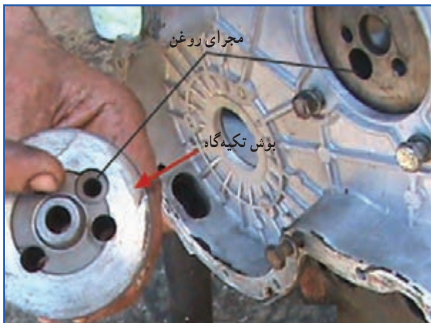
شکل ۶۸-۴ خارج کردن بوش تکیه‌گاه چرخ‌دنده واسط
