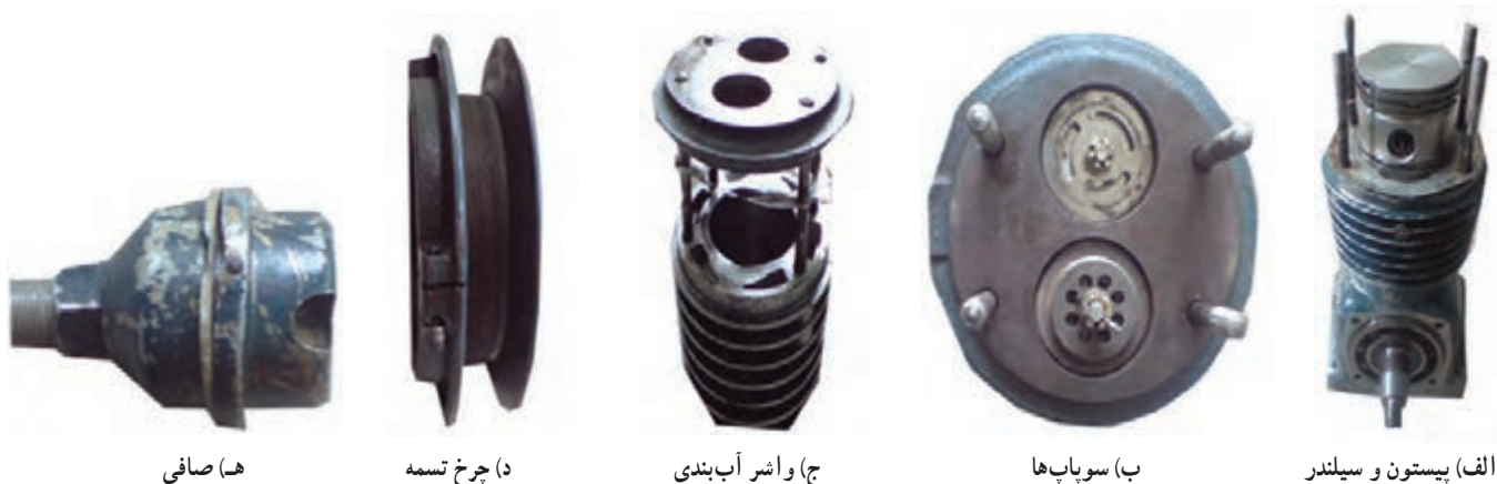
شکل ۳-۸- اجزای کمپرسور باد
