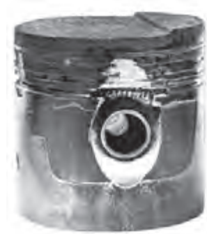
شکل ۴-۱۰۳- سایش غیریکنواخت پیستون
