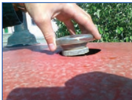
ب) باز کردن در رادیاتور
