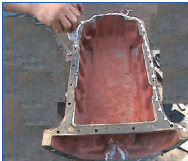
شکل ۳۲-۷ چسب زدن به محل قرارگیری واشر کارتر
