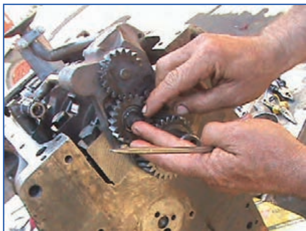
شکل ۷۹-۴- خارج کردن چرخ‌دنده پمپ روغن
