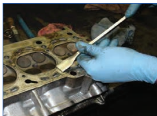
شکل ۴-۴۲- واشر سرسیلندر چسبیده به سیلندر
