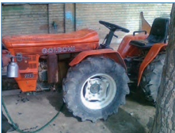
شکل ۱-۴- شستشوی موتور تراکتور با پیستوله شستشو
