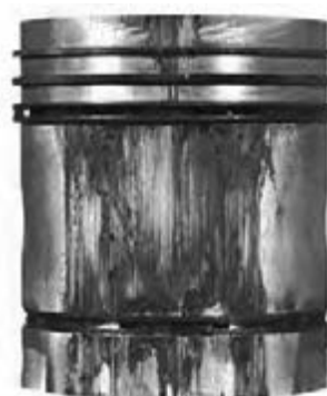
الف) خط و خش روی پیستون
