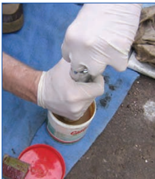
شکل ۴۸- ۷- مراحل پر کردن گریس پمپ دستی
