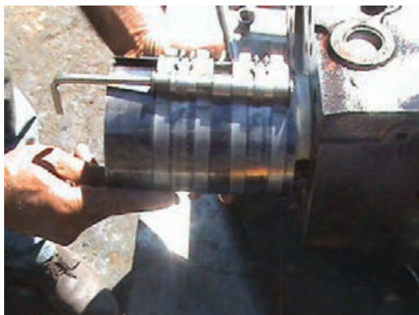
شکل ۱۹۸-۴- جمع کردن رینگ‌ها با رینگ جمع کن
