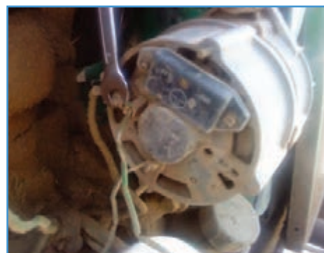
شکل ۳۳-۶ بستن سیم مثبت
