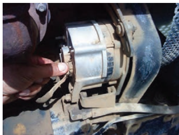
شکل ۲۸-۶- جدا کردن فیش از آلترناتور
