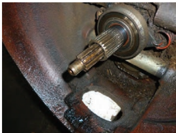
شکل ۱۳-۳- شافت ورودی جعبه‌دنده
