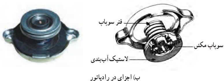
شکل ۳-۵- در رادیاتور و طرز کار سوپاپ‌های آن
