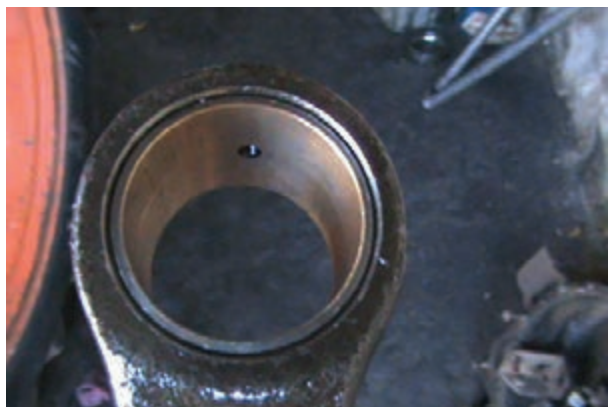
شکل ۱۲۰-۴ قرار گرفتن سوراخ بوش مقابل سوراخ شاتون
