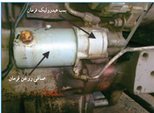
شکل ۲۳-۲. پمپ هیدرولیک فرمان و صافی تراکتور MF285
