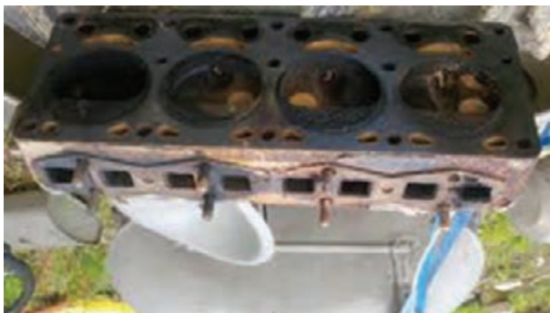
شکل ۴-۲۹- رسوبات کربن سطح سرسیلندر
