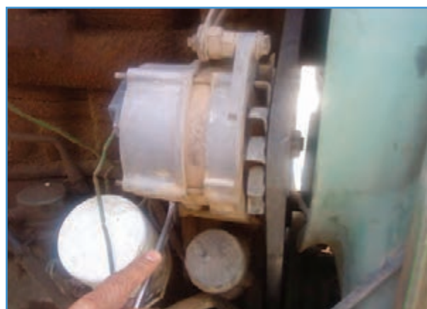
شکل ۳۱-۶ باز کردن پیچ پایه آلترناتور
