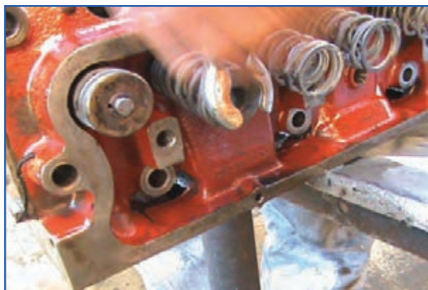
شکل ۱۹-۴- باز کردن اهرم فنر جمع کن
