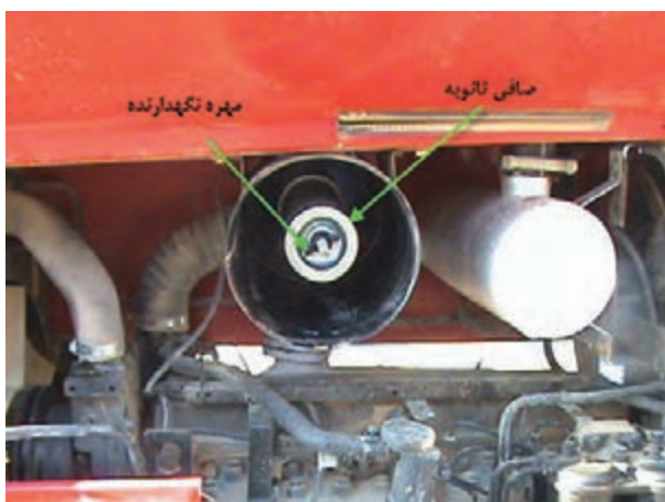
ب) محل قرار گرفتن صافی ثانویه
