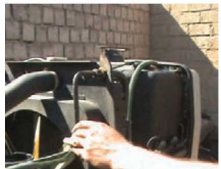
د) باز کردن لوله خنک کن روغن
