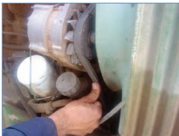
شکل ۳۶-۶ فشار دادن تسمه با شست
