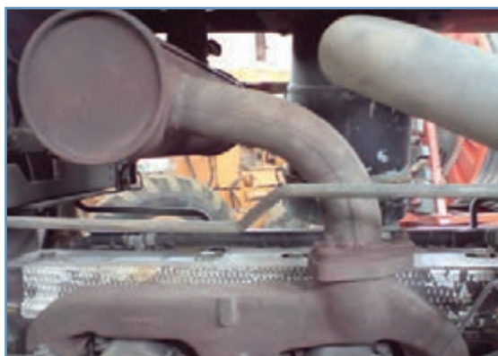
شکل ۳۰-۵- محل اتصال منبع اگزوز به مانیفولد
