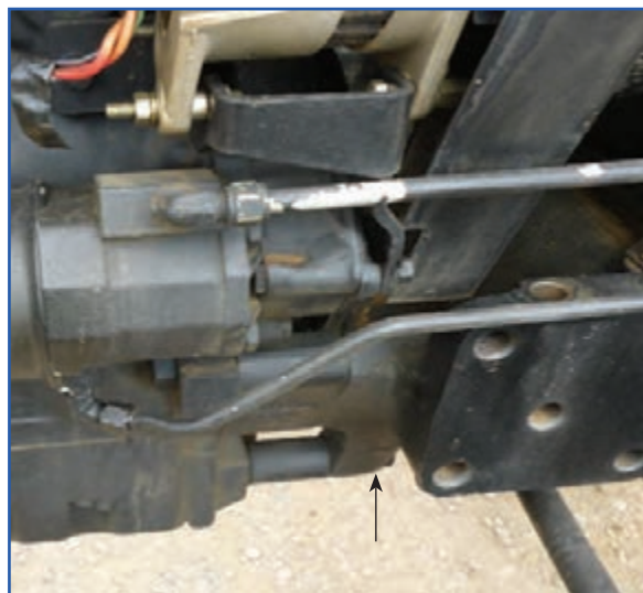
شکل ۱۷-۳- محل پیچ‌های اتصال موتور به جلوی تراکتور
