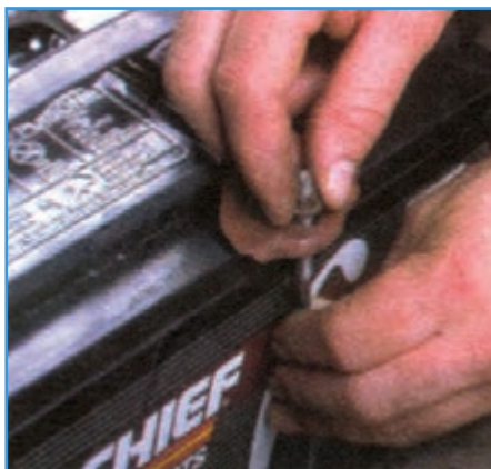
شکل ۹-۶ باز کردن بست نگهدارنده باتری
