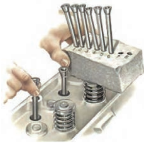
ب) به ترتیب قرار دادن میل تایپت
