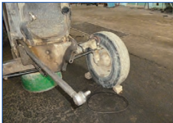
شکل ۱۹-۳ قسمت جلوی تراکتور جدا شده از موتور
