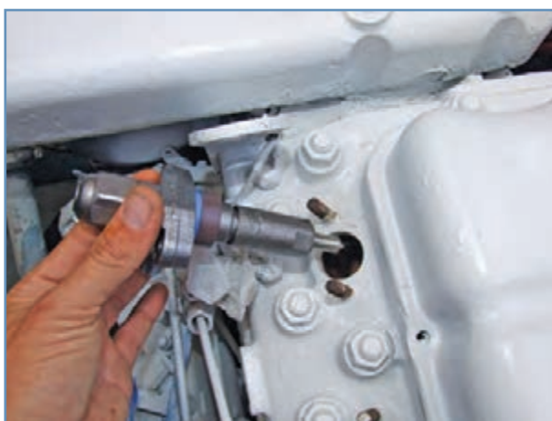
شکل ۲۳-۴ خارج کردن انژکتور
