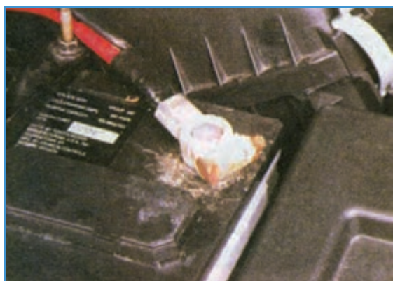
شکل ۲۱-۶- سولفاته کردن بست مثبت باتری
