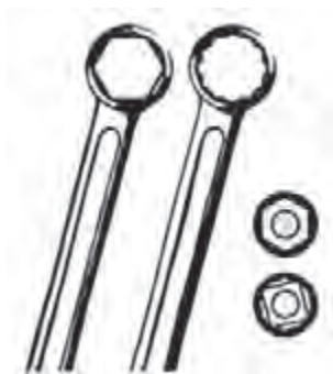
شکل ۳۰-۳- آچار رینگ با سر شش و دوازده گوش
