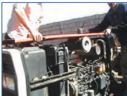
ج) برداشتن پوشش بالای موتور
