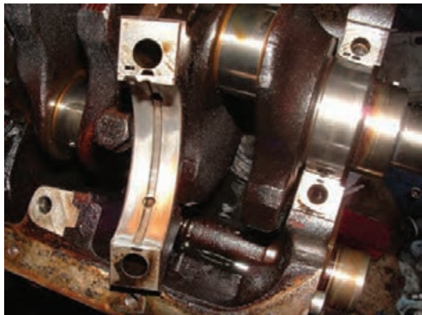
شکل ۱۸۲-۴ باز کردن کپه یاتاقان ثابت
