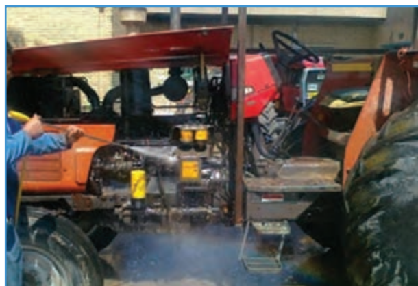
شکل ۵-۱- شستشوی موتور تراکتور
