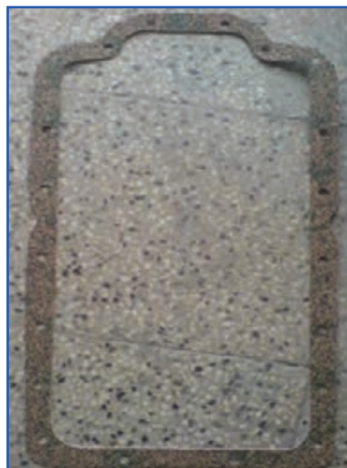
الف) واشر کارتر ویکتوری MF285
