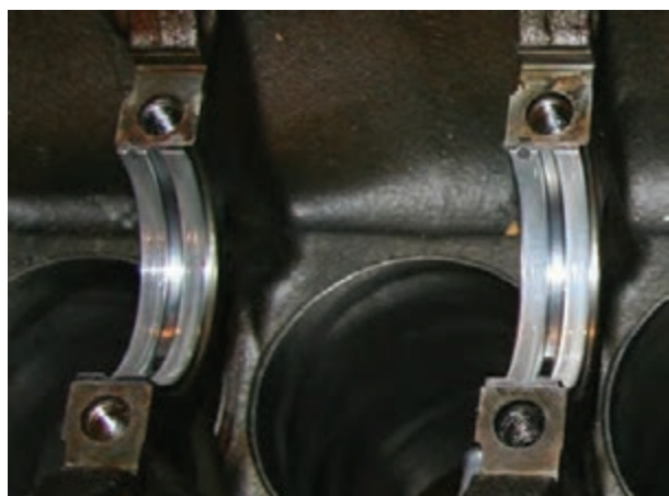
شکل ۱۸۵-۴ جازدن یاتاقان‌های ثابت
