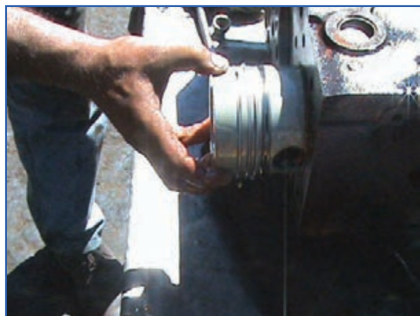
شکل ۱۹۷-۴- قرار دادن پیستون در سیلندر
