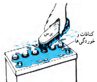
الف) تمیز کردن با برس و آب
