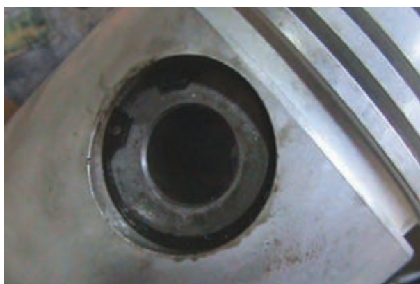
شکل ۱۲۵-۴ جا افتادن خار انگشتی در شیار پیستون
