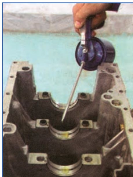
شکل ۱۸۷-۴ روغن کاری یاتاقان‌های ثابت
