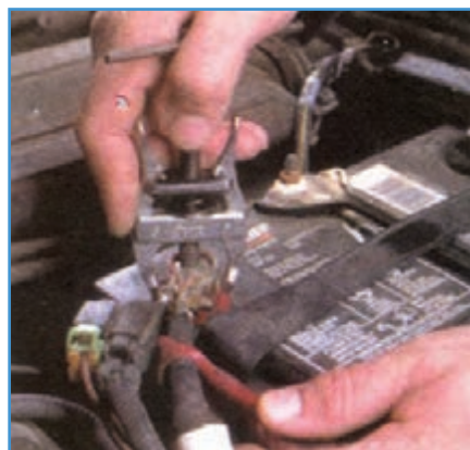
شکل ۸-۶ باز کردن بست مثبت باتری
