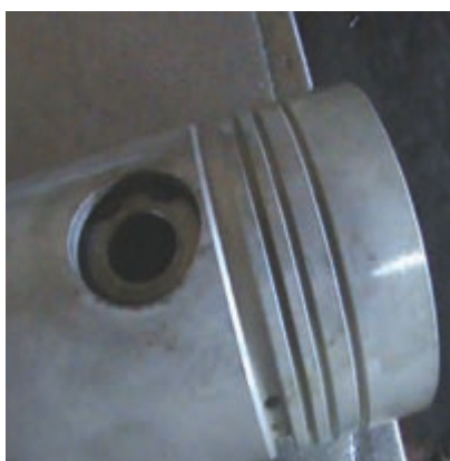
شکل ۱۲۳-۴ میزان داخل شدن انگشتی در پیستون
