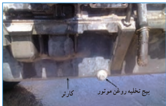
شکل ۳۹-۲ بیج تخلیه روغن موتور
