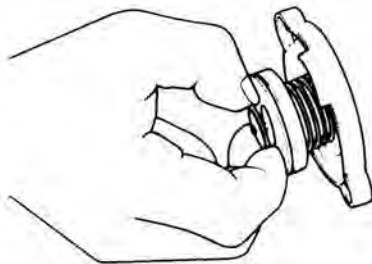
شکل ۱۷-۳ - آزمون سوپاپ مکش در رادیاتور
