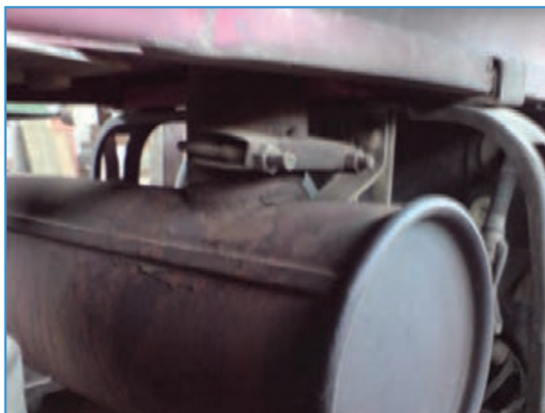
الف) بست اگزوز در تراکتور MF399
