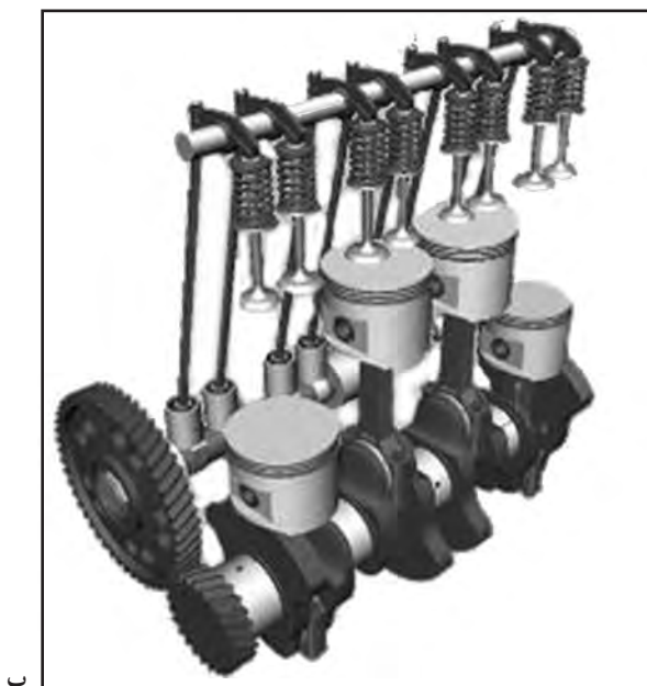
شکل ۸-۲ — قطعات مکانیزم باز و بسته شدن سوپاپ‌ها
