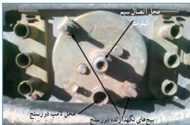
شکل ۸۲-۶ دورسنگ از قسمت پشت داشبورد تراکتور U650M
