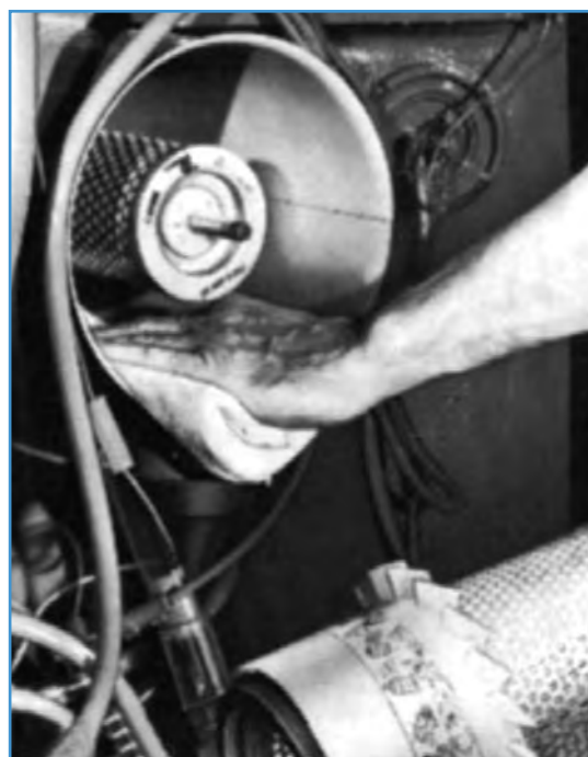
شکل ۱۳-۵ تمیز کردن بدنه صافی با پارچه
