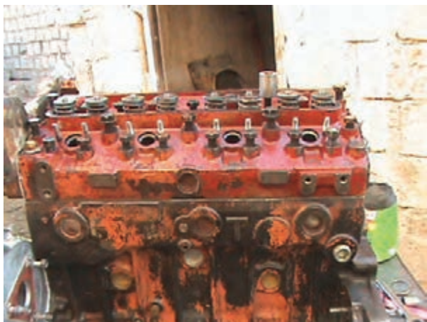
ب) پیچ‌های سرسیلندر باز شده تراکتور MF285
