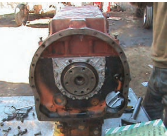
شکل ۱۵۰-۴ انتهای میل لنگ بدون چرخ لنگر
