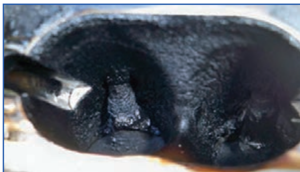
الف) کربن محفظه پشت سوپاپ‌ها
