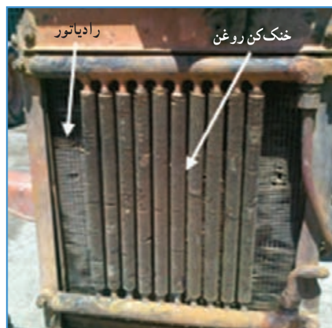
الف) خنک کن روغن تراکتور U650
