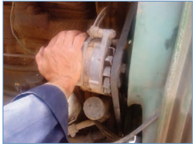
شکل ۳۰-۳ فشار دادن مولد به سمت موتور
