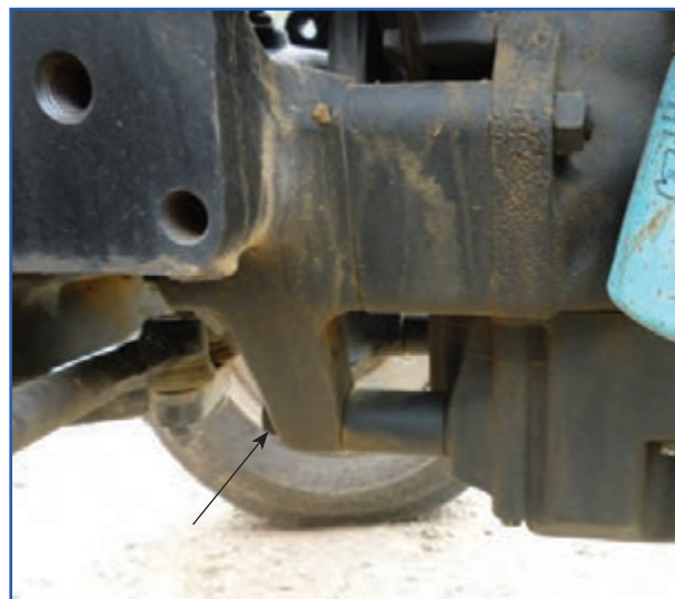
شکل ۱۷-۳- محل پیچ‌های اتصال موتور به جلوی تراکتور
