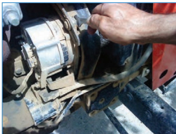
شکل ۲۹-۶ شل کردن پیچ و مهره تنظیم
