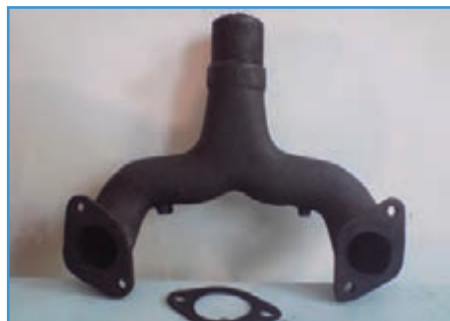
شکل ۲۱-۵- مانیفلد دود تراکتور U650
