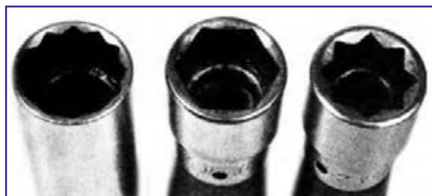
شکل ۳۵-۳- آچار بکس شش، هشت و دوازده گوش
