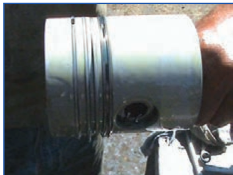
شکل ۱۹۲-۴ روغن‌کاری رینگ‌ها، پیستون و یاتاقان
