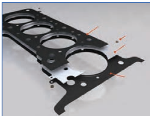
شکل ۴۹-۴- ساختمان واشر سرسیلندر
