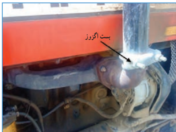
ب) بست اگزوز در تراکتور MF285
