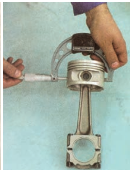
(الف) اندازه گیری قطر دامن پیستون
