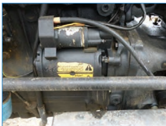
شکل ۴۵-۲- استارتر تراکتور MF285
