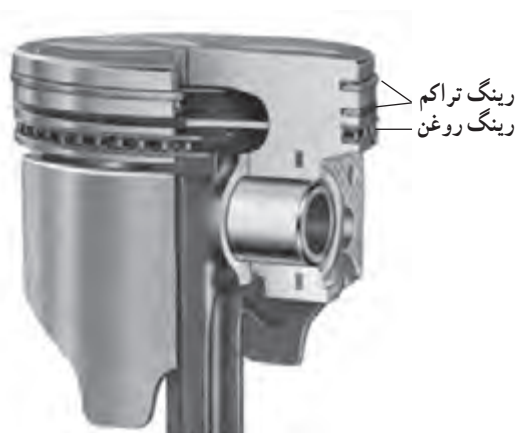
شکل ۲۲-۲- انواع رینگ روی پیستون
