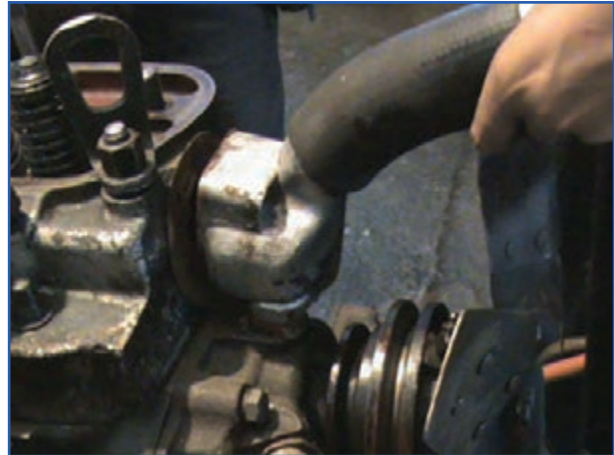
ب) باز کردن محفظه ترموستات تراکتور U650
