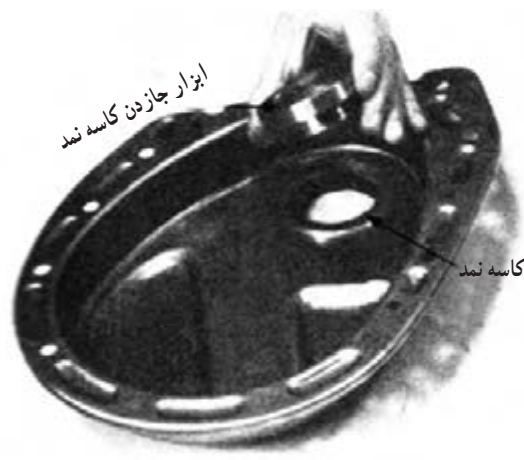
شکل ۴۳- ۷- نحوه جازدن کاسه نمد روی سینی جلو
