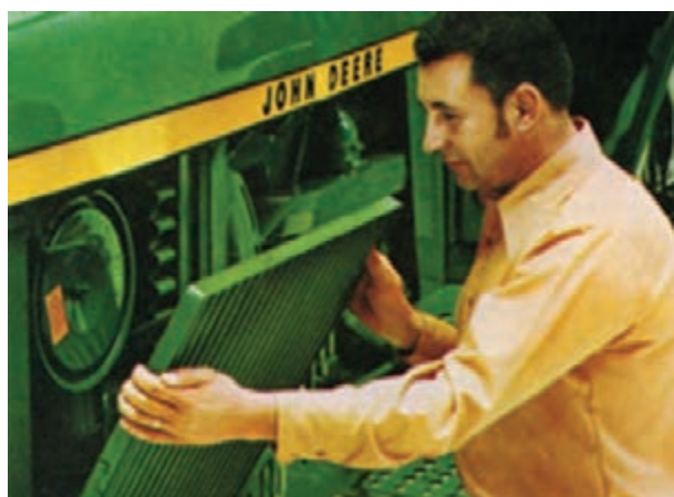
شکل ۱۰-۵ باز کردن شبکه بغل
