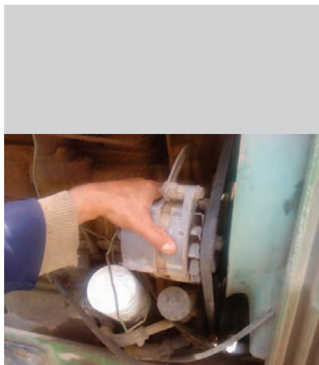
شکل ۳۷-۶ عقب کشیدن آلترناتور
