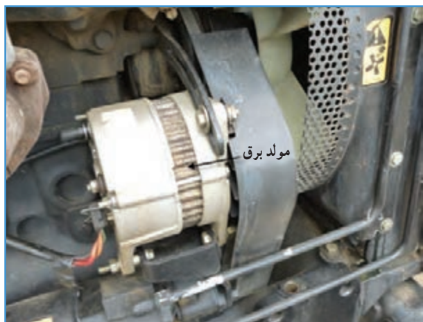
شکل ۴۷-۲ — مولد برق تراکتور MF285
