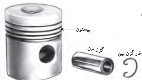
شکل ۳۰-۲- انگشتی و محل نصب آن روی پیستون
