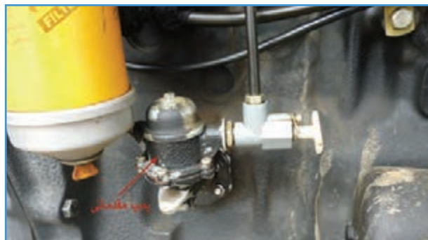
شکل ۲۹-۲- پمپ مقدماتی تراکتور MF285
