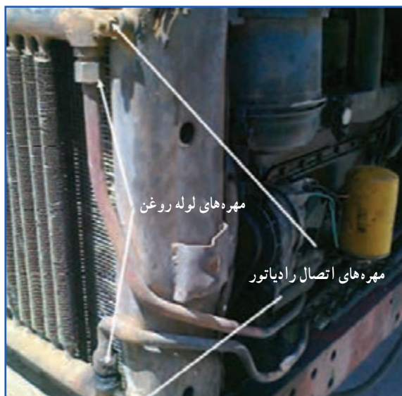
شکل ۳۸- ۷- مهره های لوله روغن سمت رادیاتور روغن
