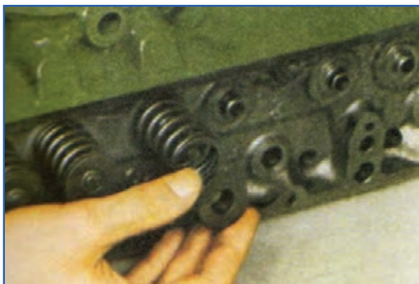
شکل ۲۰-۴- نحوه برداشتن بشقابک فنر سوپاپ
