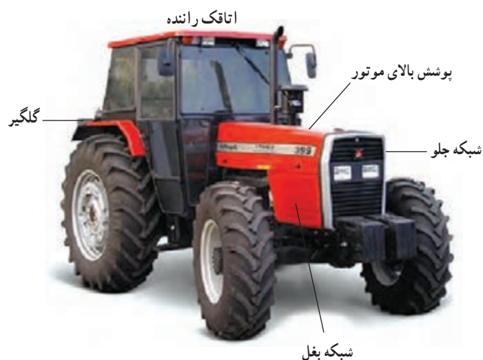
شکل ۲-۲ بدنه و پوشش‌های تراکتور مسی فرگوسن (MF399)
