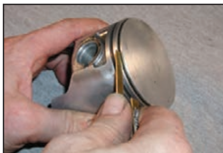
(د) تمیز کردن شیار با ابزار برنجی
