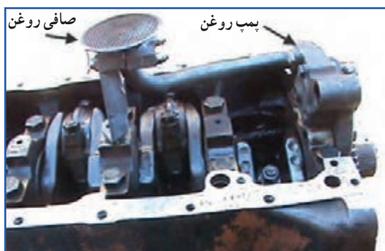
الف) محفظه میل‌لنگ بدون کارتر
