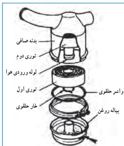
شکل ۸-۵ قطعات صافی روغنی
