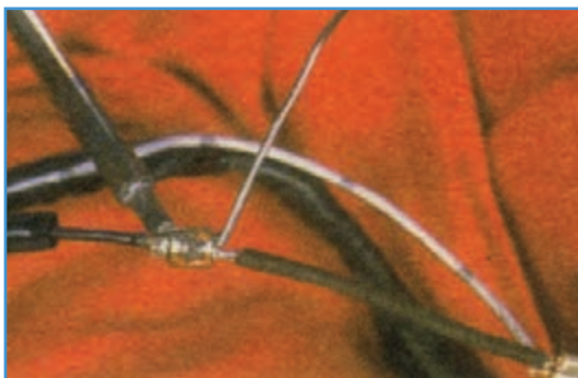
شکل ۶۴-۶- نحوه لحیم کاری سیم‌ها
