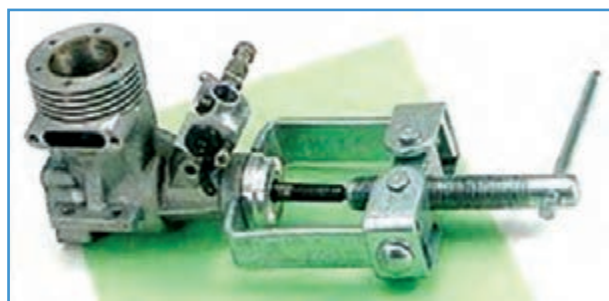
شکل ۷۷-۳- خارج کردن بلبرینگ با بلبرینگ کش
