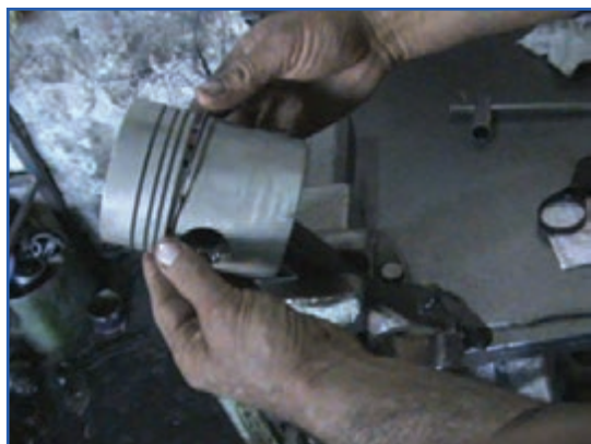
شکل ۱۳۸-۴ جازدن رینگ با دست
